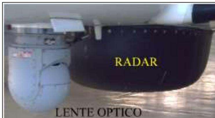
**Fig. 1.9 Equipos Instalados en el Avión Super King Air 200**
