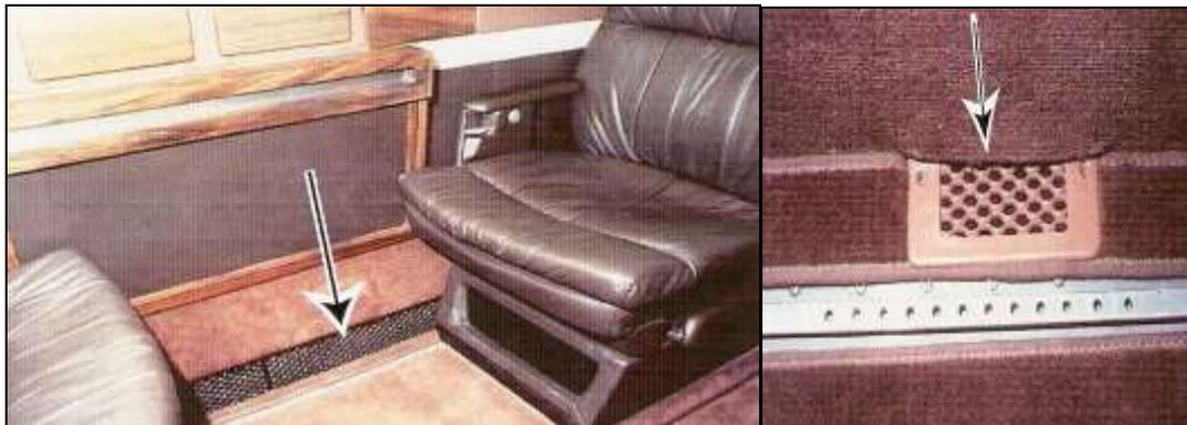
**Fig.14 Salida Inferior de Aire P3 en la Cabina**
