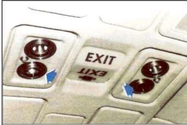
**Fig. 1.13 Salida Superior de Aire Acondicionado en la Cabina**
