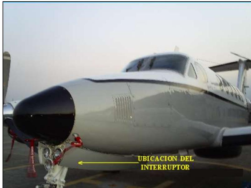
**Fig. 1.28 Ubicación de la Luz de Reajuste e Interruptor**
