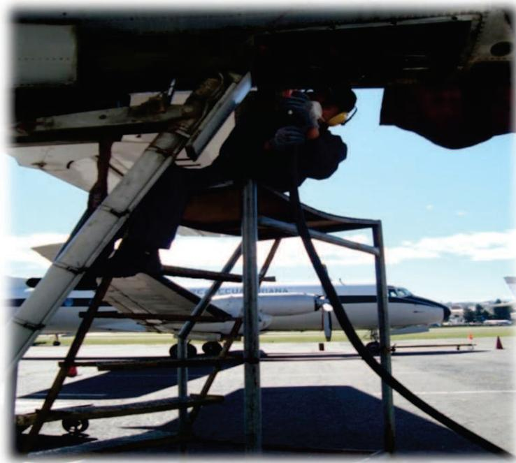
**Figura:** 4.4 Acople y conducto de vaciado por gravedad
