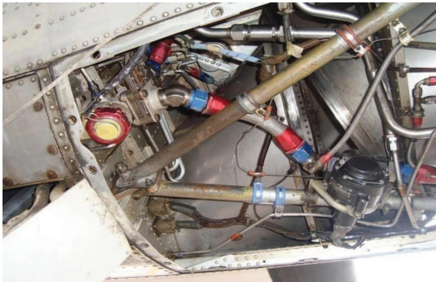
**Figura:** 3.6. Conexión entre el tanque colector y motor
