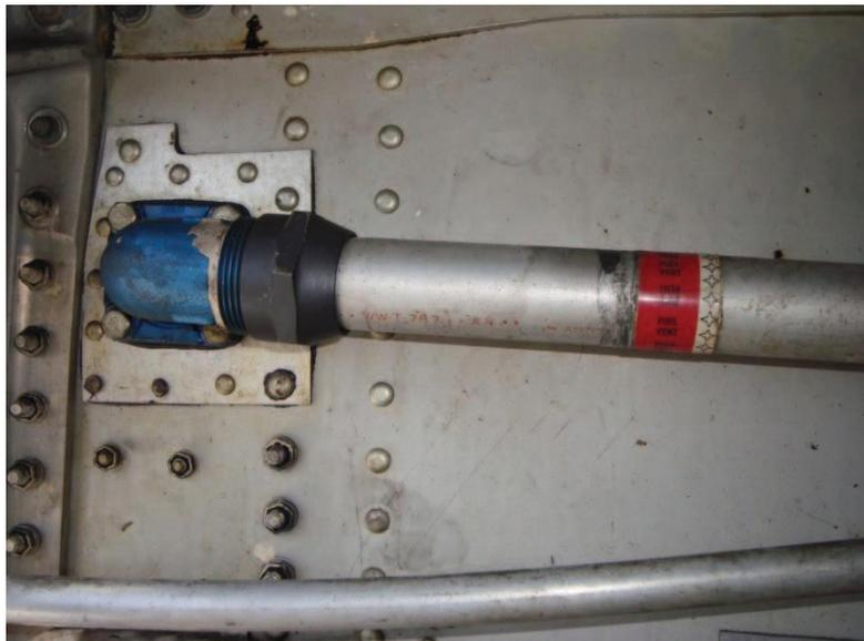
**Figura: 3.4.**cañerías de combustible rígidas
