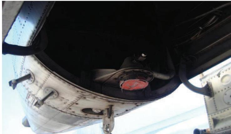
**Figura:** 3.9. Adaptador de presión de llenado
