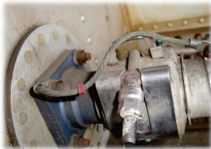
**Figura:** 4.3. Cables de tierra de la Aeronave
