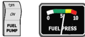
Fig.3.6.4 - Interruptor de la bomba auxiliar de combustible e indicador de presión.
