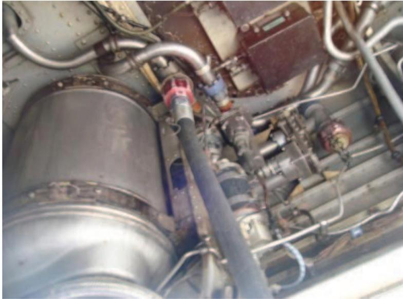
**Figura: 3.24** Bombas reforzadoras internas
