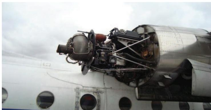
**Figura: 3.8.** Unidad de Potencia Auxiliar
