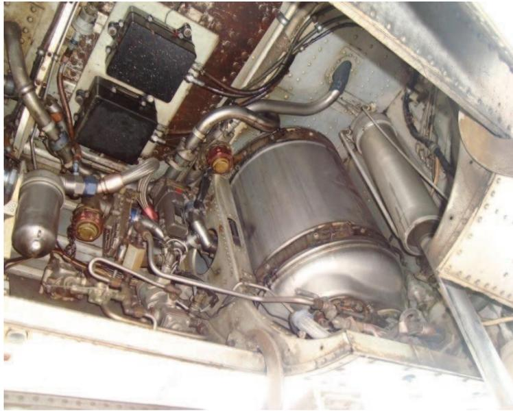
**Figura:** 3.26 Tanque colector de combustible
