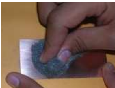
Fig. 3-5 Limpieza de película protectora
