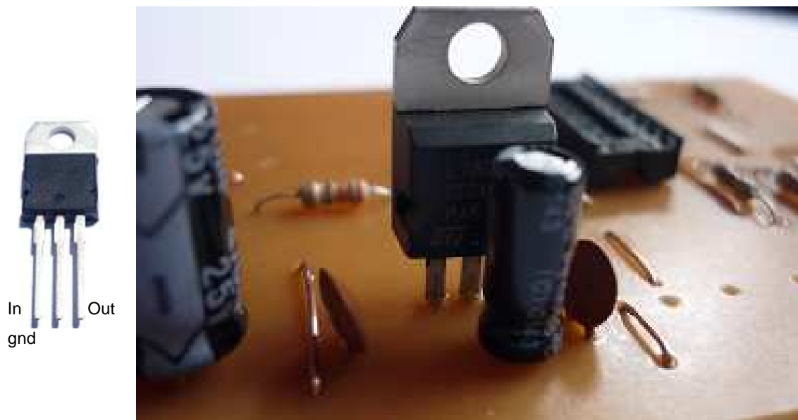
Fig. 3-17 Instalación del regulador de voltaje L7805CV
