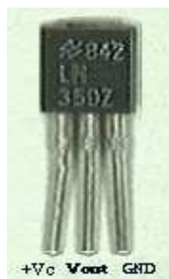
Fig. 3-25 Nombre de los pines del sensor LM35DZ
