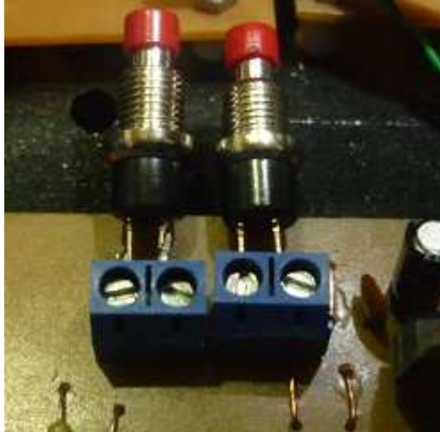
Fig. 3-22 Pulsadores normalmente abiertos
