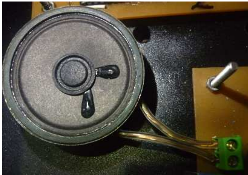
Fig. 3-23 Instalación del parlante
