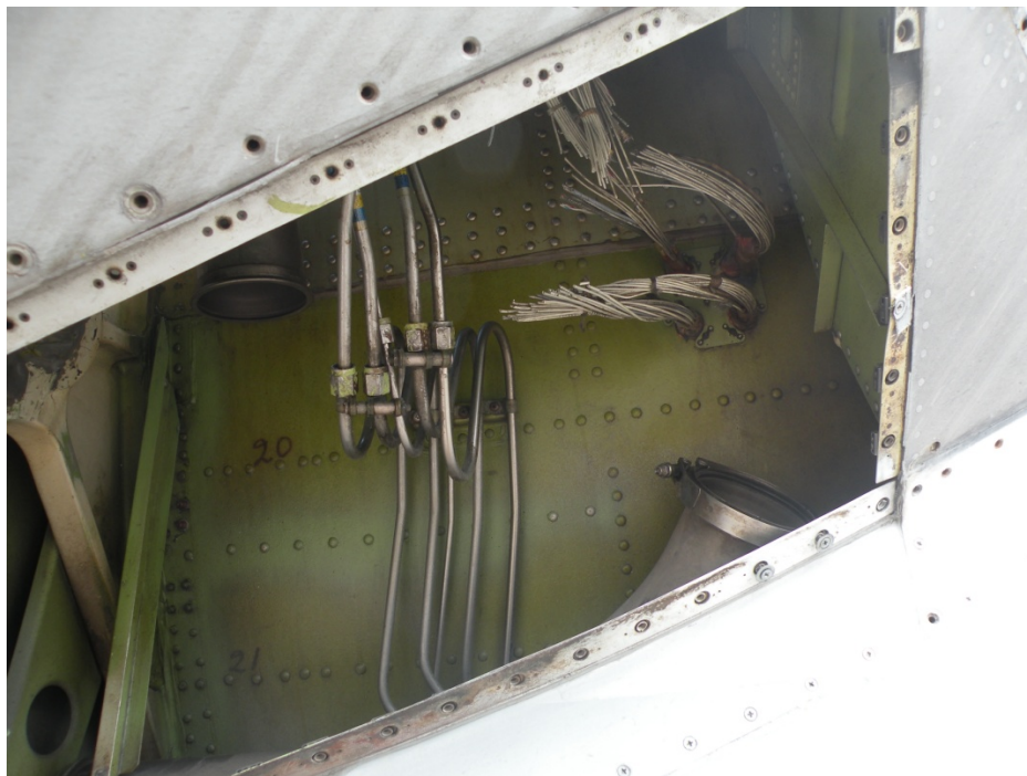
Desconexión de cables, cañerías y tuberías
