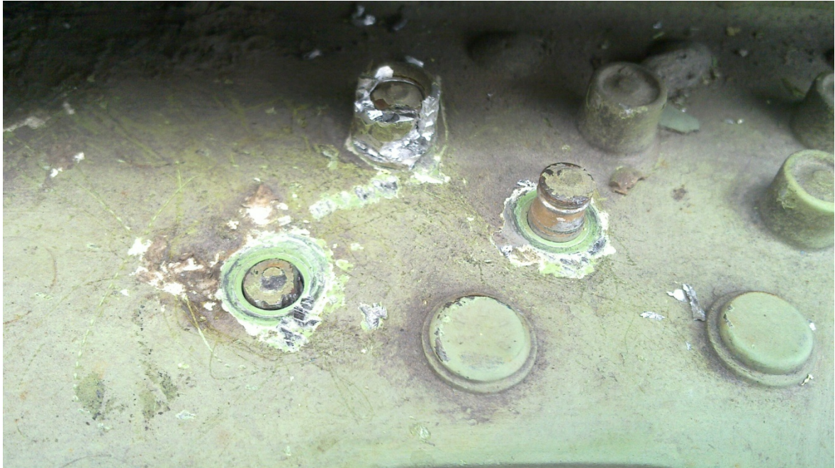
Fig. 3.14 Remoción del vástago de los remaches
