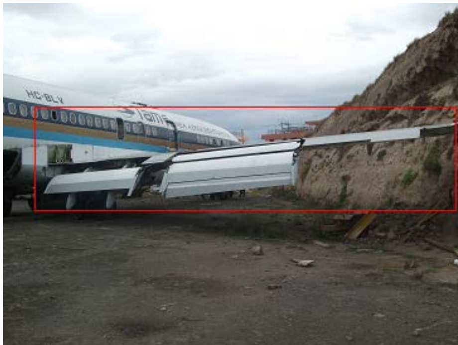
Señalización del ala derecha que será desmontada.
