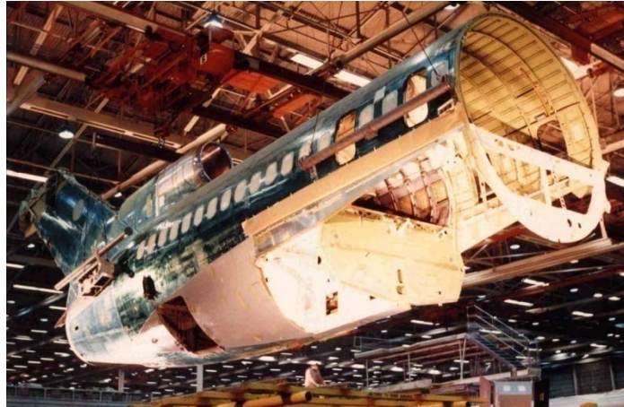
Fig. 3.27 Construcción del primer Boeing 727
