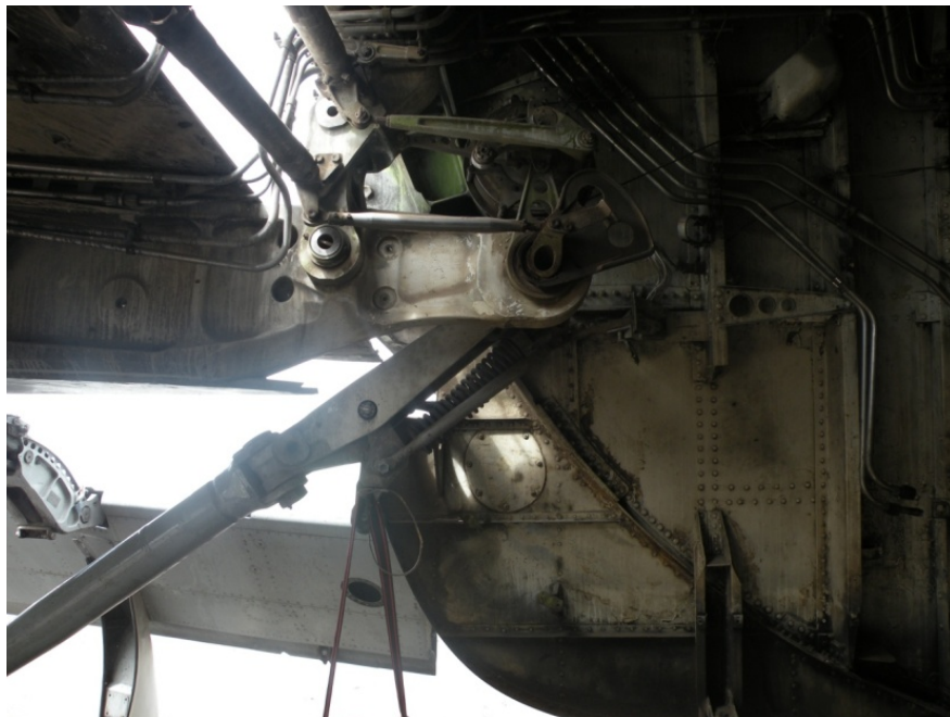
Fig. 3.9 Tuberías desconectadas del Boeing 727 Fuente: Jimmy Salvador
