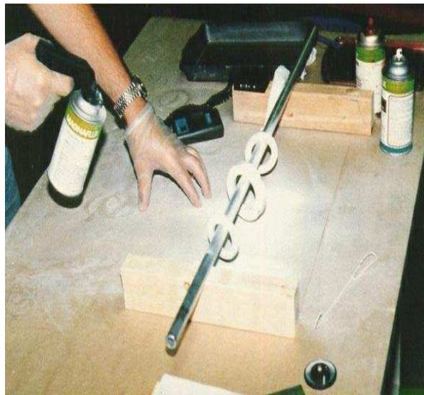
Figura 2.11 Aplicación del Revelador (Askeland R. Donald "La ciencia e ingeniería de los materiales", 2da Edición).
