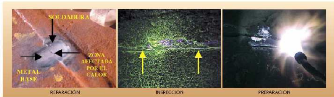
Figura 2.7 Procedimiento de inspección por partículas magnéticas.
