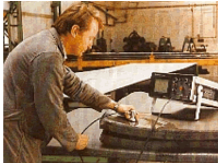
Figura 2.4 Inspección por ultrasonido .(www.ndt.mx.com,Ultrasonido Industrial)
