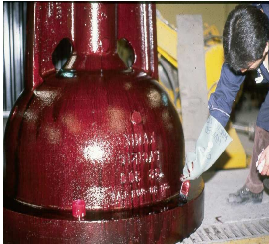
Figura 2.8 Examen con penetrante visible. ( Ensayos No Destructivos, Ing. Miguel Villacrés )
