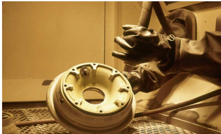
Figura 2.10 Limpieza de la pieza (Askeland R. Donald "La ciencia e ingeniería de los materiales.2da Edición).
