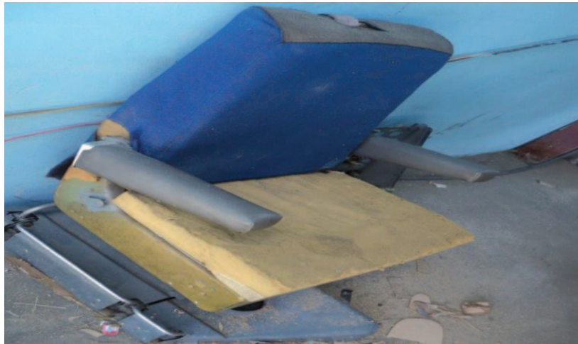
Figura 3.26. Estado inicial de asiento del piloto
