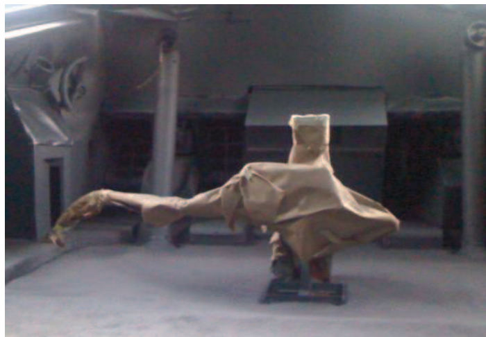
Figura 3.15. Partes que no van pintadas
