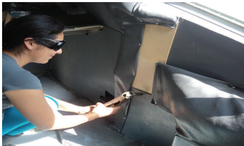
Figura 2.23. Remache y fijación de paneles pequeños
