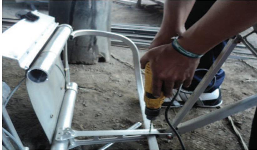
Figura 3.29. Aseguramiento de los soportes de los asientos
