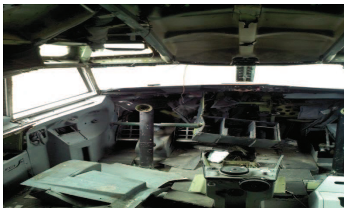
Figura 3.2. Retiro de áreas dañadas de la cabina.
