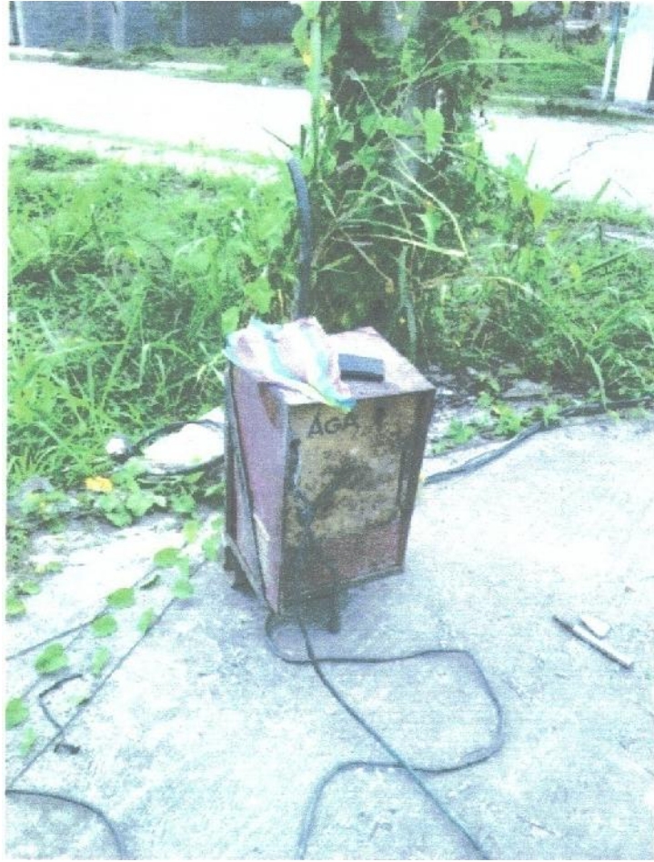
SOLDADORA DE ARCO UTILIZADA
