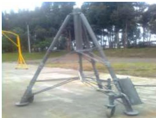
**Fig.3.21 Gata hidráulica con pintura base**
