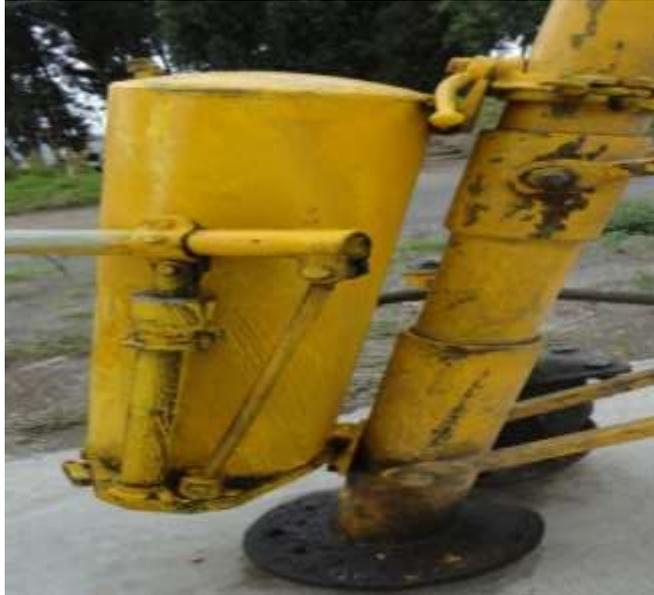
**Fig.3.3 Bomba de la Gata hidráulica**
