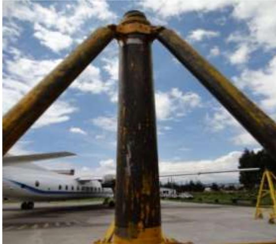
**Fig.3.20 Gata hidráulica con la pintura desprendida**
