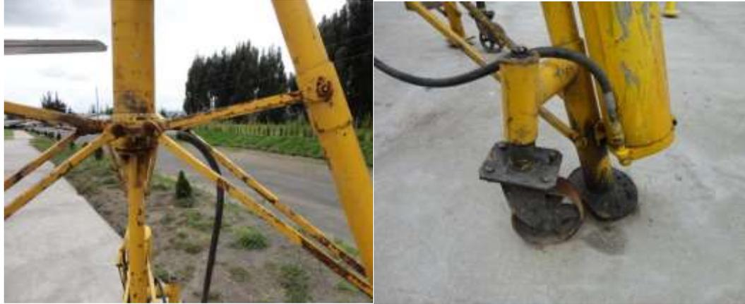
**Fig.3.9 Manguera de la Gata hidráulica**
