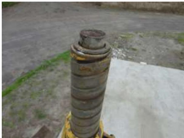
**Fig.3.6 Actuador de la Gata hidráulica**
