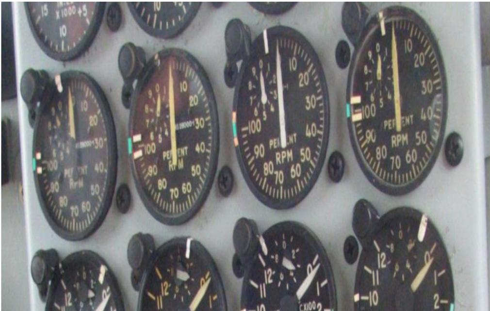
**Figura 2. 16** Indicador del tacómetro Avión C-130H
