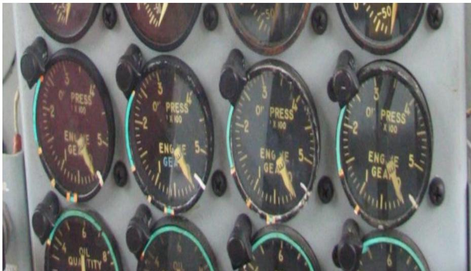
**Figura2. 20** Indicador de presión de aceite Avión C-130H
