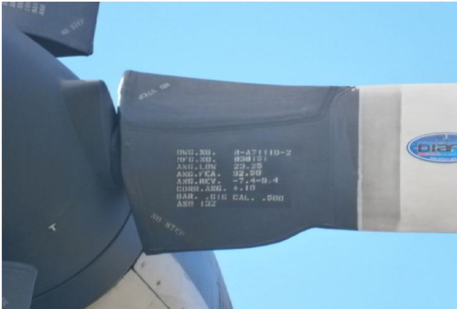
**Figura 2. 24 Número de dibujo de la hélice avión C-130H Hércules**
