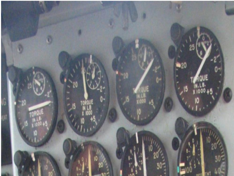
**Figura 2. 15 Indicador del torsiómetro Avión C-130H**
