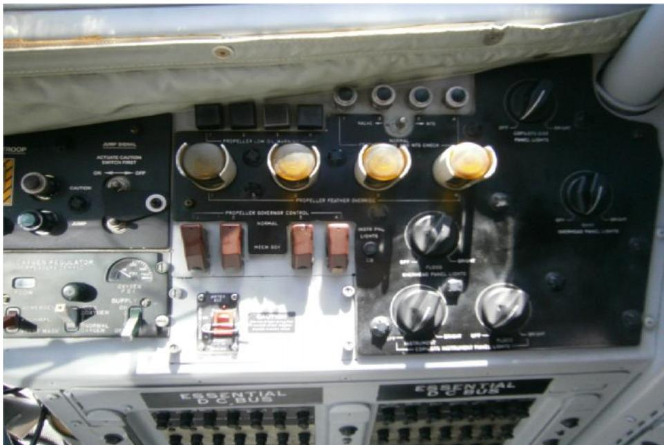
**Figura 2. 45 Panel de control de hélices avión C-130H**
