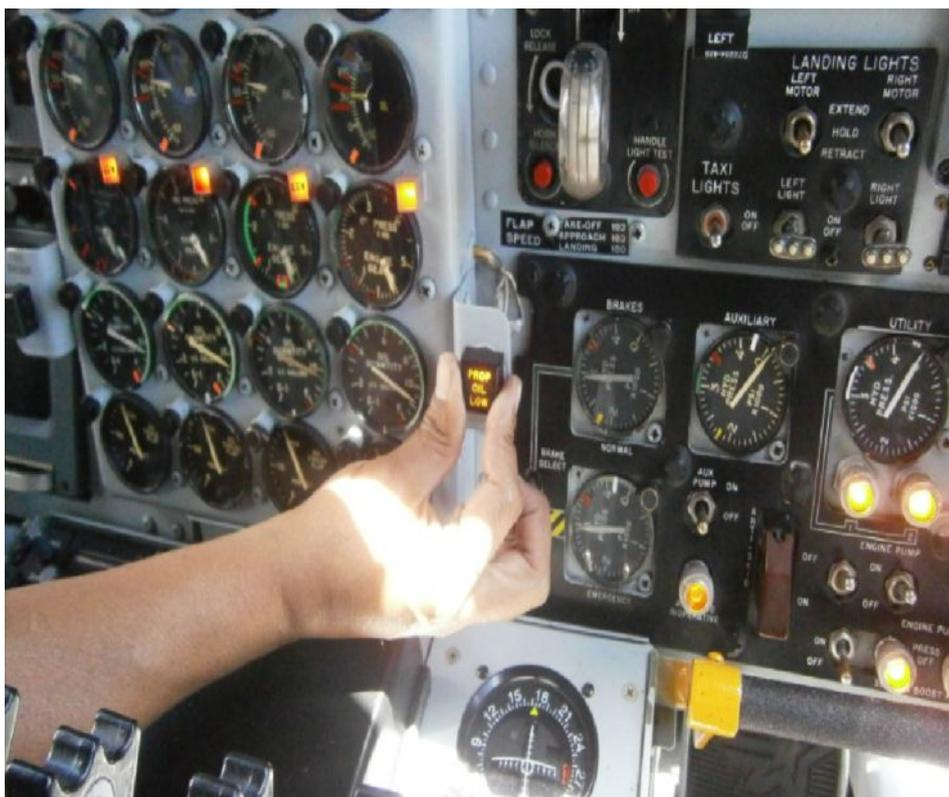
**Figura 2. 47 Luz maestra de bajo nivel de líquido hidráulico avión C-130H**
