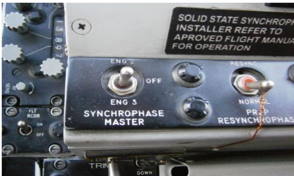
**Figura 2. 48 Interruptor de sincrofase y resincrofase del avión C-130H**
