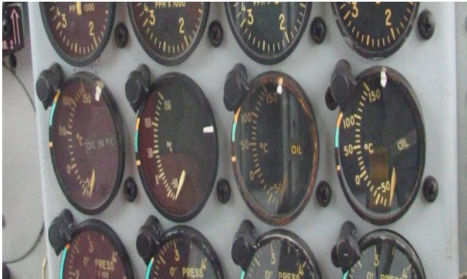
**Figura 2. 19** Indicador de temperatura de aceite Avión C-130H
