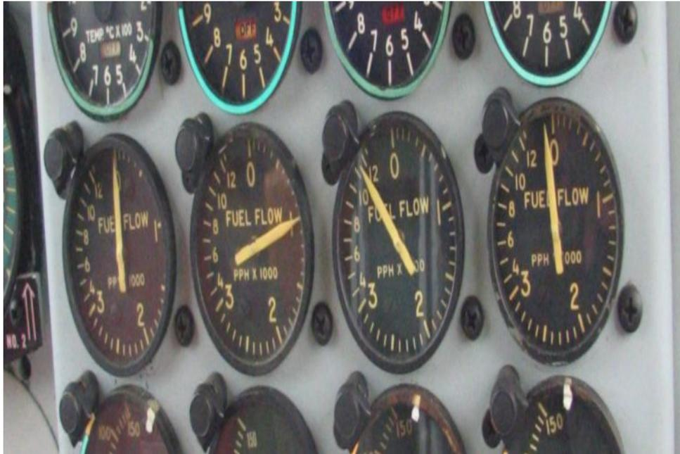
**Figura 2. 18 Medidor de flujo de combustible Avión C-130H**
