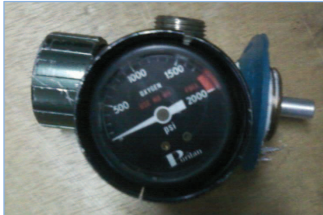
Fig. 2.7: Manómetro de la válvula ON-OFF
