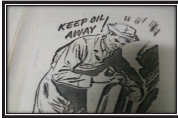
Fig. 2.27: Manipulación de cilindros de oxígeno Fuente: Manual de Mantenimiento del C-130
