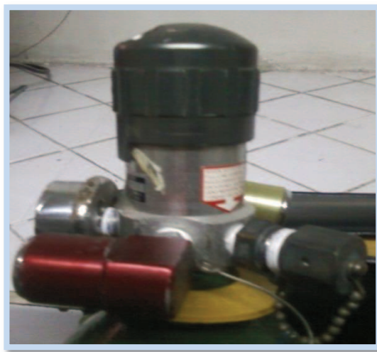
Fig. 2.6: Válvula ON-OFF del cilindro piloto y co-piloto Fuente: Manual de Mantenimiento del helicóptero Dhruv
