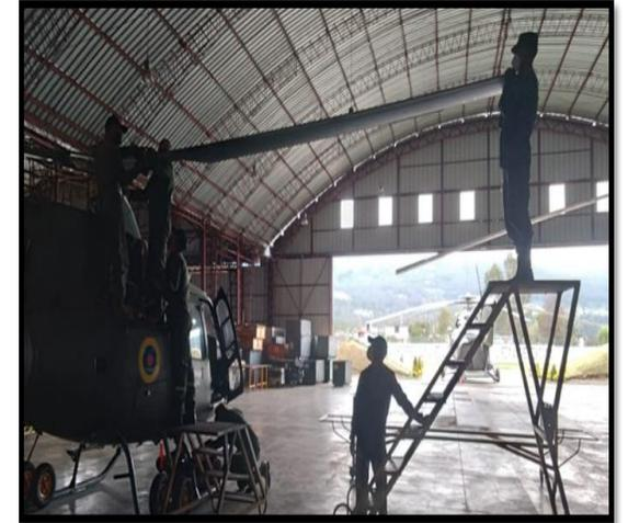
***El centro de mantenimiento no consta con un soporte para las palas se procede a fabricarlo ya que en el manual nos detalla que puede ser de fabricación local.***
