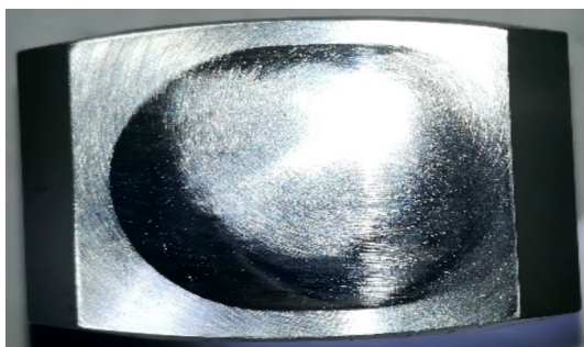
Figura 9. Inspección de huella de contacto de la leva anular.
