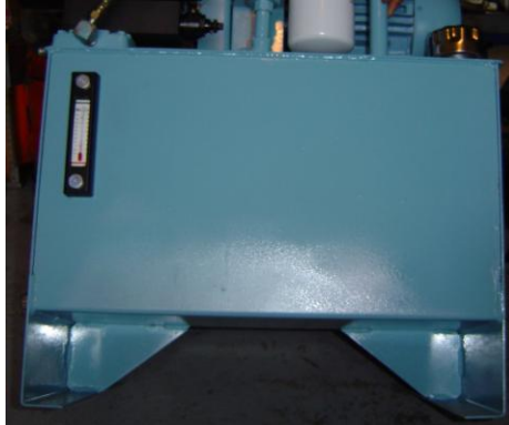
Fig. 5.2.3 Tanque de reserva
