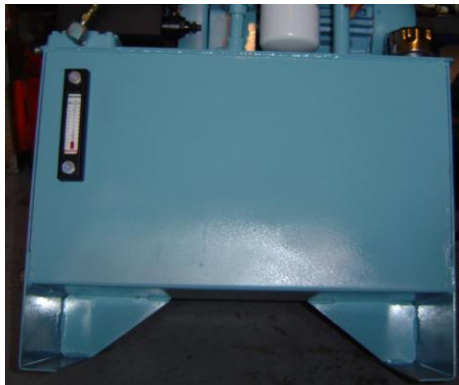
Fig. 5.2.3 Tanque de reserva
