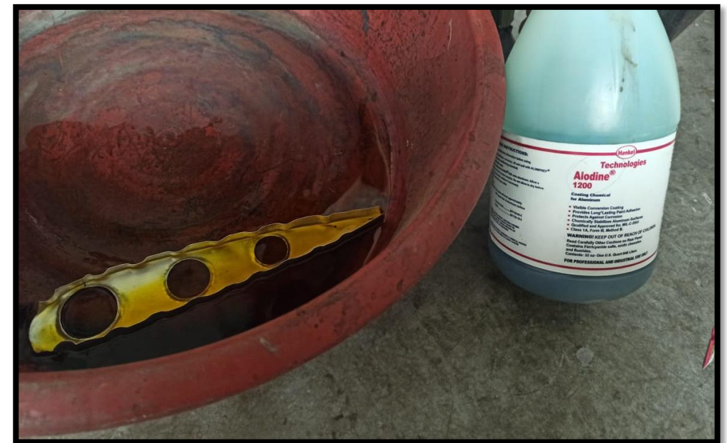
Tratamiento anticorrosivo con Alodine
