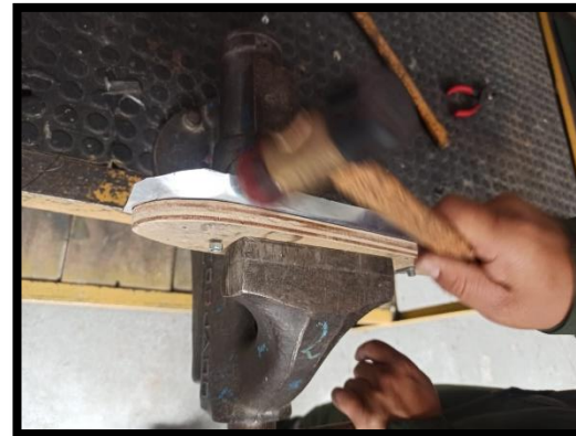
Moldes de madera y la lámina de aluminio
