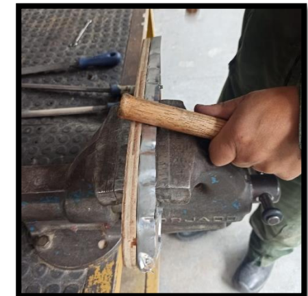
Pliegues a los costados de la lámina
