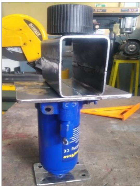
Colocación del actuador hidráulico
