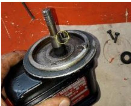
*Nota.* En la figura se detalla la verificación que corresponde al seguro de cuña, mismo que debe permanecer intacto para instalar las demás pares internas.
