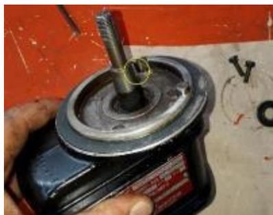
*Nota.* En la imagen se aprecia que el seguro de cuña presenta una decoloración superficial, por lo que necesita ser limpiada y lubricada.
