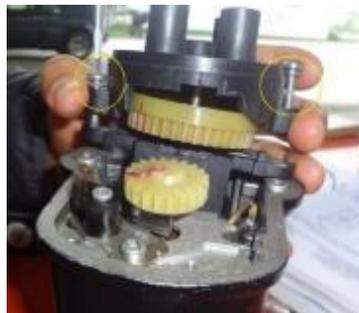
*Nota.* Dotar de mucha precaución al momento de remover las partes internas del bloque distribuidor.
