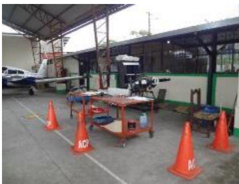
*Nota.* En la figura se puede apreciar la preparación del motor Continental, conos de seguridad, documentación técnica, y herramientas a utilizarse posteriormente.
