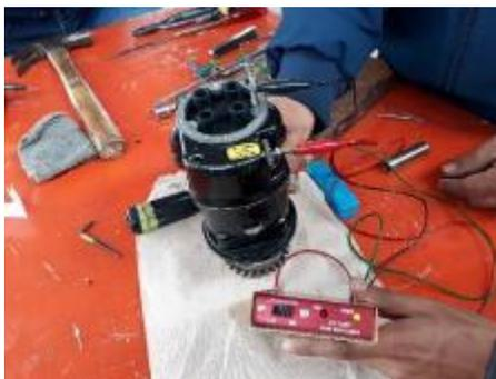
*Nota.* El procedimiento de conexión debe ser cuidadosamente enlazado a los puntos de referencia en donde el magneto lo señala.
