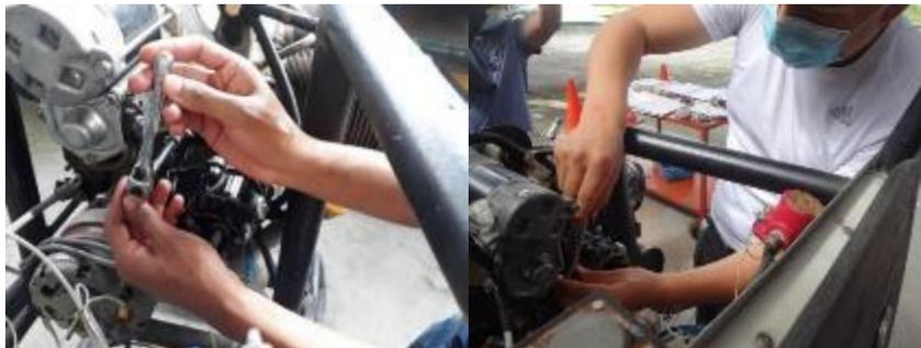
*Nota.* En la figura se aprecia claramente el desacople de las tuercas que están fijados al bloque del motor Continental O-200-A.
