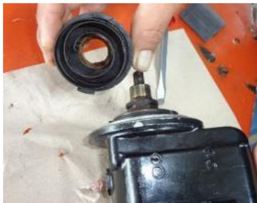
*Nota.* En spring (resorte) interno del casco impulsor del impulse coupling, presenta la superficie externa llena de carbón, debido al contacto con el aceite del magneto.
