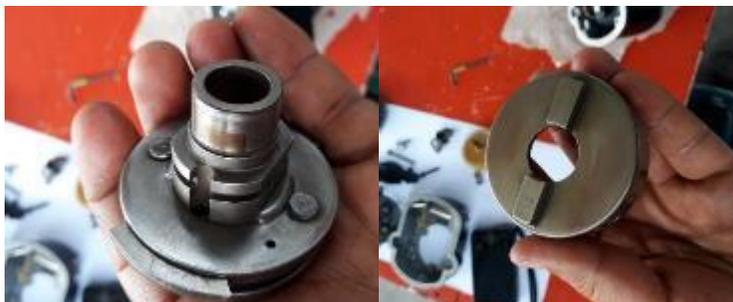
*Nota.* La lubricación del casco impulsor facilita la respectiva instalación en el eje de rotación del magneto.
