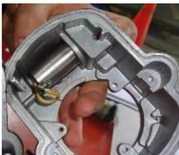
*Nota.* En la figura se puede apreciar la colocación del condensador, para ello se debe tomar en cuenta que el tornillo gira igualmente con los cables internos.
