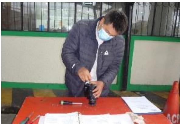
*Nota.* El ajuste de los tornillos debe ser muy sólido ya que estas partes contienen a todos los componentes internos.
