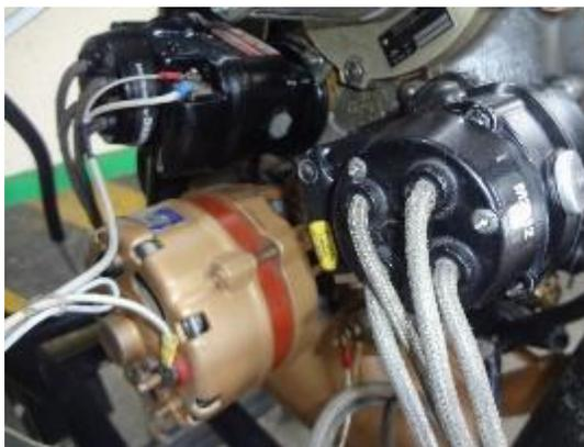
*Nota.* En la figura se puede apreciar que los magnetos del motor se encontraron en óptimas condiciones para su respectiva remoción e inspección a realizar.
