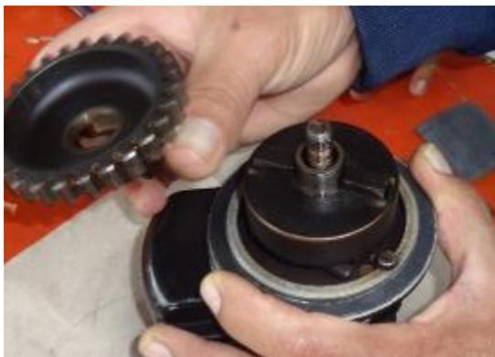
*Nota.* En la figura se aprecia que el casco impulsor contiene partes delicadas interiormente por lo que hay que remover con mucha precaución.
