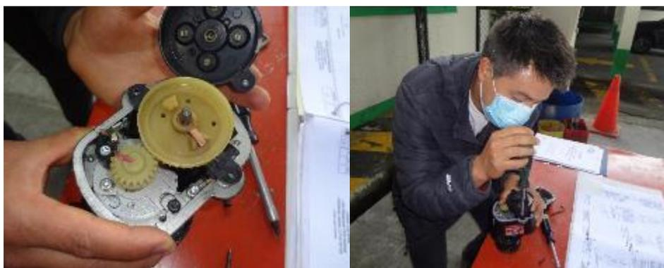
*Nota.* Como se puede apreciar en la figura, se debe tener en cuenta la fuerza de ajuste de los tornillos que sujetan el bloque distribuidor.
