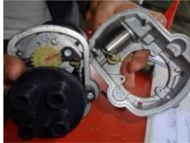
*Nota.* Se aprecia claramente las conexiones de los componentes menores, para lo cual se necesita desconectarlas para seguir con el proceso de remoción.
