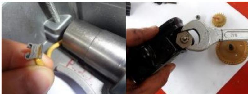
*Nota.* La tuerca de conexión al condensador es una pieza que posee un desenrosque especial al momento de girar con todo el condensador.
