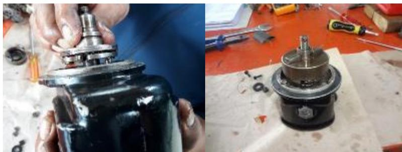
*Nota.* Todos los componentes que conforma la carcasa de impulso, que contiene dentro al resorte, fueron limpiados y lubricados..
