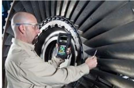
*Nota.* Este método se usa para tener un control de espesor de las superficies causadas por rupturas o desgaste por corrosión. Tomado de (Graham, 2018).
