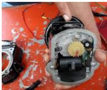
*Nota.* El rotor de rueda y la marcación señalada deben quedar correctamente ajustados.
