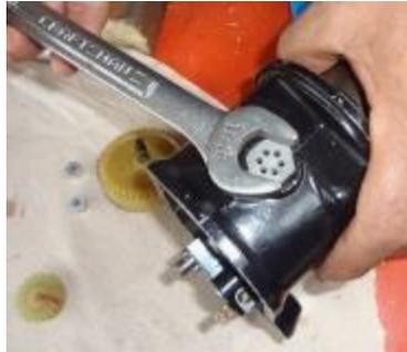
*Nota.* En la imagen se aprecia la remoción de la tuerca del air vent (respiradero), misma que cumple con el propósito de ventilación interna del magneto.
