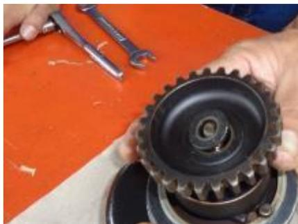
*Nota.* En la imagen se aprecia la remoción del rotor una vez ya retirado la tuerca que lo sujeta al cuerpo del magneto.
