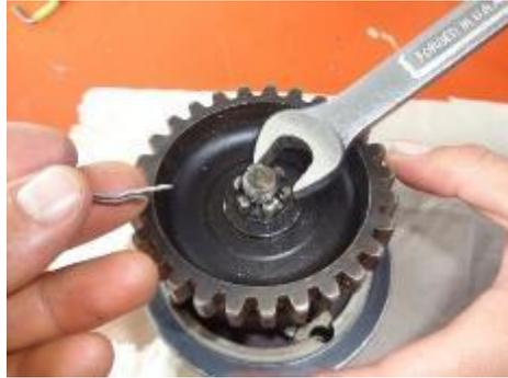
*Nota.* En la imagen se aprecia la remoción de la tuerca del impulse coupling para remover el rotor que está conectado al coupling del magneto.
