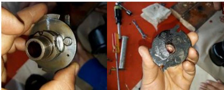
*Nota.* El casco impulsor es un componente que está en contacto con el aceite que está en rozamiento con la superficie de giro del magneto, por lo que se debe limpiar y posteriormente lubricar para su libre movimiento de rotación.
