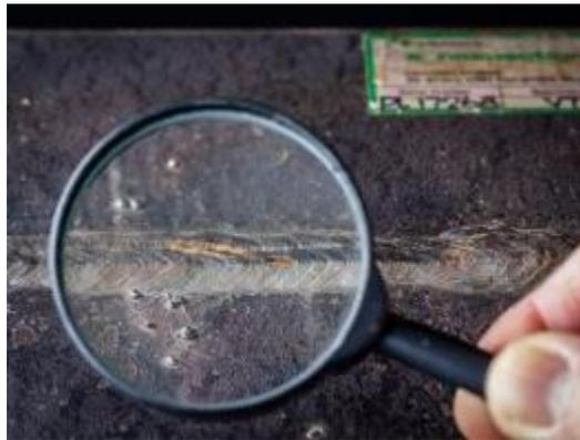
*Nota.* Este tipo de inspección puede ser también requerida con la ayuda de fuentes de luz como linternas para una mejor apreciación. Tomado de (ipunto ensayos , s.f.)
