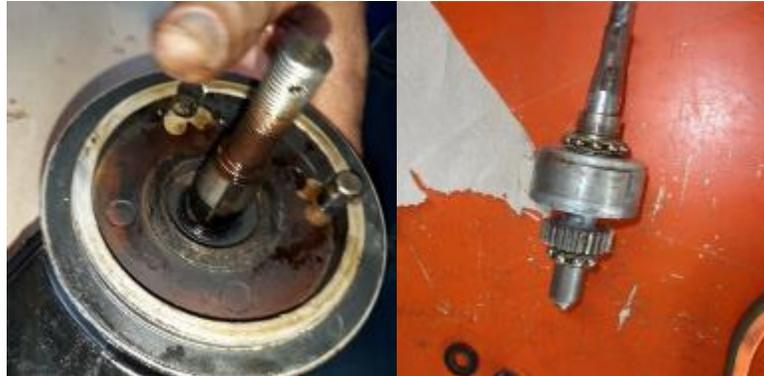
*Nota.* La superficie del rotor posee decoloración por lo que requiere de una limpieza.
