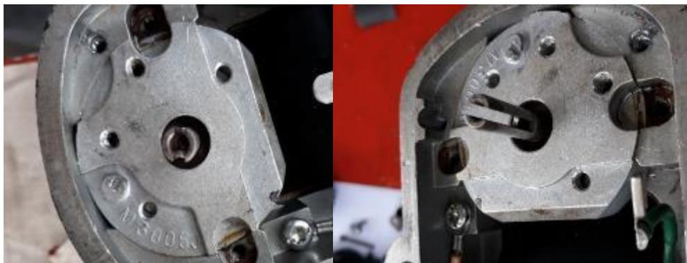
*Nota.* La letra J en el cojinete de rodamiento, respresenta la configuración correcta que posee el cuerpo del magneto, caso contrario de no serlo deberá ser reemplazado.
