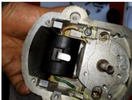
*Nota.* Los cables de la bobina son de material flexible y deben ser removidos con mucha precaución para evitar cortes o desgaste del material exterior.
