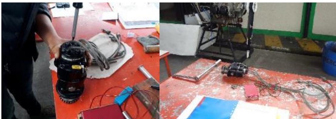
*Nota.* En la imagen se observa la instalación del arnés eléctrico en el cuerpo del magneto, mismo que será probado para su funcionamiento con las bujías.
