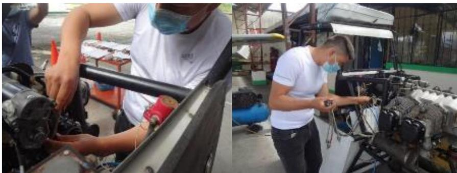
*Nota.* El arnés eléctrico debe ser ajustado correctamente a las bujías del motor.
