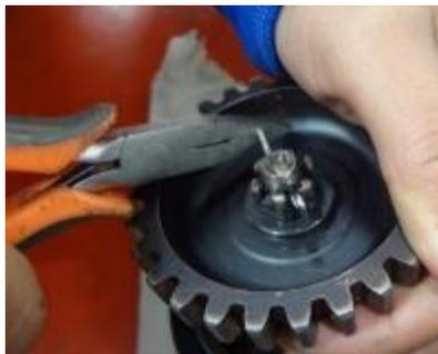
*Nota.* En la figura se observa la remoci6n del pin de la tuerca del rotor del impulse coupling, usando una pinza y sujetando fijamente sin ocasionar da6os a la superficie.
