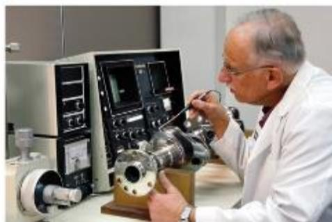
*Nota.* Este método utiliza corriente eléctrica alterna que circula por la parte o pieza, en donde genera un campo magnético alrededor de una sonda u bobina. La cual emitirá señales de defecto si existe discontinuidad. Tomado de (Victor Aviation, 2014)
