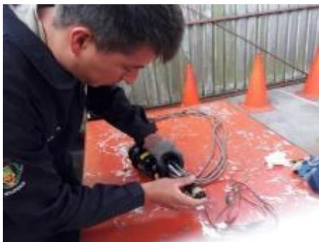
*Nota.* La remoción de la carcasa del arnés eléctrico facilita el proceso de inspección como también el de evitar riesgos con los componentes de conexión de bujías.
