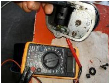
*Nota.* La verificación de la continuidad asegura el buen estado de las conexiones.
