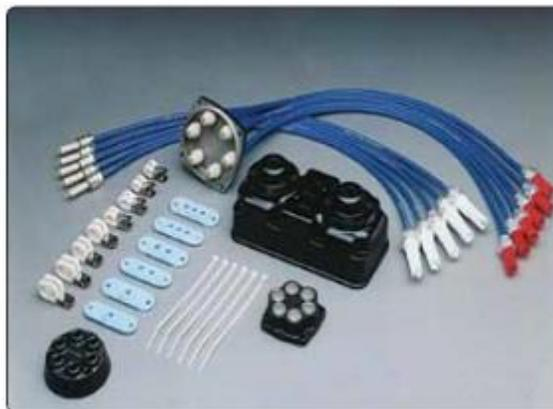
*Nota.* En la figura se puede apreciar un arnés para un motor de 6 cilindros, el arnés eléctrico cumple con la seguridad del sistema de encendido ya que su material de elaboración protege a los cables de las temperaturas que el motor emana. Tomado de (FEDERAL AVIATION ADMINISTRATION, 2012)
