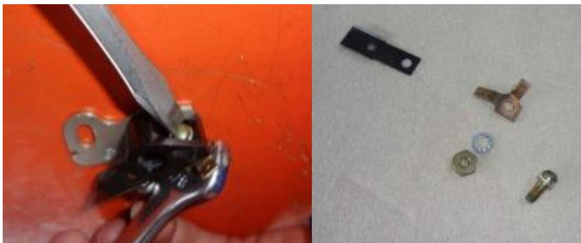
*Nota.* Se debe poner las partes removidas en un fondo en un lugar visible, para detectar si existe daños en la superficie y en los contactos.
