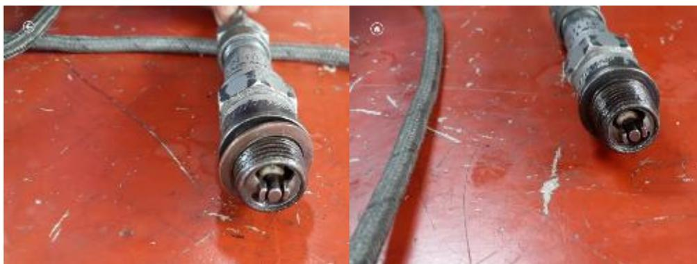
*Nota.* En la imagen se observa el método de comprobación de chispa entre electrodos.
