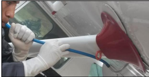
**Figura 44 Presurización de los depósitos**
