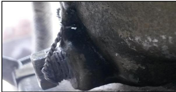
**Figura 54 Aseguramiento del drain plug**
