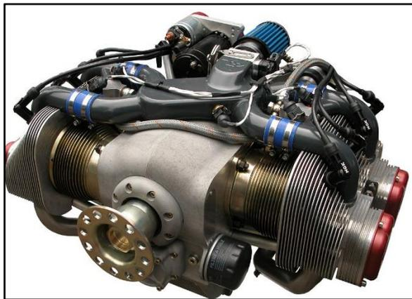
**Figura 6 Motor de cilindros opuestos**
