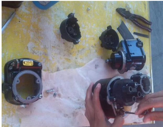
**Figura 23 Seccionamiento de los magnetos**
