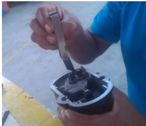
**Figura 28 Calibración del platino**
