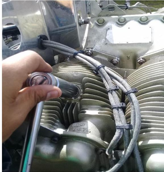
**Figura 40 Extracción de la bujía n° 1**
