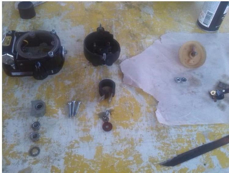
**Figura 34 Limpieza de los componentes del magneto**
