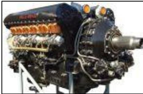
**Figura 4 Motor en V**
