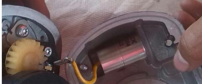
**Figura 35** Instalación del condensado
