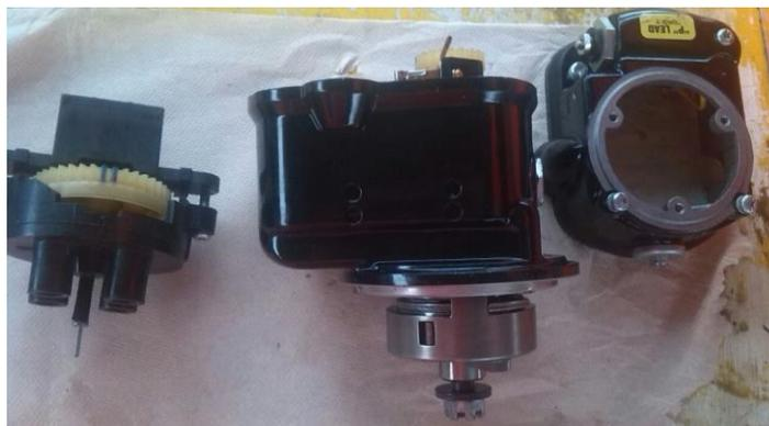
**Figura 26 Inspección del rotor**
