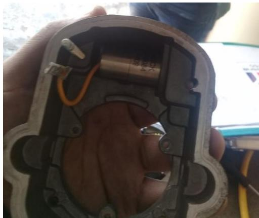
**Figura 33 Condensador**
