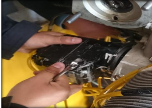
Figura Desinstalación de magnetos bendix
