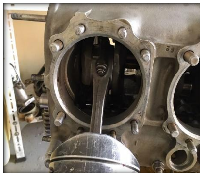
Figura : Instalación de los pistones
