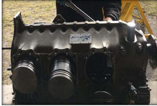
Figura : Armado del bloque del motor
