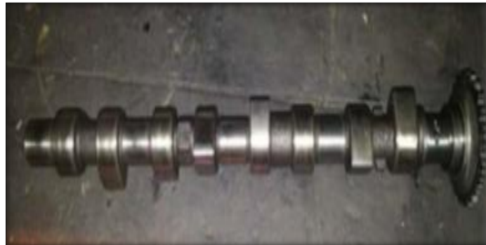
Figura Inspección del árbol de levas
