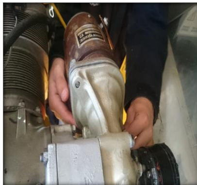
Figura : Instalación del arranque del motor
