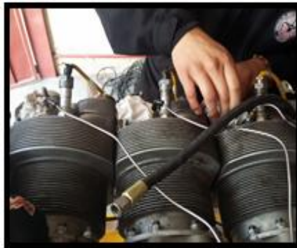
Figura Desinstalación de cañerías
