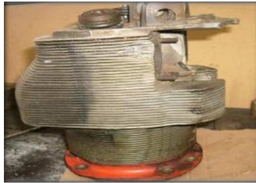
Figura Remoción del cuerpo del cilindro
