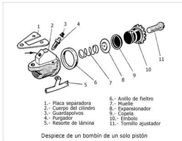
Figura 1.20 Despiece de un bombín.
