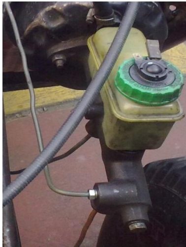
Figura 3.14 Instalación cañerías de freno.
