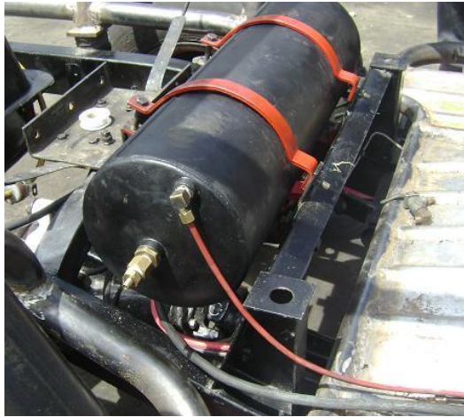
Figura 2.13 Instalación del tanque de aire.
