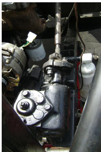
Figura 4.13 Caja de la dirección conectada a la barra de la dirección.
