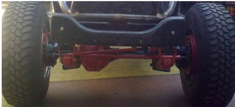
Figura 4.10 Barra de la dirección conectada a la biela de la caja de la dirección.
