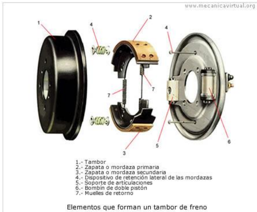
Figura 1.13 Elementos que forman un tambor de freno.
