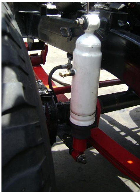
Figura 2.10 Amortiguador delantero ya montado en el vehículo.
