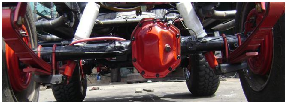
Figura 3.18 Cañerías frenos traseros conectadas y libres de aire.
