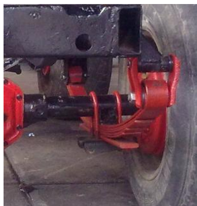
Figura 2.6 Ballesta del vehículo Crosscar.
