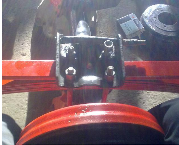
Figura 2.7 Montaje y sujeción de la ballesta al eje.
