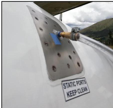
**Figura 26.** Conexión estático
