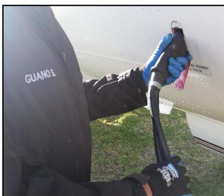
**Figura 30.** Conexión a la GPU
