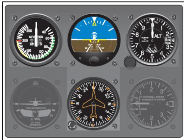
**Figura 6.** Instrumentos de vuelo
