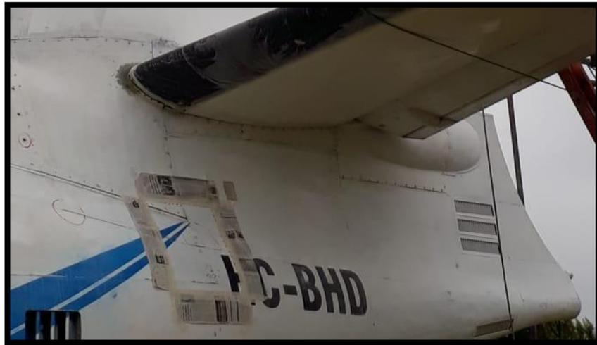
\* La protección es necesaria para aislar la superficie que no cuenta con ningún daño, esto se lo realiza según la información técnica donde se especificaba que el trabajo de decapado es solo para áreas afectadas con corrosión
