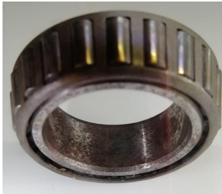
Corrosión en la Superficie del Rodamiento
