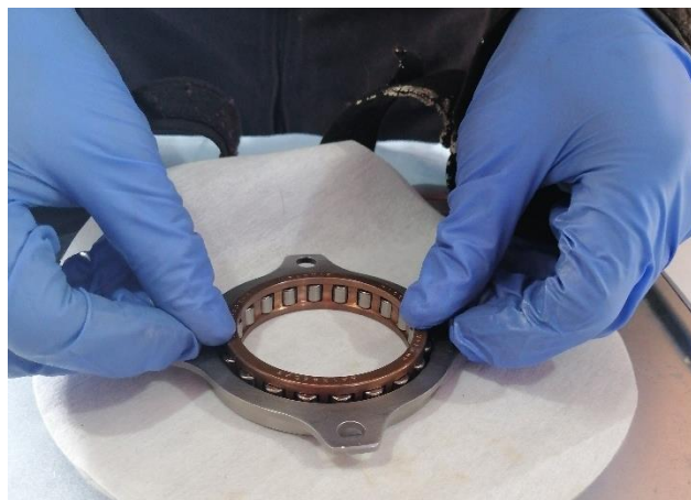
Rodamiento Removido del Tanque Inhibidor
