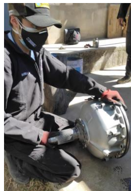
Parte Delantera de la Caja de Reducción Removida
