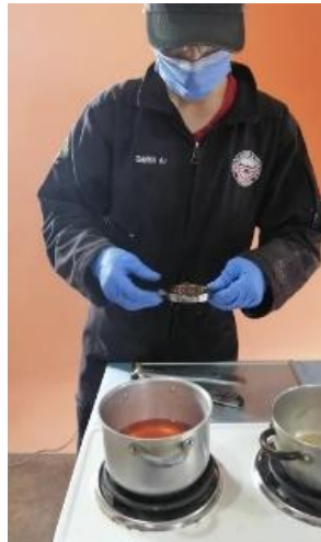
Colocación del Rodamiento en el Tanque Inhibidor
