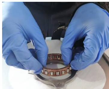
Montaje de las Partes del Rodamiento
