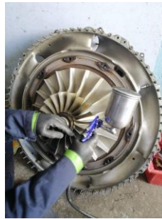
Limpieza del Impulsor de la Segunda Etapa del Compresor
