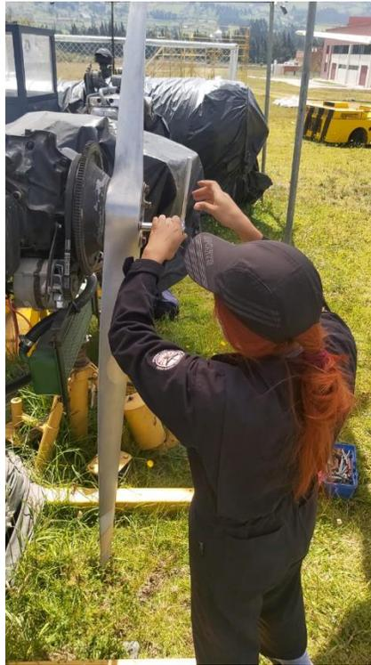
*Nota:*En la imagen se puede apreciar el retiro los pernos montanes en cruz demanera de evitar el daño del hilo de los pernos. Elaboraciòn propia
