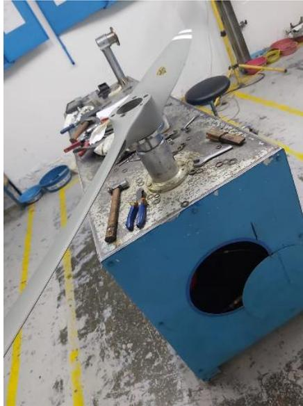
*Nota:*En esta figura se puede apreciar el reacondicionamiento de la hélice .Elaboración propia
