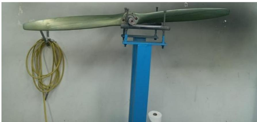
Nota: En esta figura se puede apreciar la manera de realizar el balanceo de la hélice. Elaboración propia
