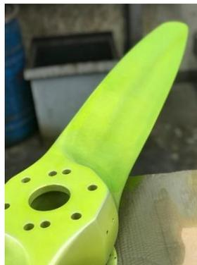
*Nota:*En esta figura se puede apreciar la prueba de liquidos penetrantes .Elaboraciòn propia
