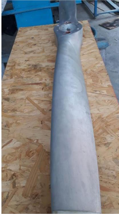
*Nota:*En esta figura se puede apreciar que se realizó la limpieza adecuada a la hélice .Elaboración propia
