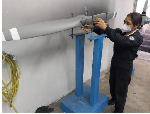
*Nota:* En esta figura se puede apreciar que la hélice se encuentra montada en el banco de pruebas para realizar el balanceo. Elaboración propia
