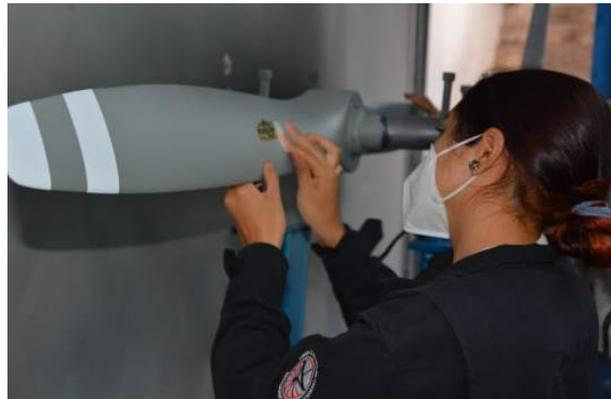
*Nota:*En esta figura se puede apreciar la colocación de los sellos de la hélice.Elaboración propia
