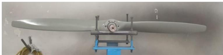
*Nota:*En esta figura se puede apreciar el proceso de pintura al que se sometió la hélice
