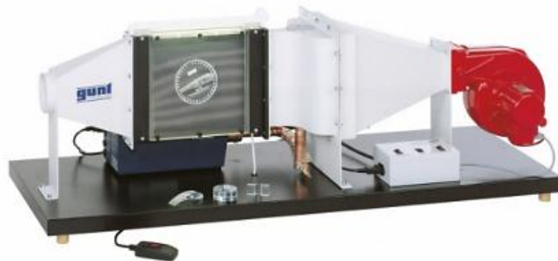
Figura 17 Túnel de viento abierto.
