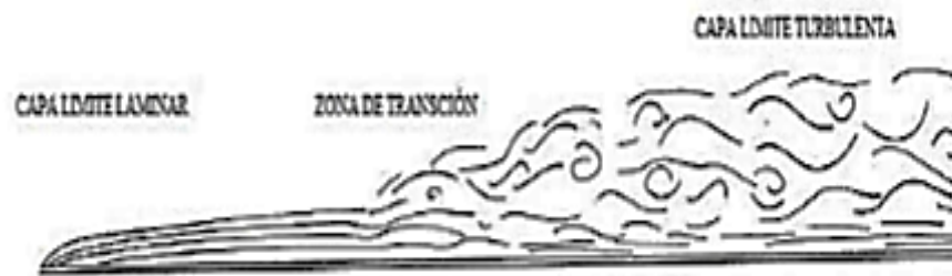
Figura 14 Capa límite laminar y turbulenta.
