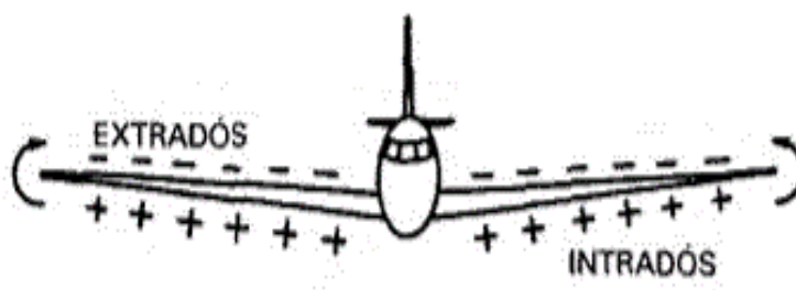
Figura 4 Corrientes transversales en envergadura
