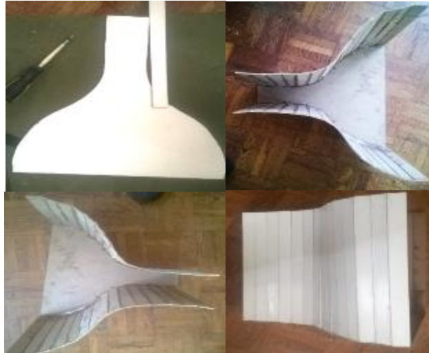
Figura 21 Construcción del cono de concentración
