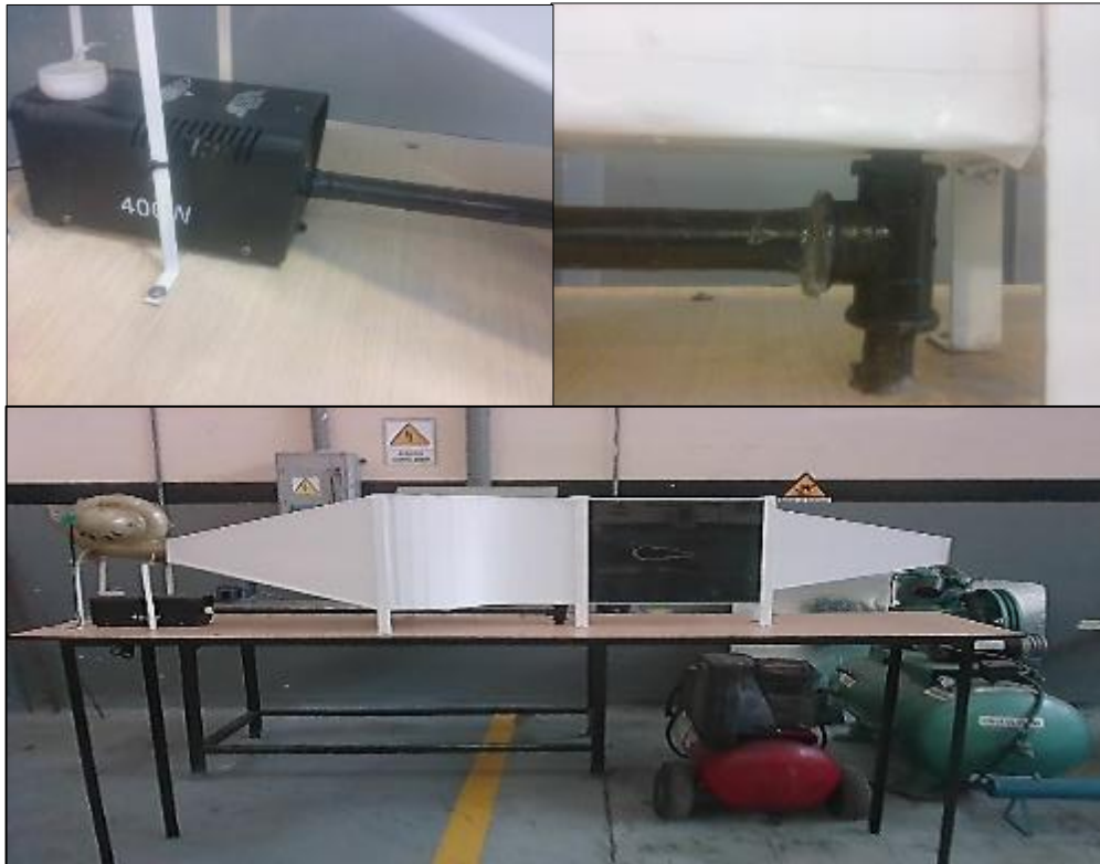
Figura 27 Túnel de viento con visualización de humo
