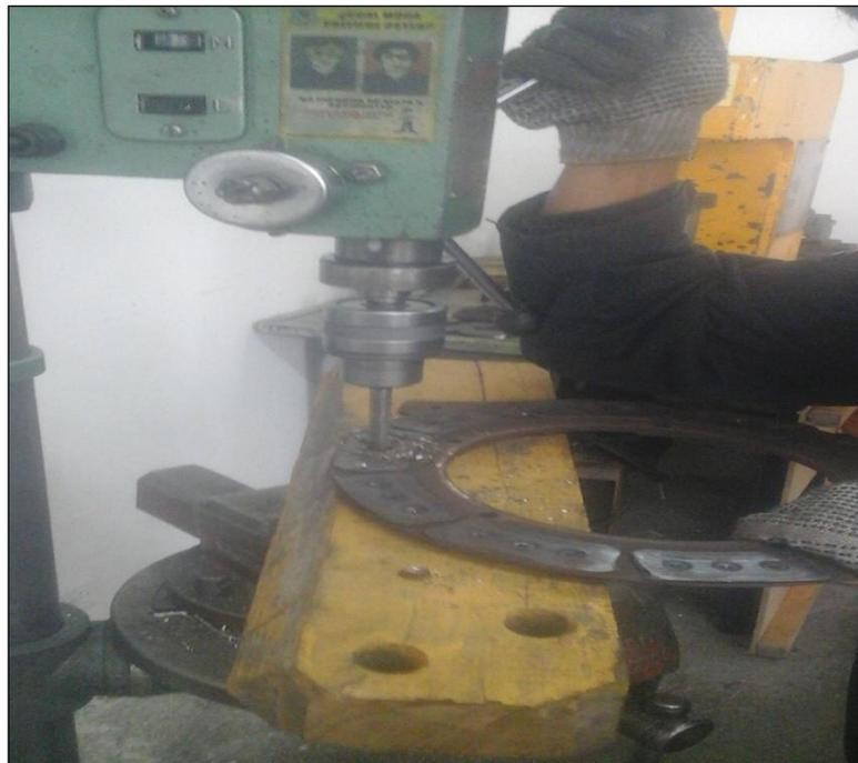
**Figura 52** Reemplazo de las almohadillas de desgaste
