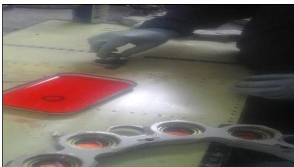
**Figura 66** Lubricación de pistones
