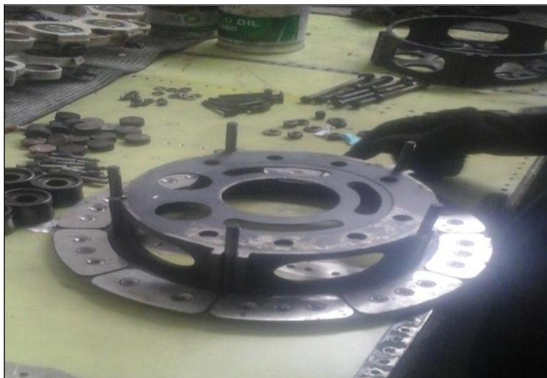
**Figura 69** Instalación de discos rotores y estatores
