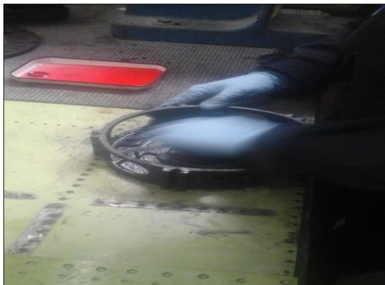
**Figura 14** Limpieza de carcasa de conjunto de frenos
