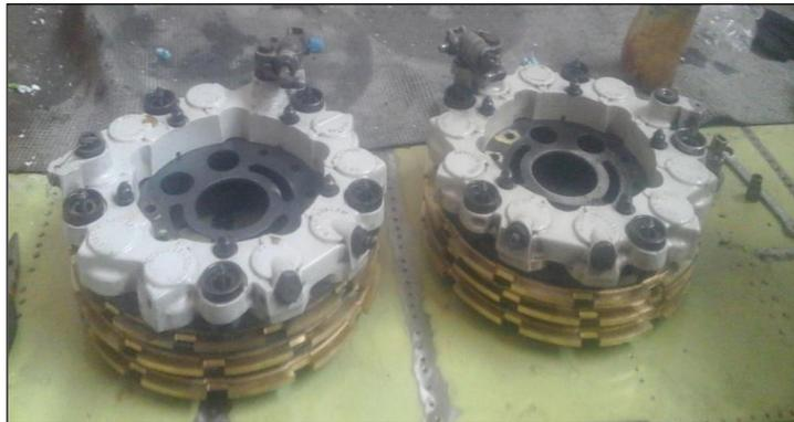
**Figura 10** Conjunto de frenos Avión Sabreliner
