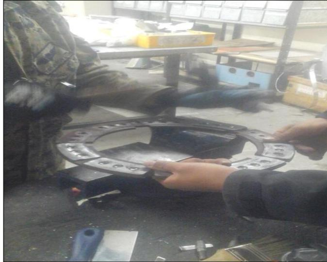
**Figura 16** Limpieza de discos estatores
