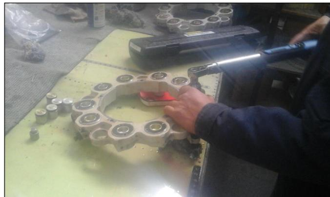
**Figura 68** Ajuste de pistones
