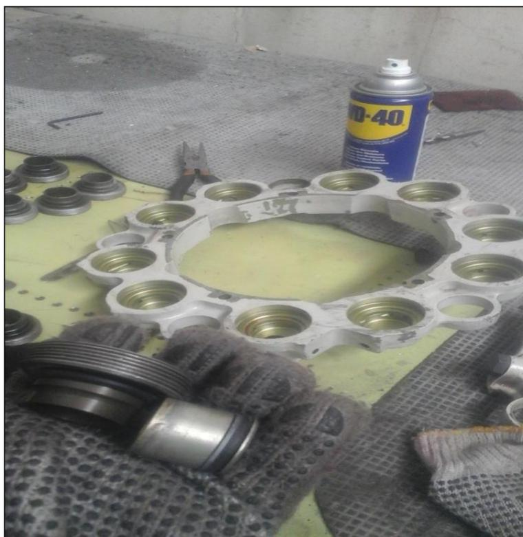
**Figura 34** Revisión de la manga del cilindro
