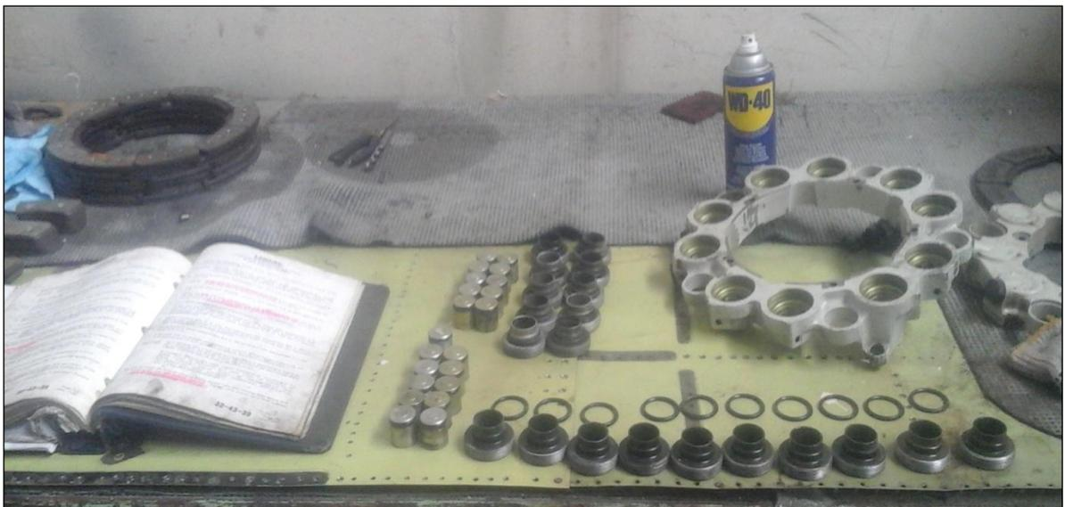
**Figura 64** Componentes para ensamblaje del conjunto de frenos
