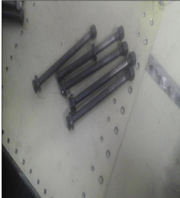
**Figura 37** Perno de freno y pasador de ajuste
