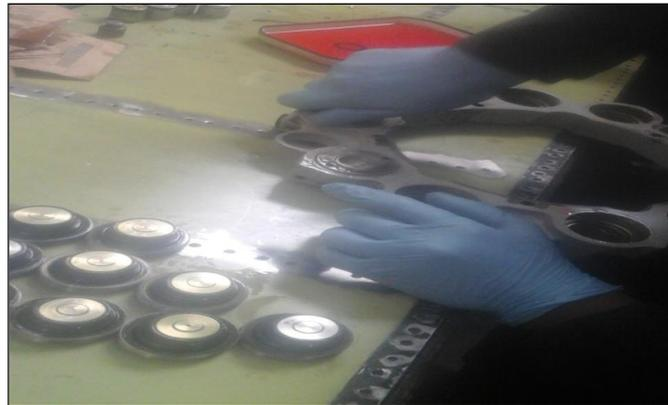
**Figura 67** Ensamblaje de pistones
