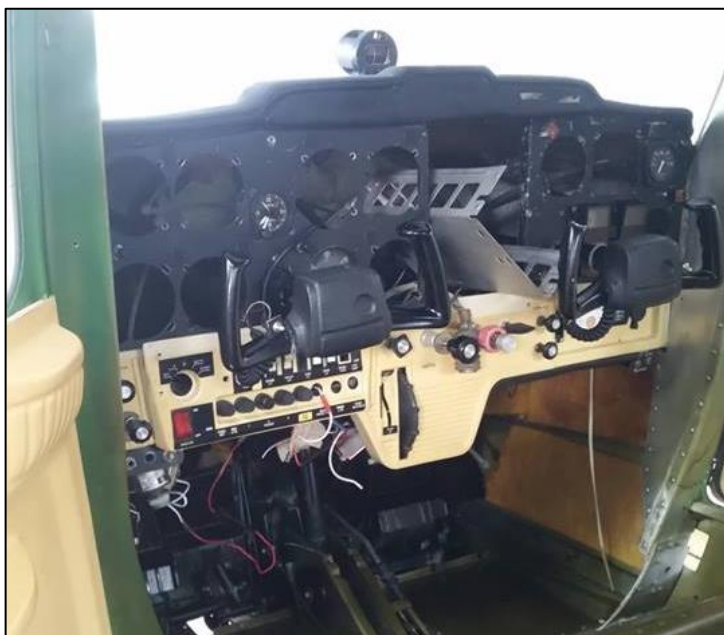
Figura 46 Colocación horizontal de la cabrilla
