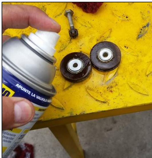
Figura 43 Lubricación de poleas
