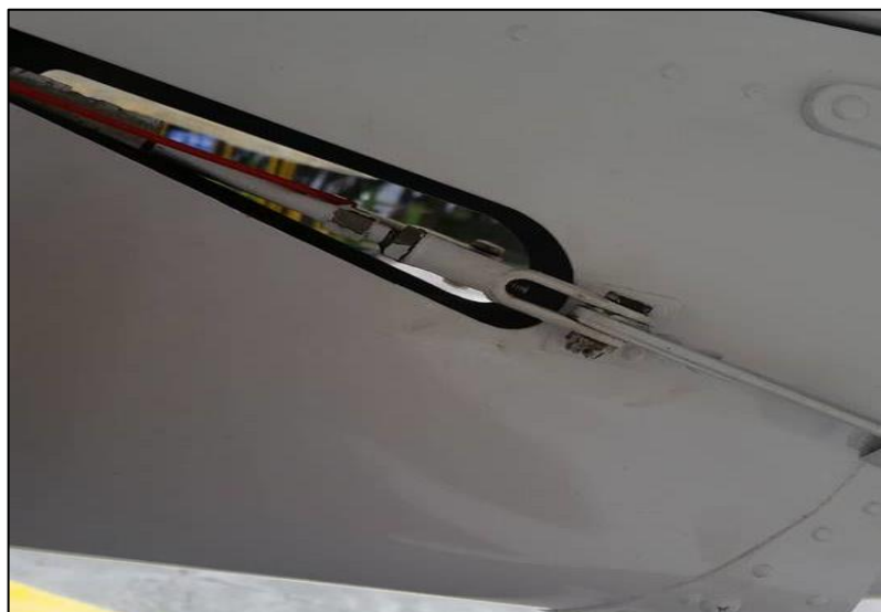
Figura 66 Ajuste de los cables para alinear el rudder
