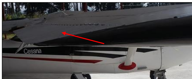
Figura 50 Alerones alineados a las puntas de alas
