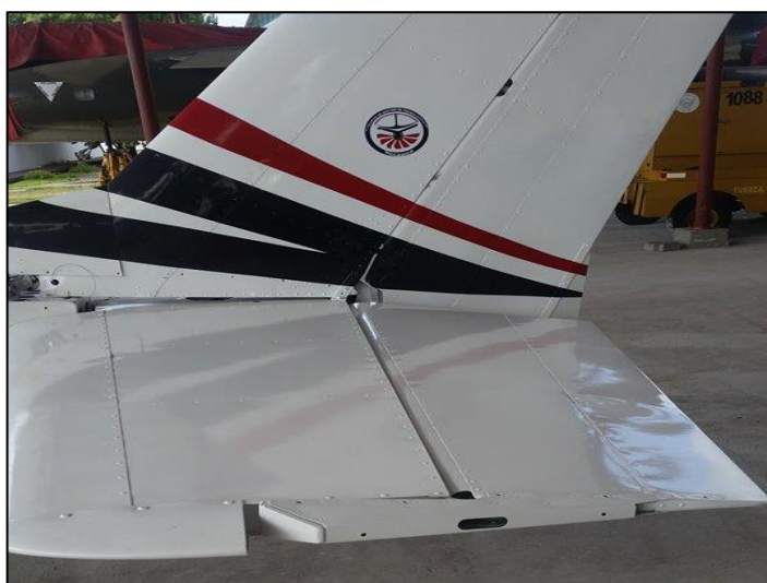
Figura 59 Elevador en posición neutral
