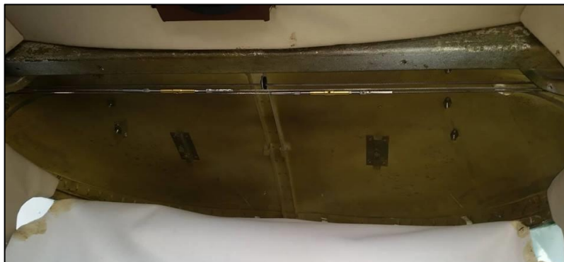
Figura 53 Desmontaje de la tapicería del techo
