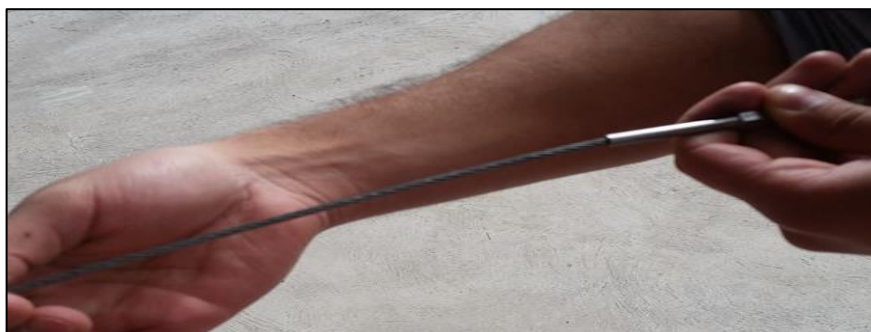
Figura 38 Verificación en busca de que no haya corrosión
