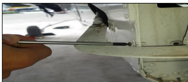
Figura 65 Ajuste de los tornillos de tope
