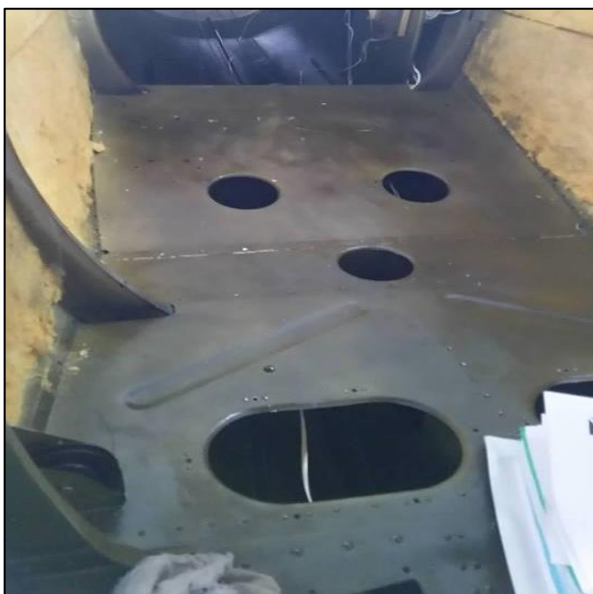
Figura 58 Desmontaje de la tapicería
