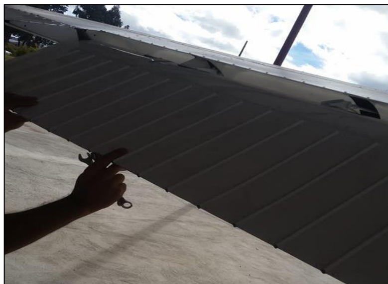
Figura 56 Levantamiento de flaps manualmente
