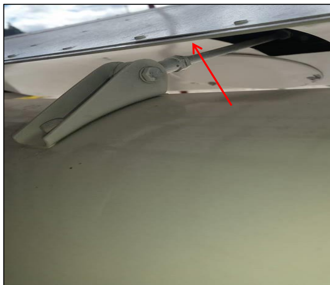
Figura 55 Ajuste de la varilla vaivén
