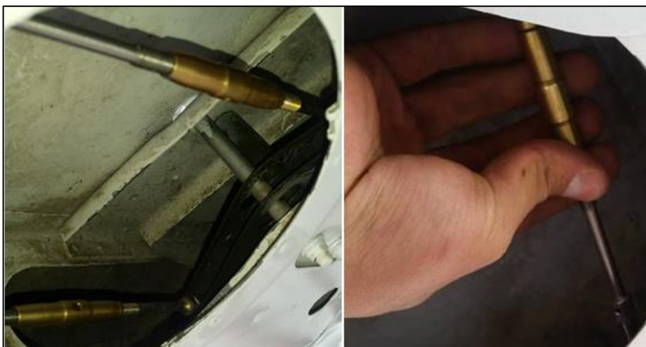
Figura 48 Ajuste de turnbuckles de los alerones
