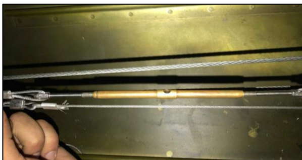
Figura 63 Ajuste del turnbuckle del trim
