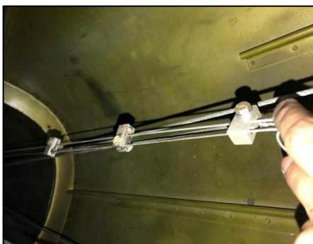
Figura 64 Ajuste de bloques
