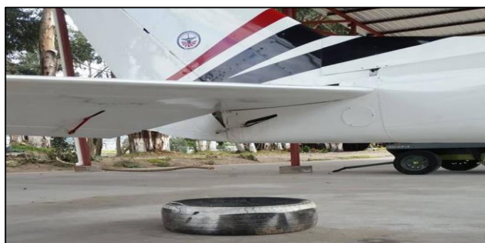
Figura 62 Base para evitar golpes en la cola
