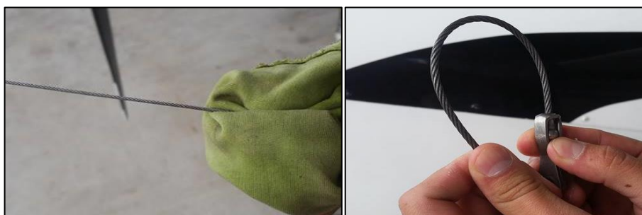
Figura 36 Inspección del cable con paño y verificando rupturas de cables
