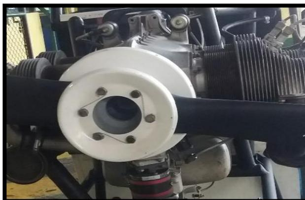
*Nota:* En esta imagen se aprecia el entorchado de los pernos de sujeción de la hélice.
