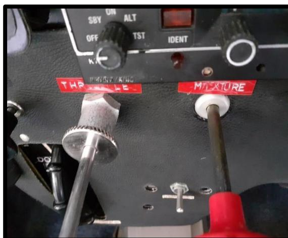
*Nota:* En este grafico se puede apreciar los controles del motor en cabina de donde serán removidos.
