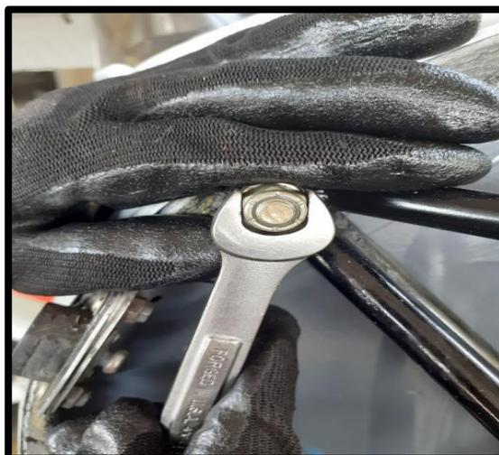
*Nota:* En el grafico se observa la remoción de los pernos del soporte del motor con una llave mixta.
