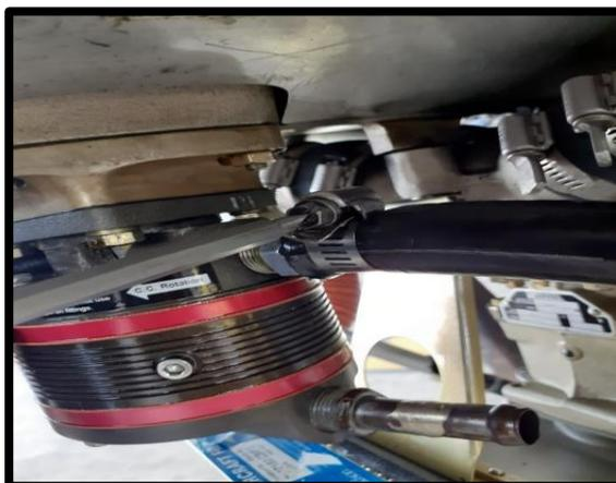
*Nota:* En este gráfico se observa la remoción de la línea de la bomba de vacío.
