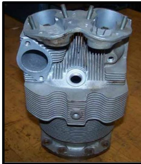
*Nota:* En el gráfico se aprecia el cilindro de un motor alternativo. Tomado de (Administration)
