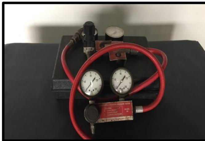
*Nota:* En esta imagen se indica el instrumento usado para la medición de compresión .
