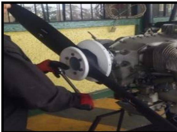
*Nota:* Se puede apreciar el ajuste de pernos de la hélice con una herramienta manual.
