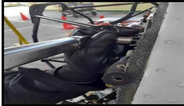
*Nota:* En la imagen se observa la aplicación de torque en los pernos de sujeción del castillo a la pared de fuego.
