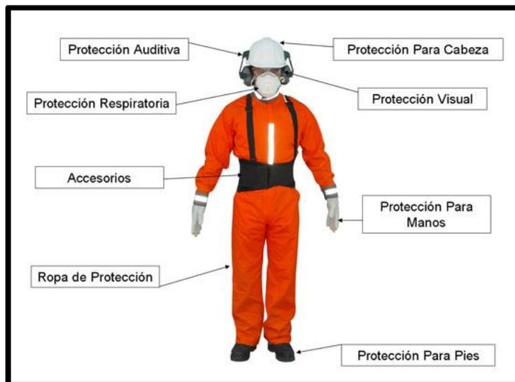
*Nota:* En la imagen se observa los equipos de protección personal que deben ser utilizados.
