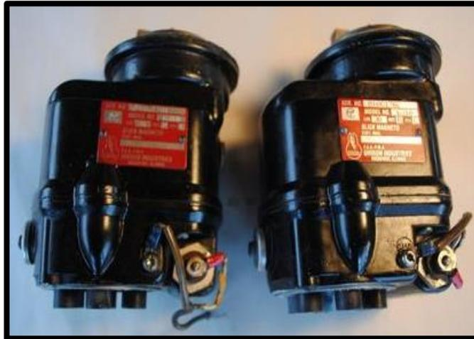
*Nota:* En la imagen se observa los magnetos usados en el motor.
