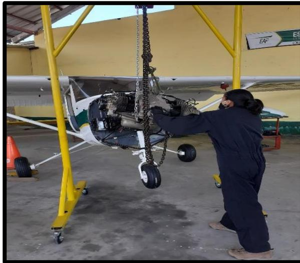
*Nota:* En esta imagen se aprecia el desmontaje del motor con tecele de cadena.
