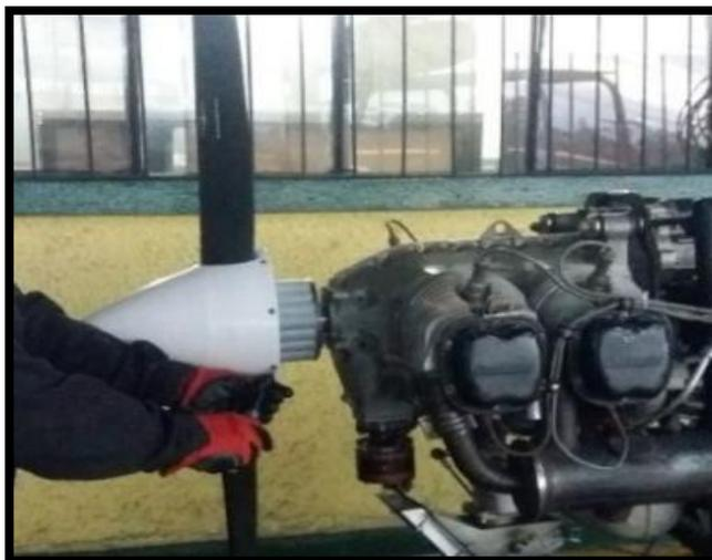
*Nota:* En esta imagen se puede apreciar la remoción de tornillos del spinner.
