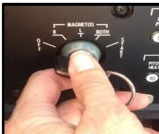
*Nota:* En esta imagen se indica la posición del Switch en off.
