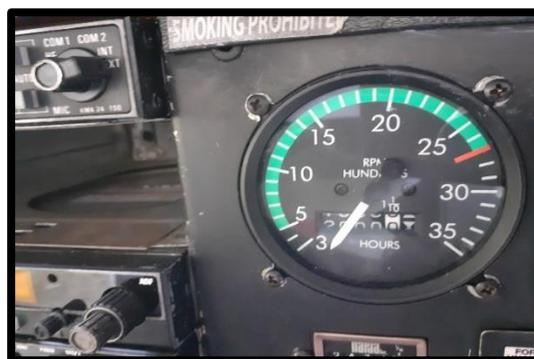
Nota: En esta imagen se puede apreciar el indicador tacómetro con 2000h de operación.
