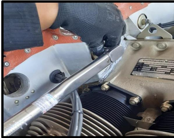
*Nota:* En el gráfico se observa la aplicación de torque en los pernos de sujeción del motor.
