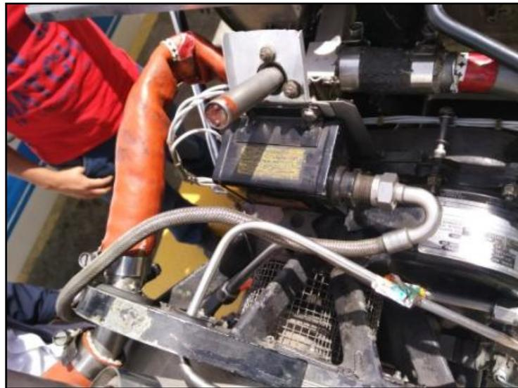
**Figura 68** Generador de chispa ubicado en el APU
