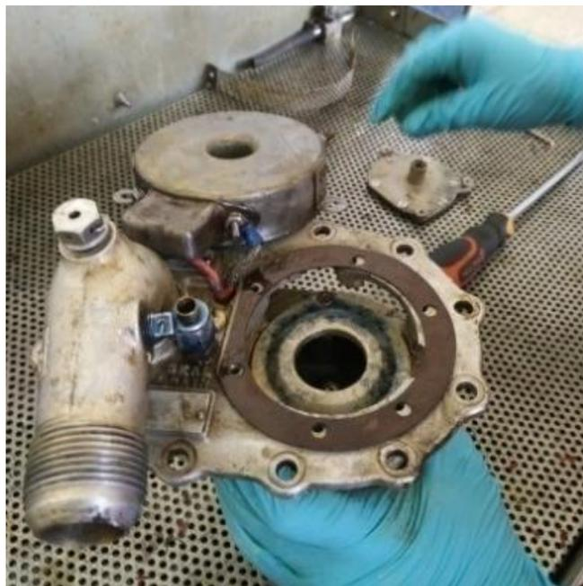
**Figura 34** Empaque deteriorado
