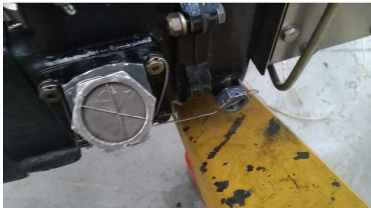
**Figura 78** Entorchado de tapa medidora y tapón de drenaje.
