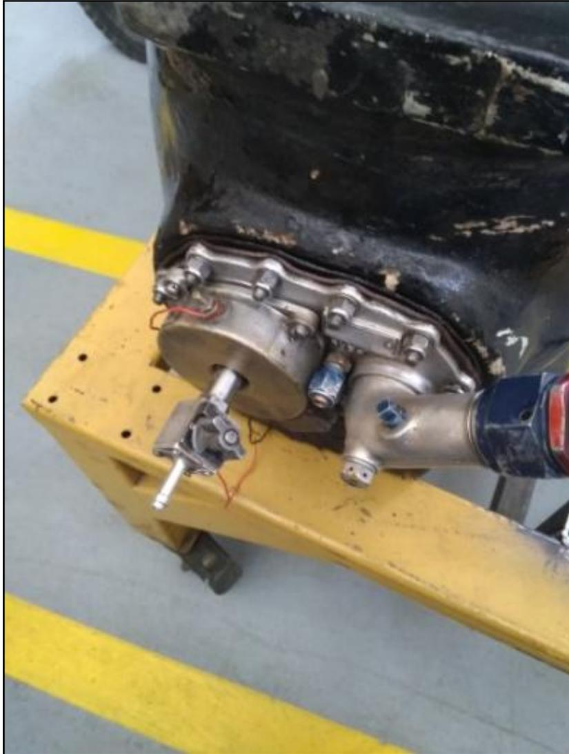
**Figura 51** Válvula de drenaje ensamble en la bomba
