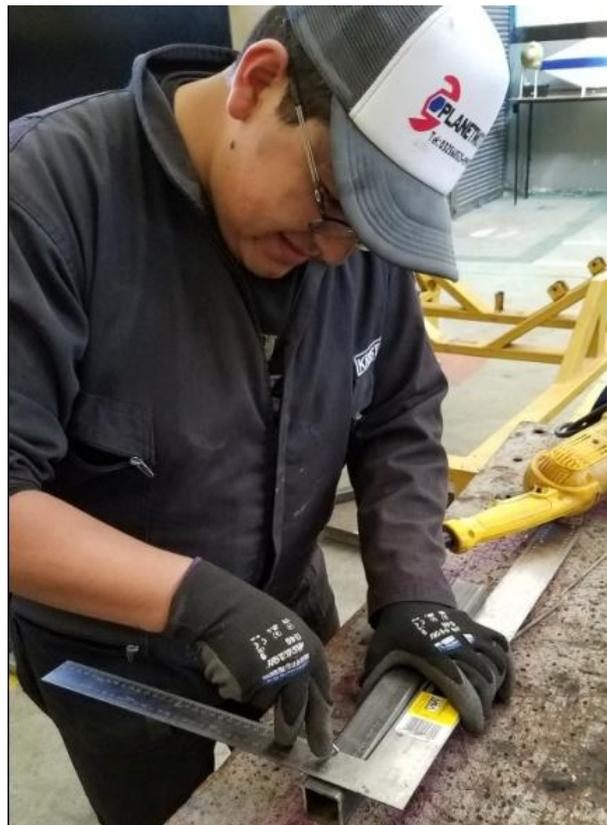
**Figura 20** Medidas y lineamiento de cortes
