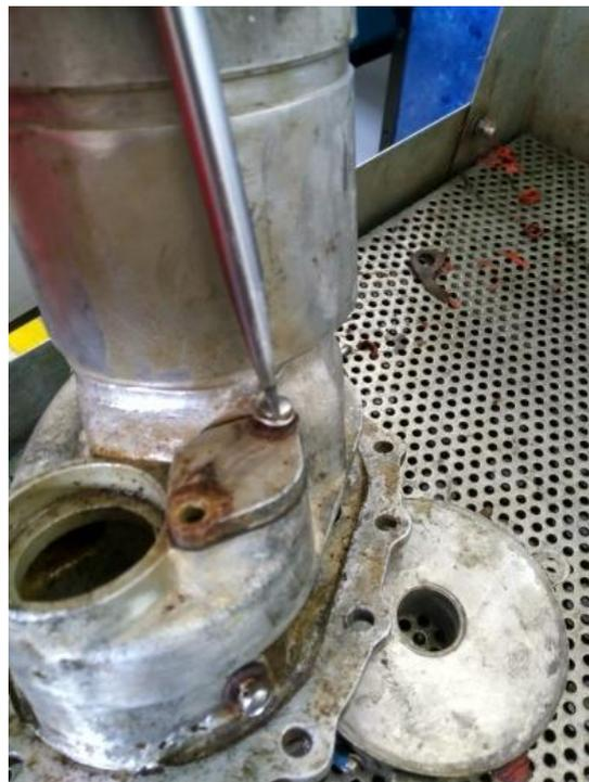
**Figura 38** Extracción de tapas de acceso a la bomba de combustible.
