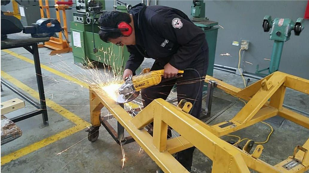
**Figura 24** Eliminación de impurezas con amoladora eléctrica manual.
