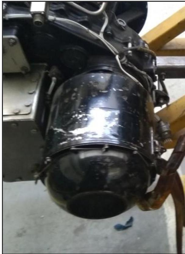
**Figura 71** Generador de la unidad de potencia auxiliar
