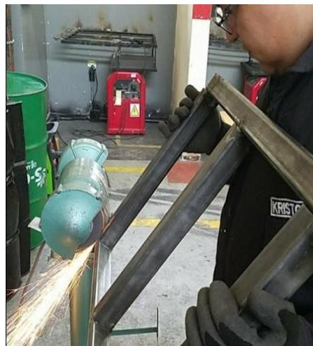
**Figura 23** Eliminación de residuos de suelda con esmeril
