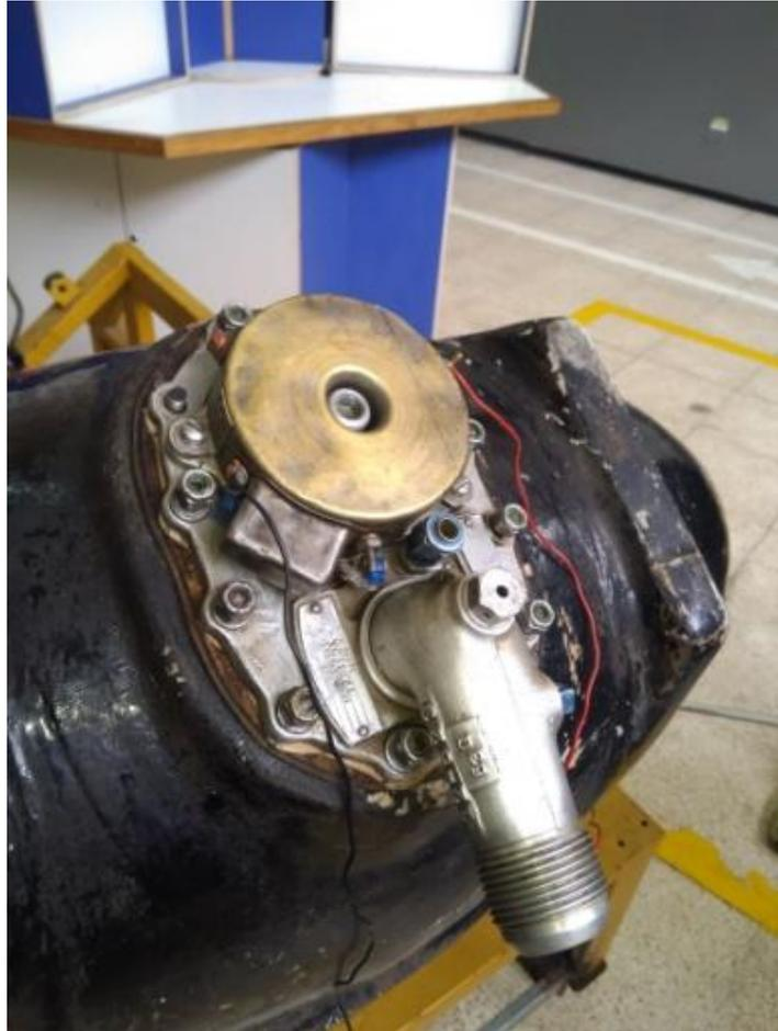
**Figura 49** Montaje de la bomba de combustible
