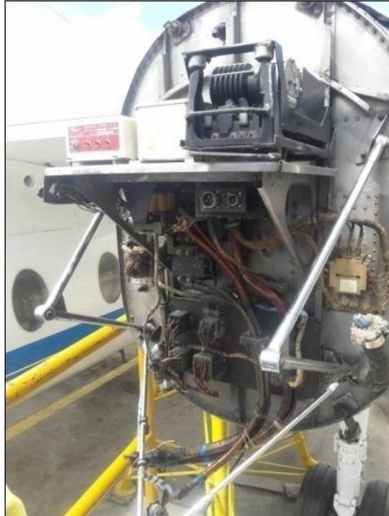
**Figura 29** Puntos de anclaje del APU
