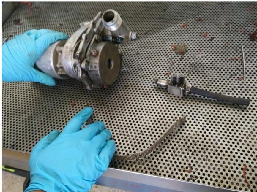
**Figura 32** Extracción de la válvula de drenaje y malla protectora.
