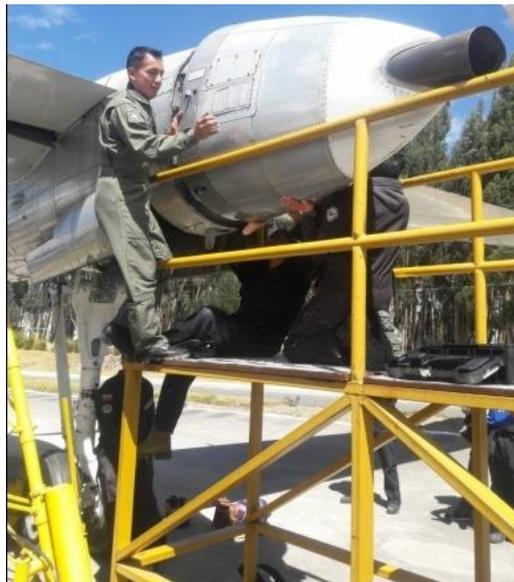
**Figura 26** Extracción de capota protectora
