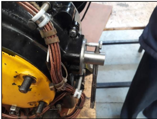
**Figura 99** Prueba de montantes sujetos al motor GTP 30-54 vista lateral
