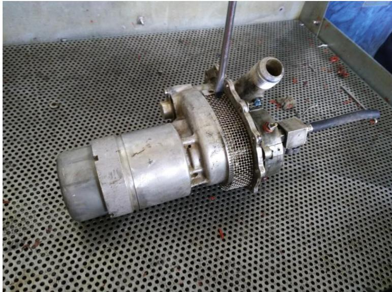
**Figura 31** Bomba de combustible marca PEPSCO
