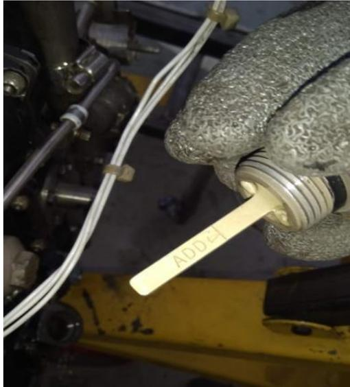
**Figura 77** Verificación de cantidad de aceite después del cambio.
