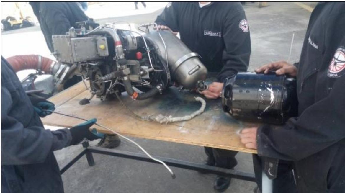
**Figura 30** Colocación de APU en mesa de inspección
