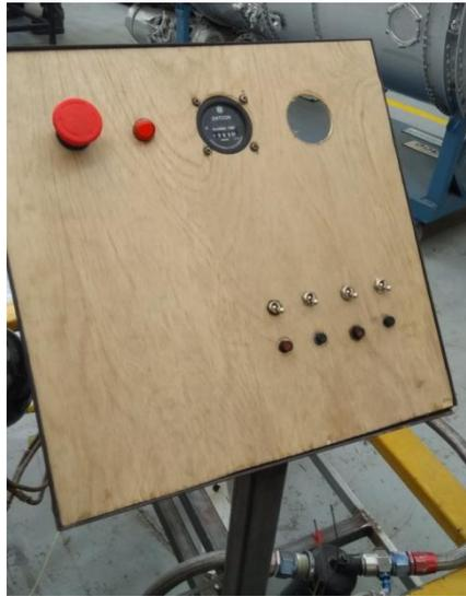
**Figura 83** Colocación de los elementos en el panel.
