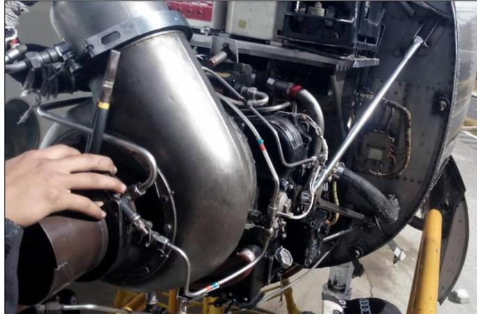
**Figura 27** APU montada en la aeronave.
