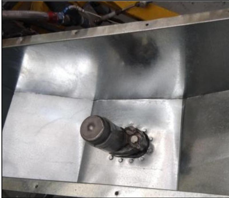
**Figura 57** Tanque con bomba de combustible (sin empaques).
