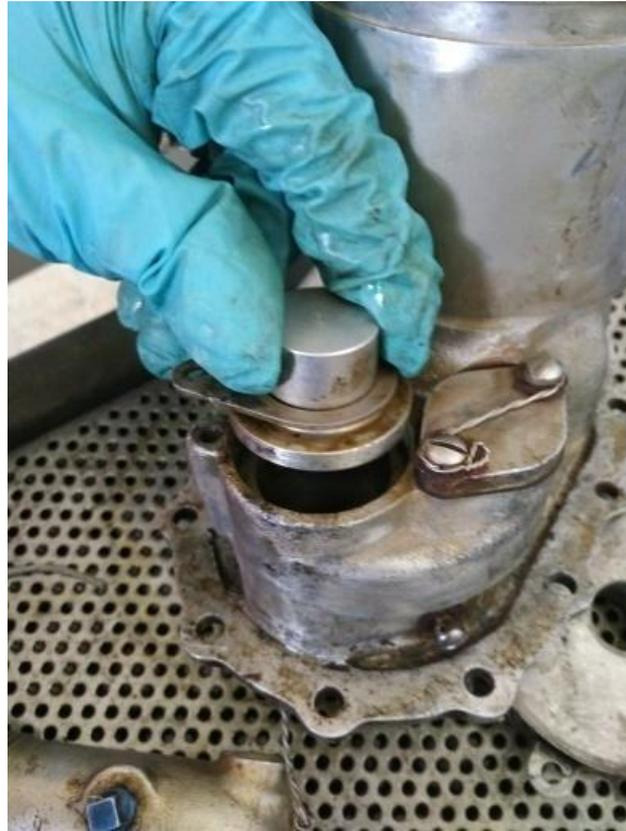
**Figura 37** Extracción de tapas de inspección.
