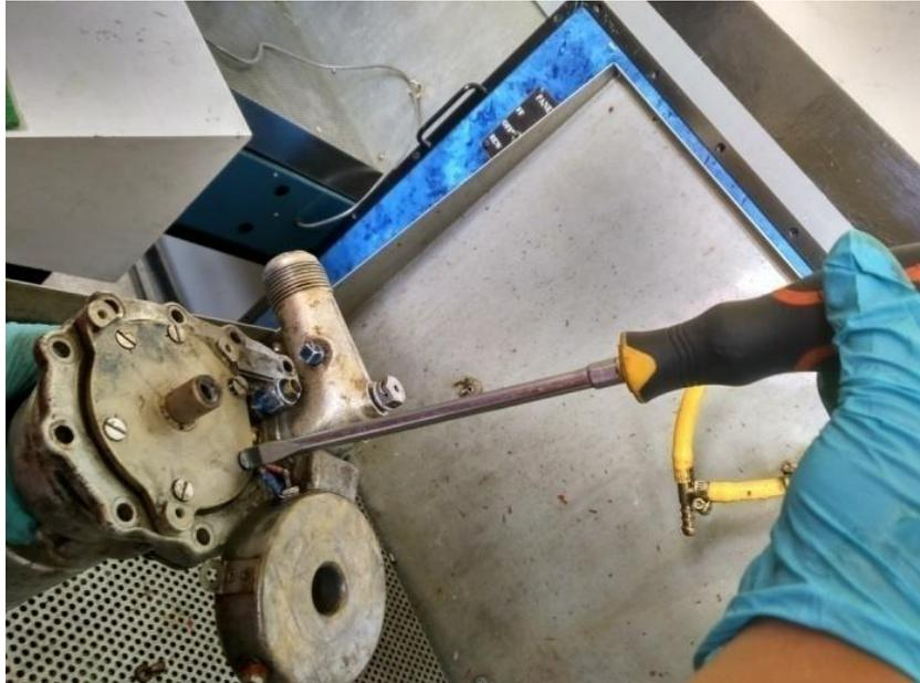
**Figura 33** Desajuste de los pernos de la base
