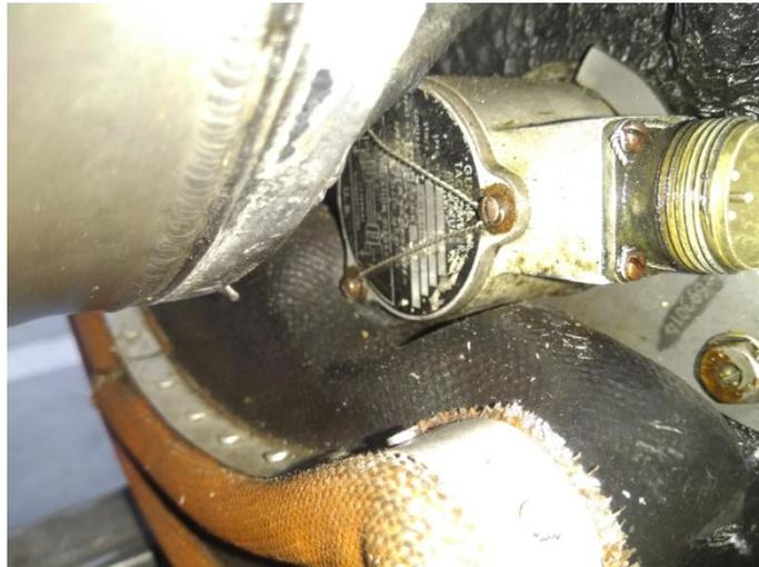
**Figura 8** Generador tacómetro
