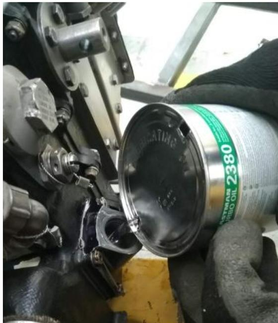
**Figura 76** Colocación de aceite en el sumidero del motor
