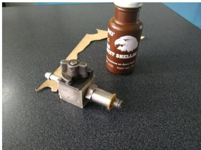
**Figura 50** Colocación de empaques nuevos en la válvula de drenaje.
