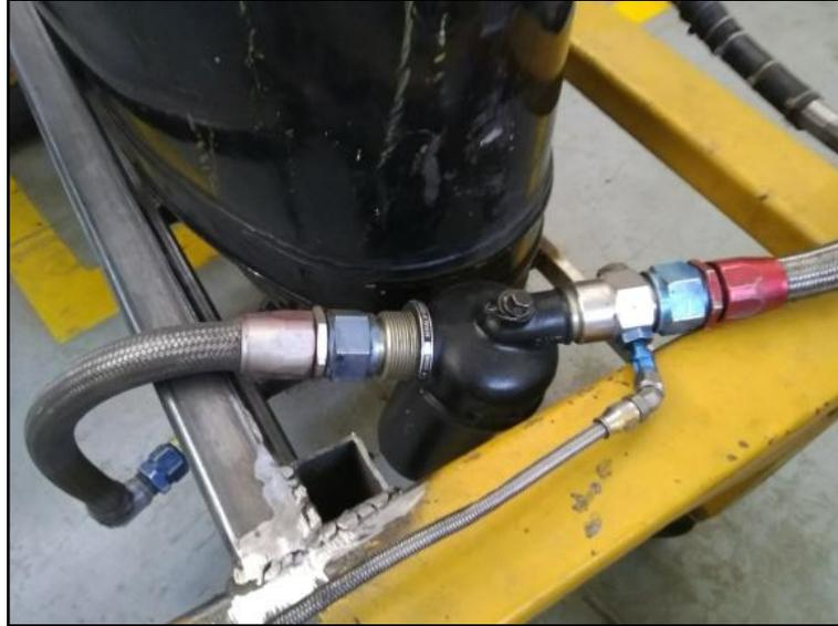
**Figura 61** Sistema de distribución de combustible
