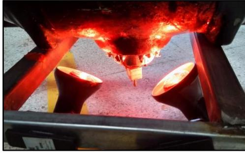
**Figura 54** Secado con lámparas de calor.
