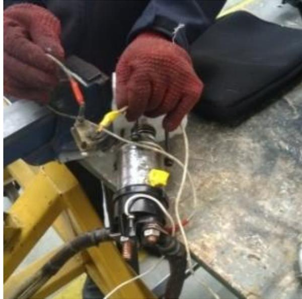
**Figura 66** Conexión provisional de la bobina industrial
