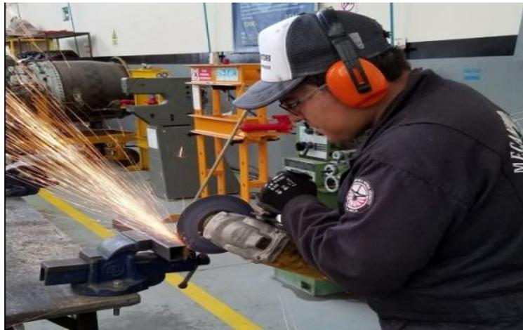
**Figura 22** Corte realizado con amoladora eléctrica
