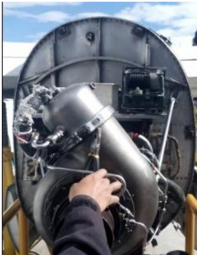
**Figura 28** Unidad de potencia auxiliar sin la capota protectora
