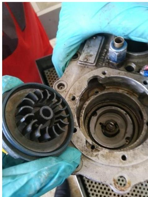
**Figura 36** Turbina interior de la bomba de combustible.
