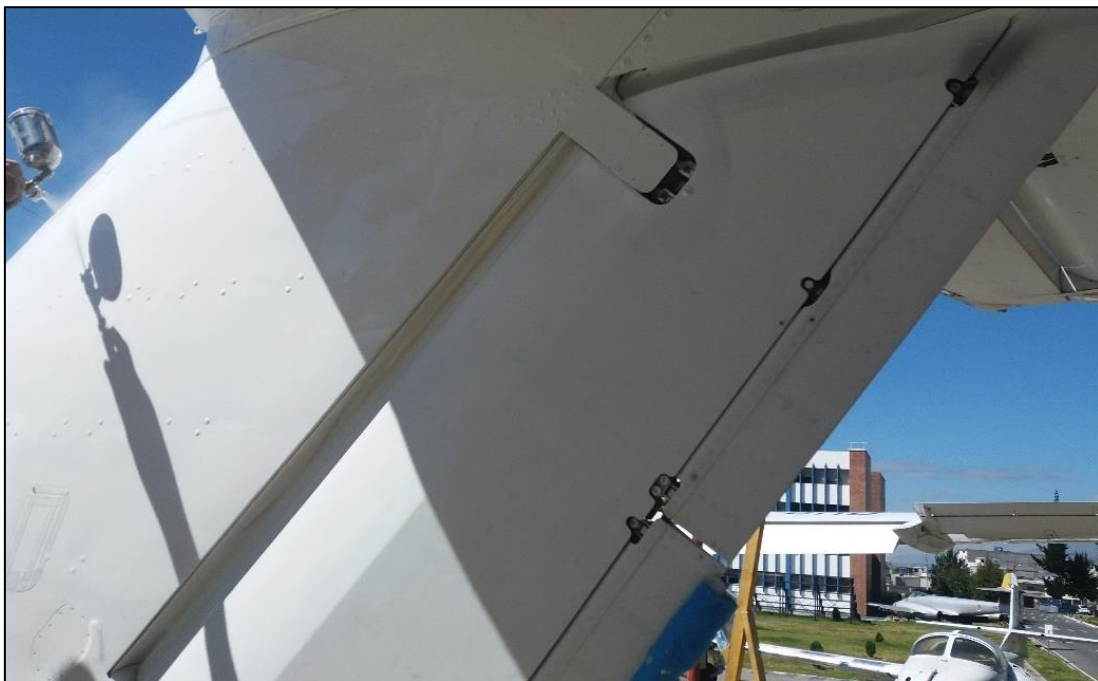
Figura 31 Aplicación de pintura
