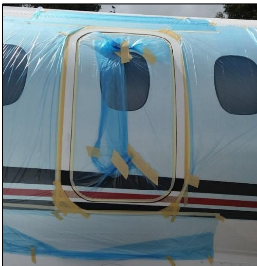
Figura 37 Enmascaro marco para aplicar pintura
