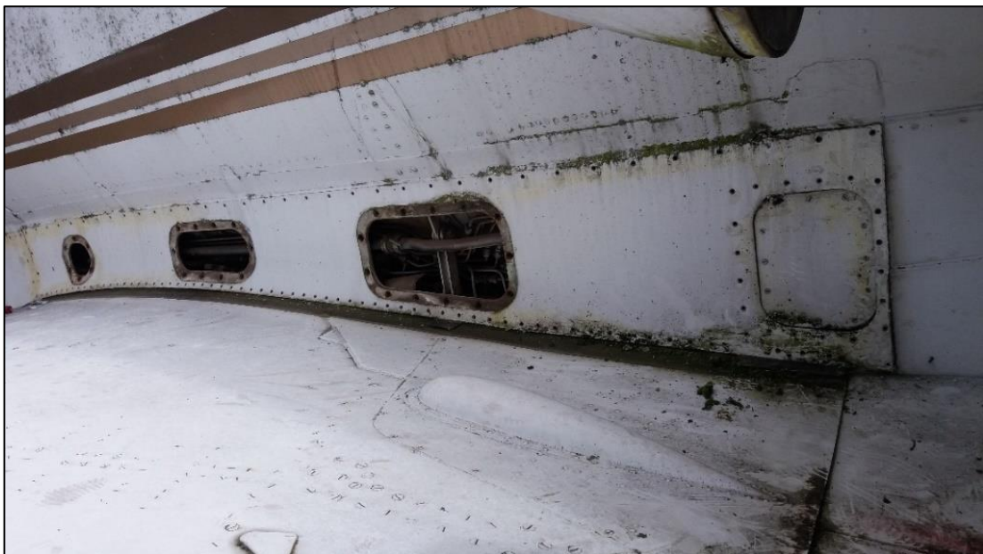
Figura 18 Malas condiciones para la inspección visual
