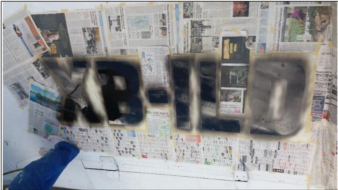
Figura 35 Aplicación de pintura matricula ala
