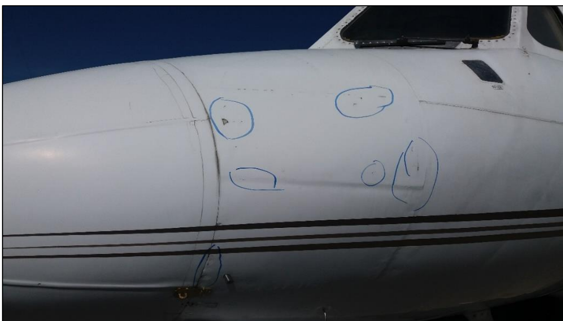
Figura 21 Deterioro de la pintura
