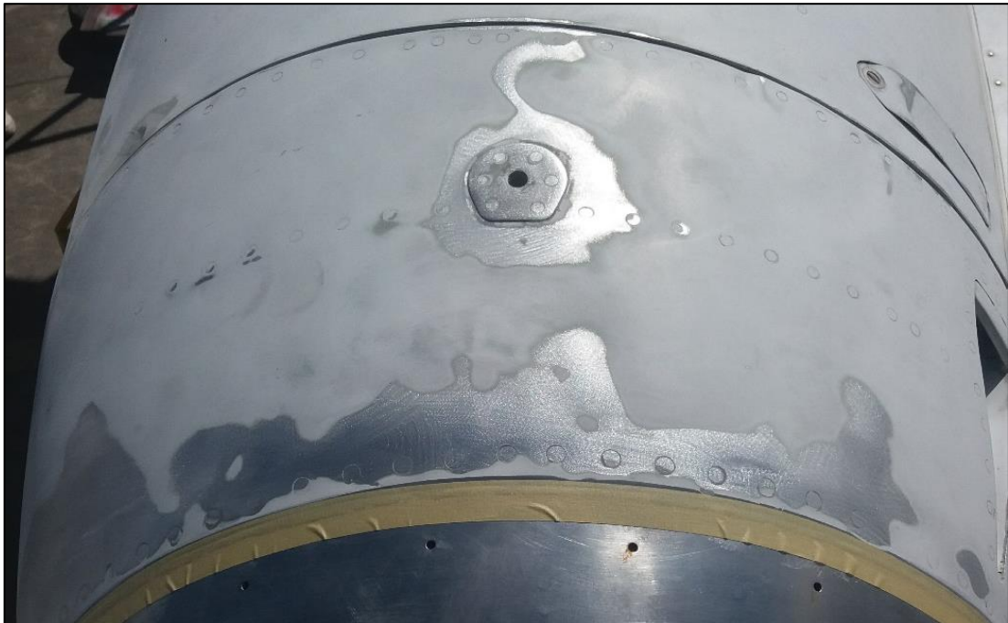
Figura 23 Eliminación de pintura y corrosión
