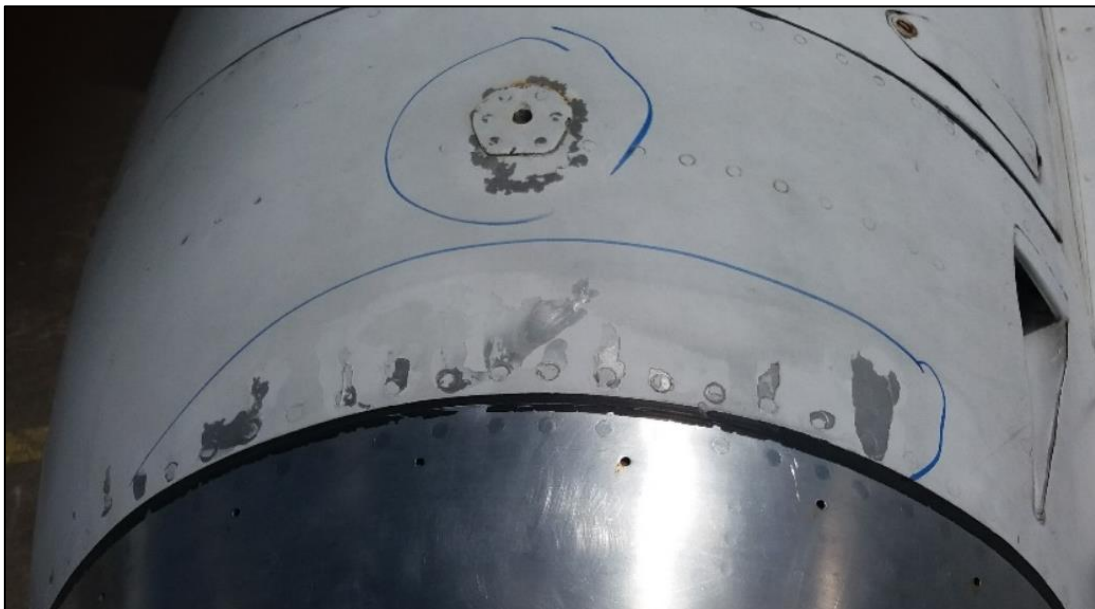
Figura 22 Identificación de corrosión
