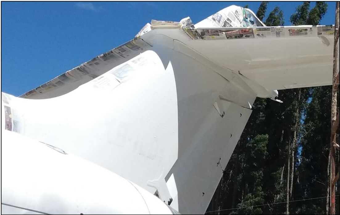
Figura 32 Empenaje con acabado final y brillo
