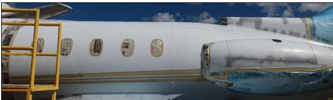
Figura 29 Área lijada, lavada y empapelada en las que no requiere pintura
