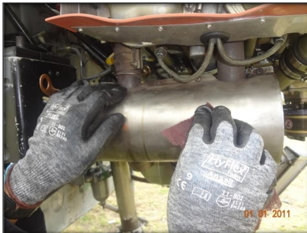
Figura 33. Limpieza del Sistema de Escape
