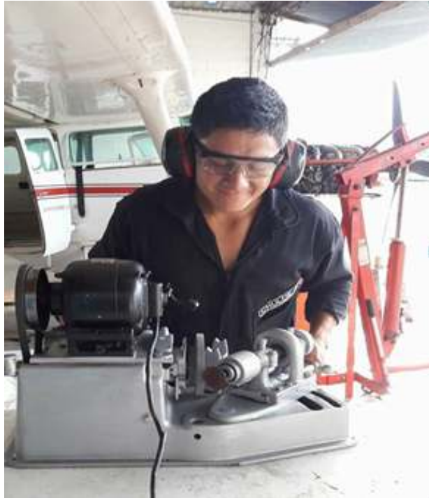
Figura 54 Prueba funcional de la máquina rectificadora de válvulas.
