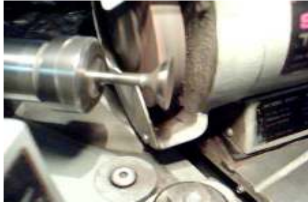
Figura 8 Proceso de rectificado de válvulas.
