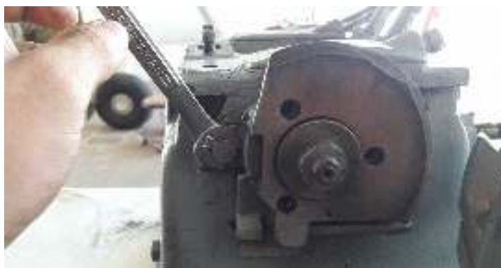
Figura 50 Desmontaje del porta disco de desbaste.
