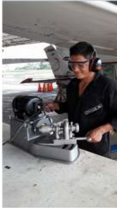
Figura 55 Prueba de funcionamiento de la máquina rectificadora.
