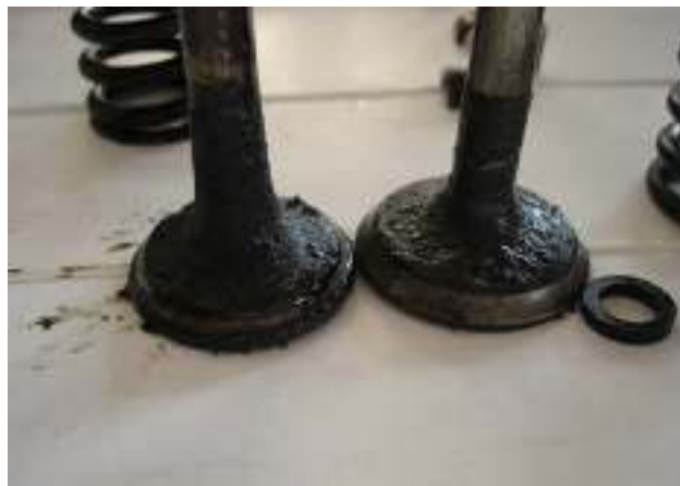
Figura 37 Válvulas con daños por temperatura y presión.
