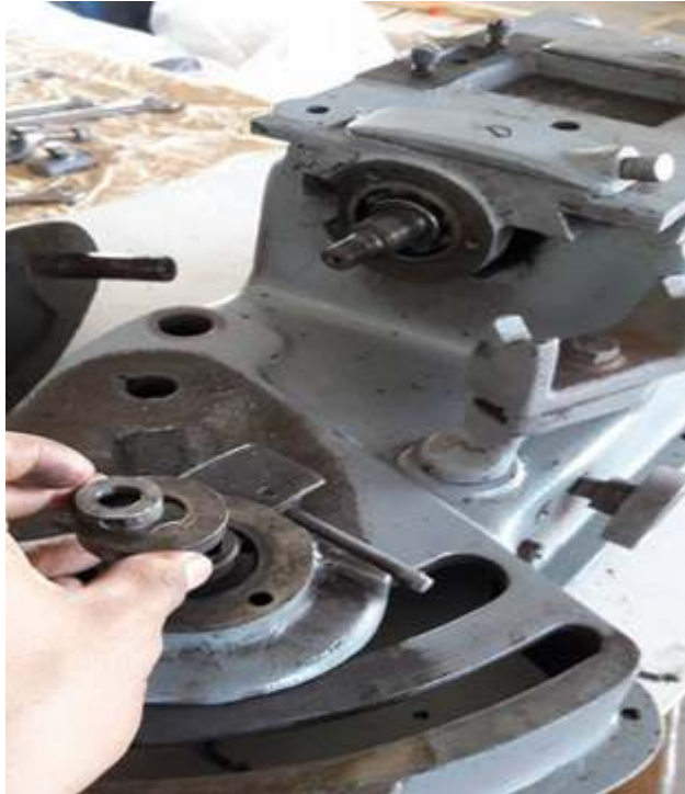
Figura 49 Desmontaje de la máquina rectificadora de válvulas.
