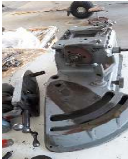
Figura 43 Rectificadora previo mantenimiento.
