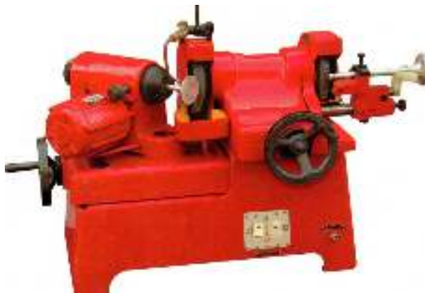
Figura 7 Máquina rectificadora Kwik-Kway modelo N°20002
