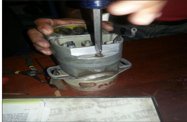
Figura 44 Retiro de tornillos
