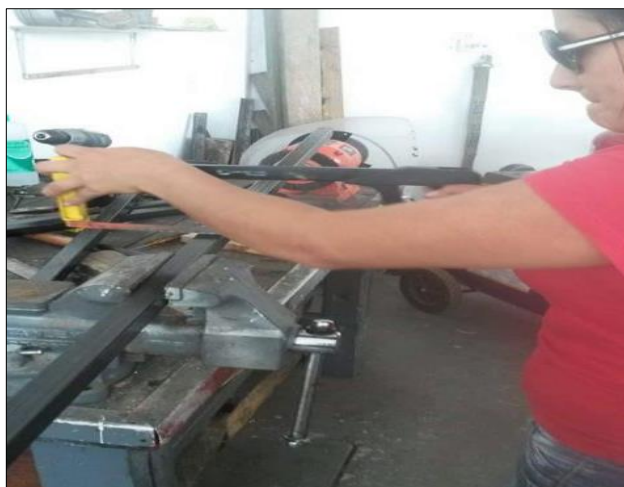
Figura 25 Corte de tubos
