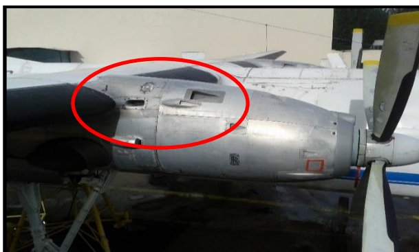
Figura 28 Localización puerta de acceso a la caja de engranajes
