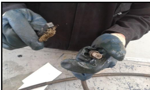
Figura 36 Limpieza de botones de contacto
