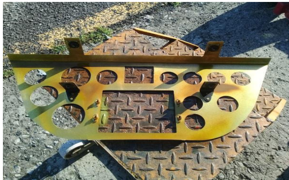
Figura 74 Pintada del panel con primer
