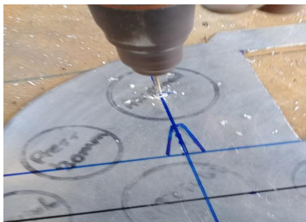
Figura 55 Perforación en la lámina
