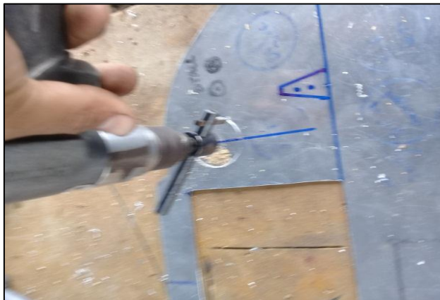
Figura 45 Realizando el corte de la circunferencia
