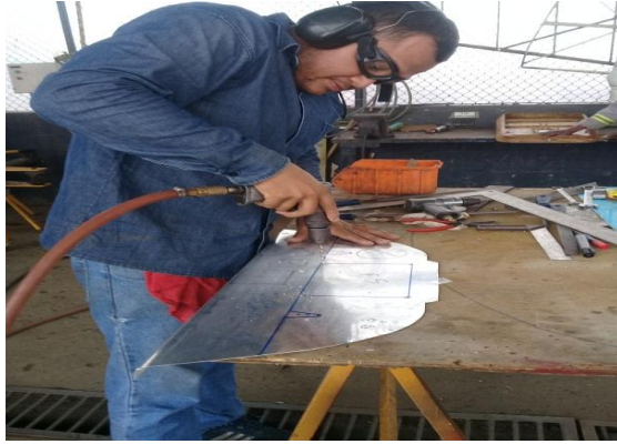
Figura 39 Perforación para la pantalla de GPS
