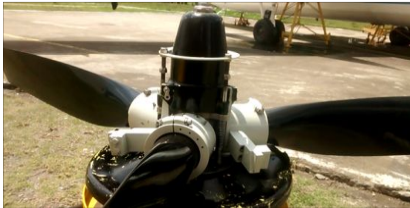
Figura 86 Palas de la hélice en su punto inicial
