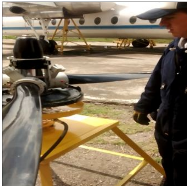
Figura 80 Comprobando fugas de aceite
