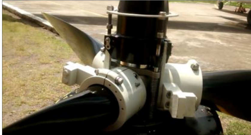
Figura 85 Palas de la hélice retornando al punto inicial
