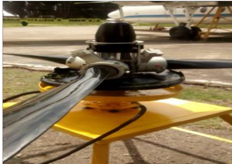
Figura 76 Cambiando el ángulo de las palas
