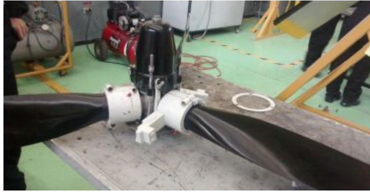
Figura 31 Hélice con embanderamiento y reversa
