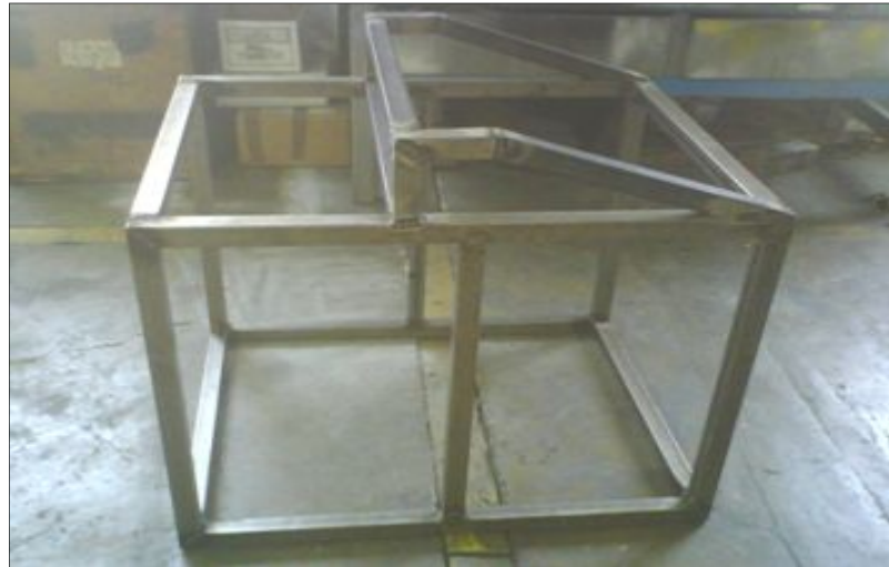
Figura 49 Estructura del banco de prueba hidráulico
