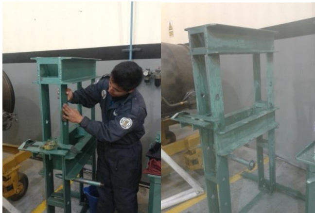
Figura 42 Lijado de la estructura de la prensa hidráulica
