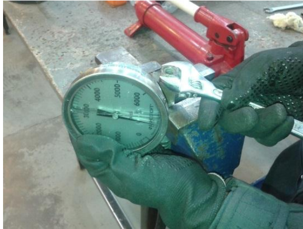
Figura 38 Inspección visual del manómetro de Bourdon
