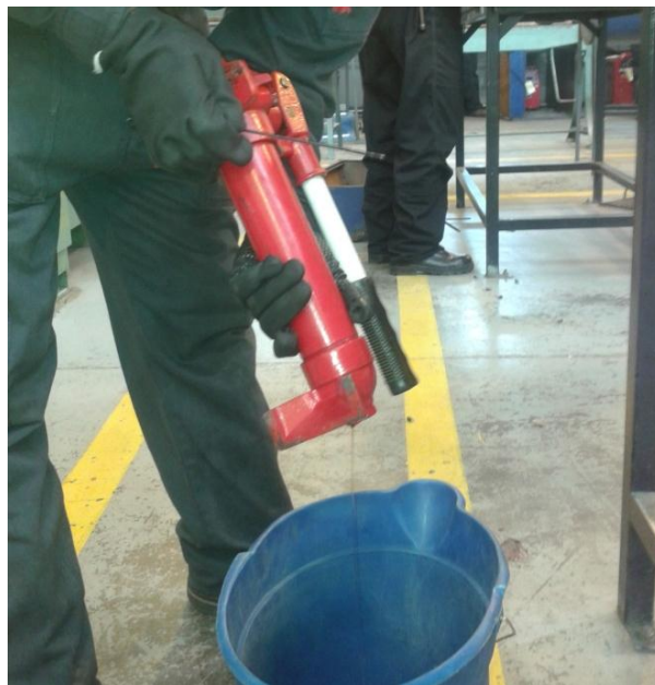
Figura 32 Drenaje del aceite de la bomba hidráulica
