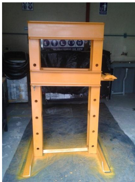
Figura 47 Acabado del pintado de la estructura de la prensa hidráulica
