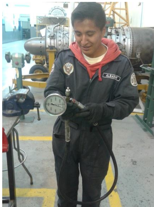
Figura 37 Inspección de la cañería de alta
