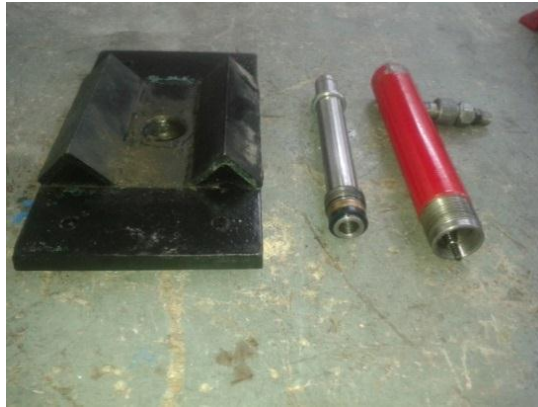
Figura 36 Verificación y limpieza de los componentes del cilindro
