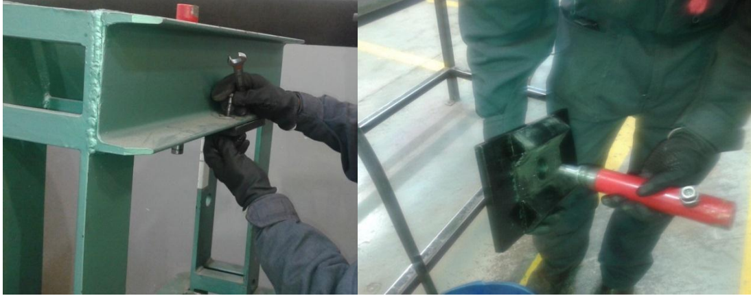
Figura 34 Remoción de la placa de fijación del cilindro hidráulico
