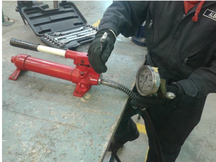
Figura 31 Remoción de la cañería hidráulica
