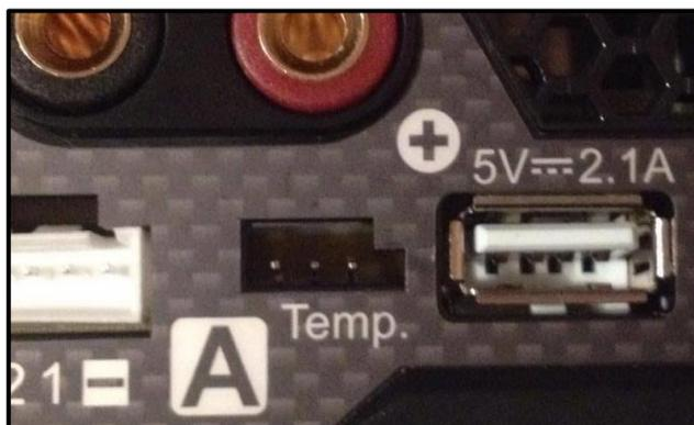
**Figura 28** Puerto del sensor de temperatura y USB
