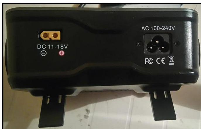
**Figura 29** Soporte de inclinación y entradas A/C y D/C
