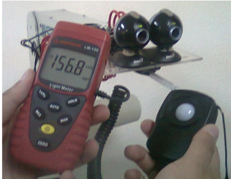
**Figura. 4.20. Medición de la luminosidad**
