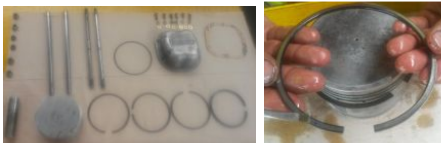
Figura 67 Ubicación de los segmentos en el pistón.
