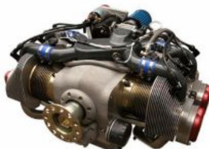
Figura 1 Motor reciproco horizontal opuesto de cuatro cilindros.
