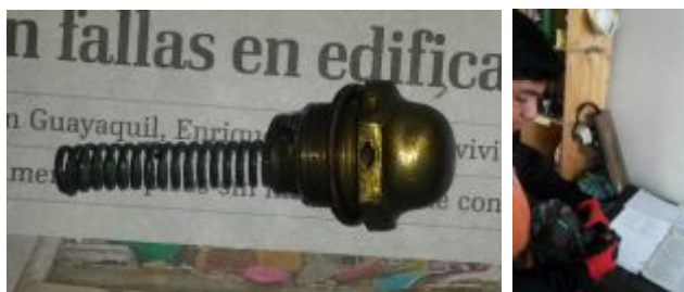
Figura 53 Instalación de la válvula de alivio de presión de aceite
