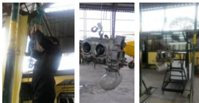
Figura 65 Instalación del motor en la estructura.
