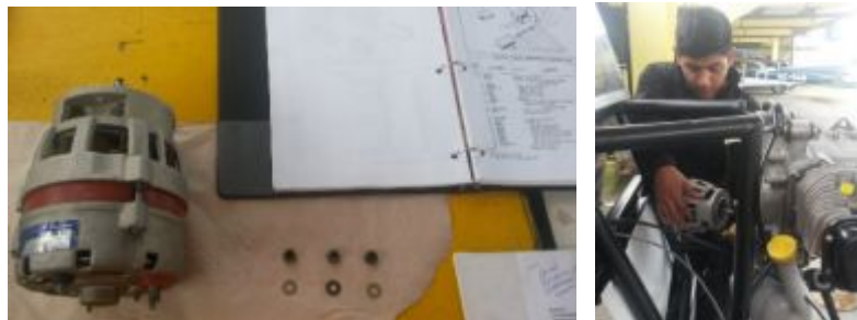
Figura 92 Montaje del alternador.
