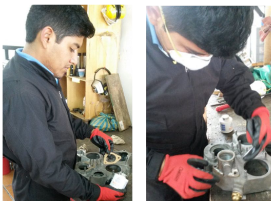
Figura 54 Instalación del filtro de malla y su cubierta.
