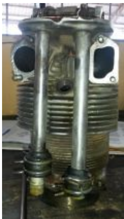
Figura 37 Remoción del Cilindro N° 1
