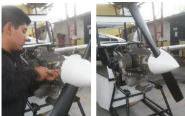
Figura 90 Ubicación del cono de la hélice.
