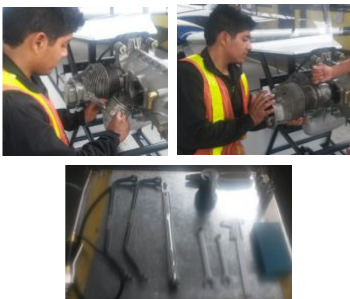
Figura 68 Ubicación de pistón y cilindro.
