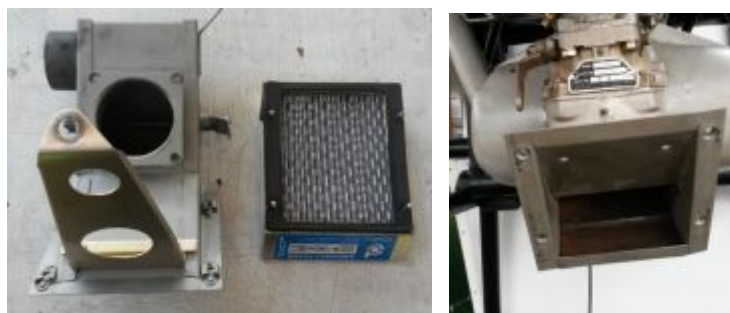
Figura 73 Montaje filtro de aire.
