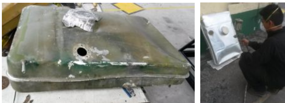
Figura 78 Pintado del tanque de combustible.
