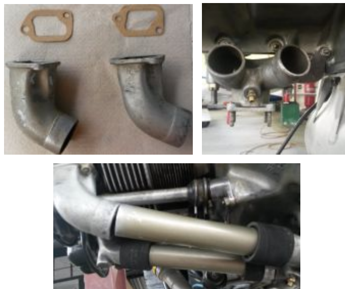
Figura 71 Ensamblaje del sistema de inducción de aire.
