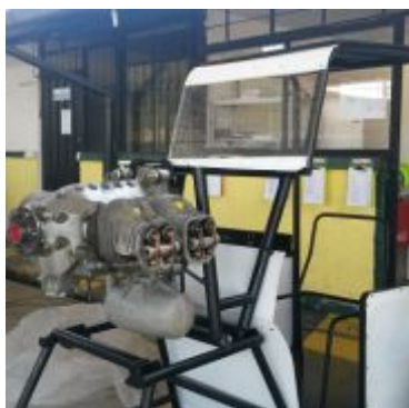
Figura 69 Revisión del libre movimiento de válvulas.
