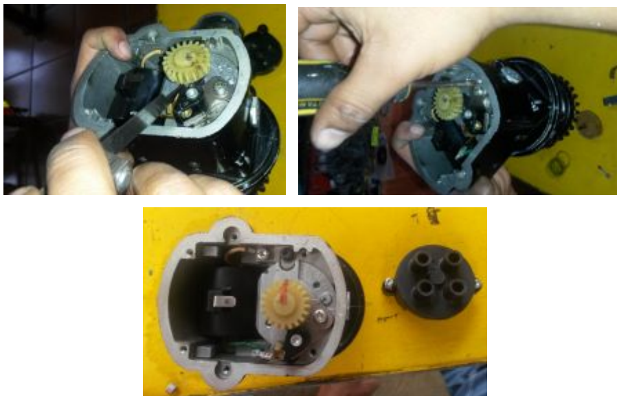
Figura 74 Servicio a las magnetos
