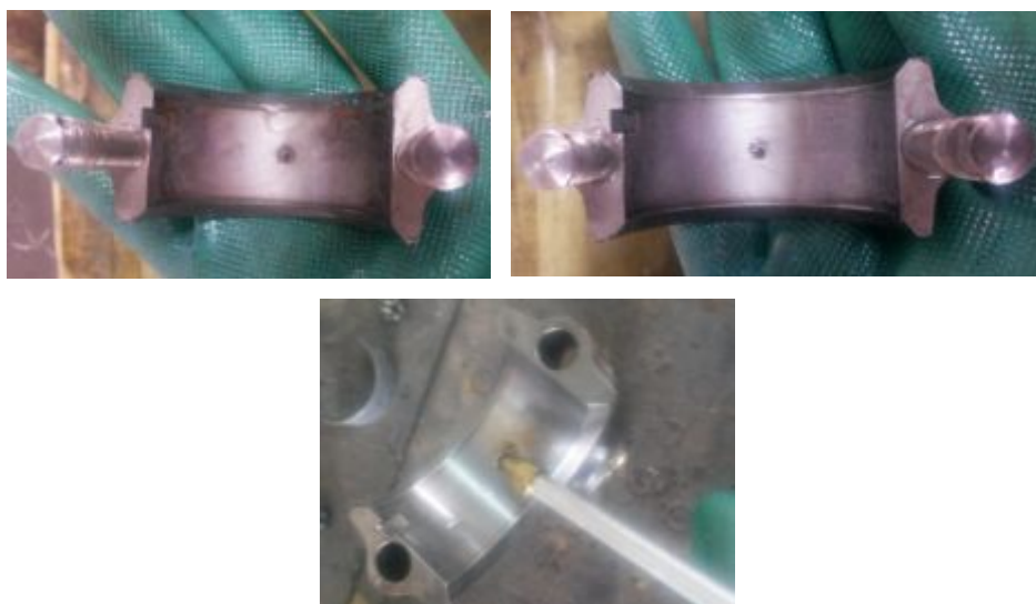
Figura 47 Inspección y limpieza de las bielas
