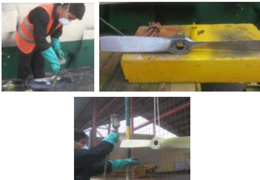
Figura 86 Pintado de la hélice.
