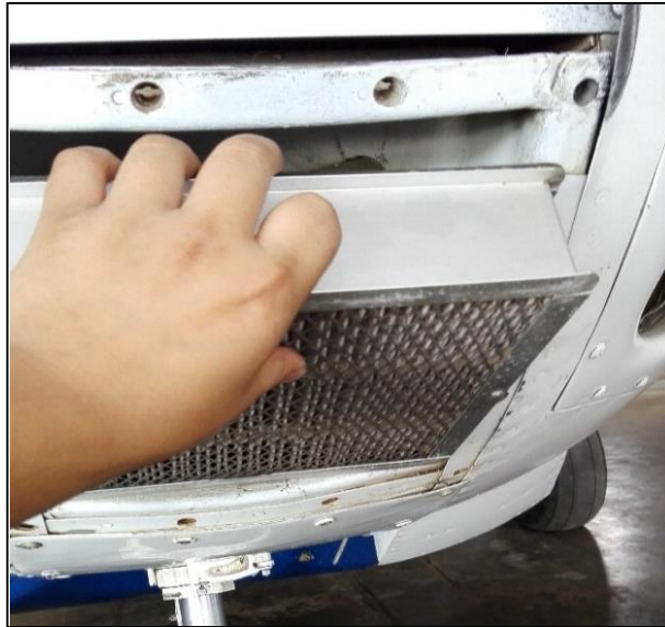
Figura 44 Remoción del filtro de aire.
