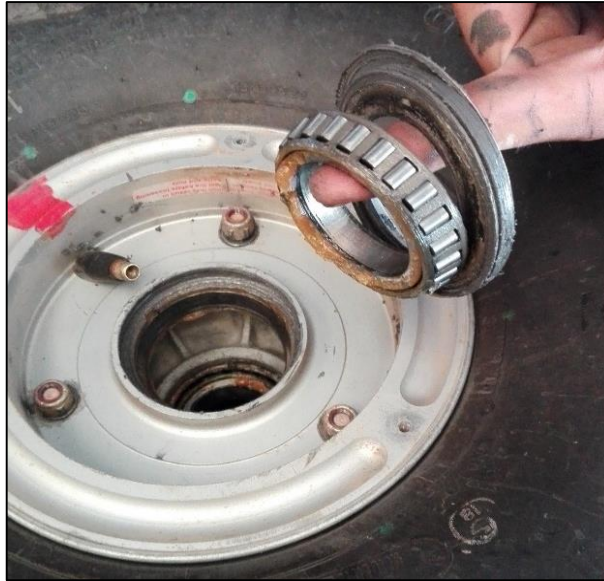
Figura 129 Remoción de Arandelas y Cojinete.
