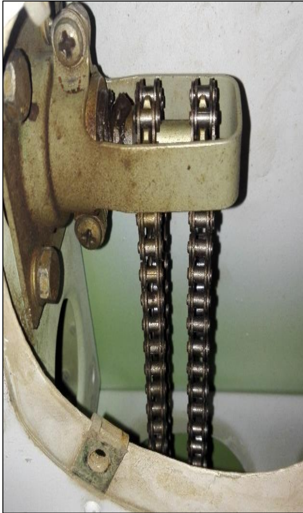
Figura 87 Inspección del Actuador del Trim Tab.
