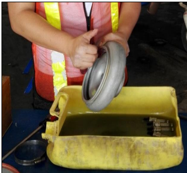
Figura 107 Limpieza del Compresor.
