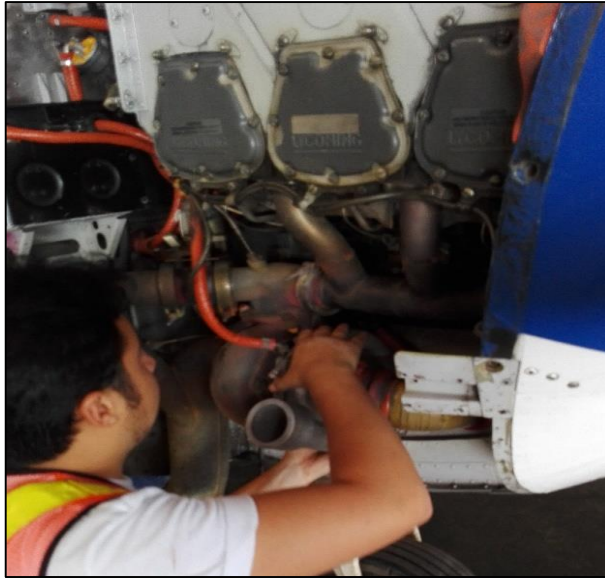
Figura 50 Inspección Del Sistema De Escape.
