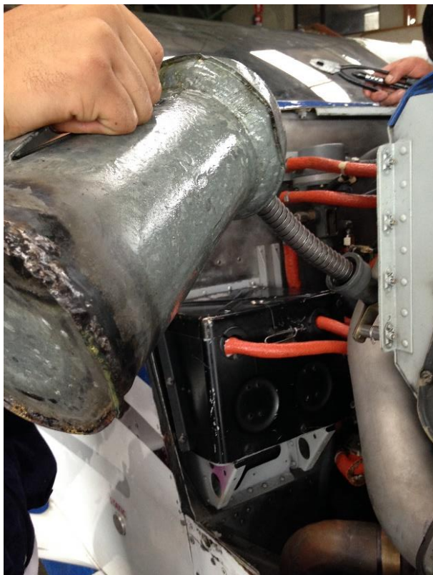
Figura 54 Llenado de Aceite en el Motor.
