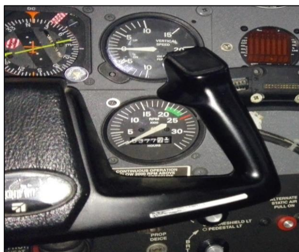
Figura 59 Inspección De Los Controles De Los Alerones.
