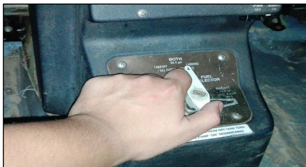
Figura 82 Inspección Funcional de la Válvula Selectora de Combustible.
