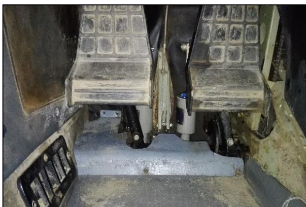
Figura 85 Inspección Visual de los Pedales del Rudder.
