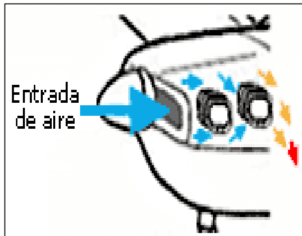
Figura 18 Refrigeración por Aire.
