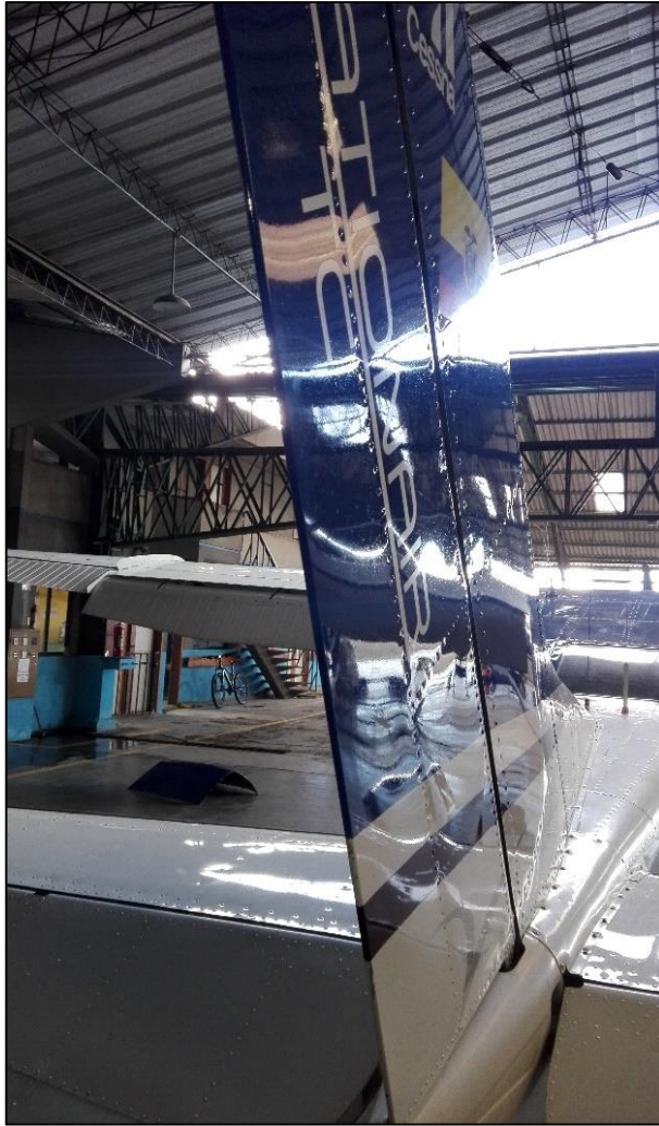
Figura 89 Inspección Visual del Rudder.
