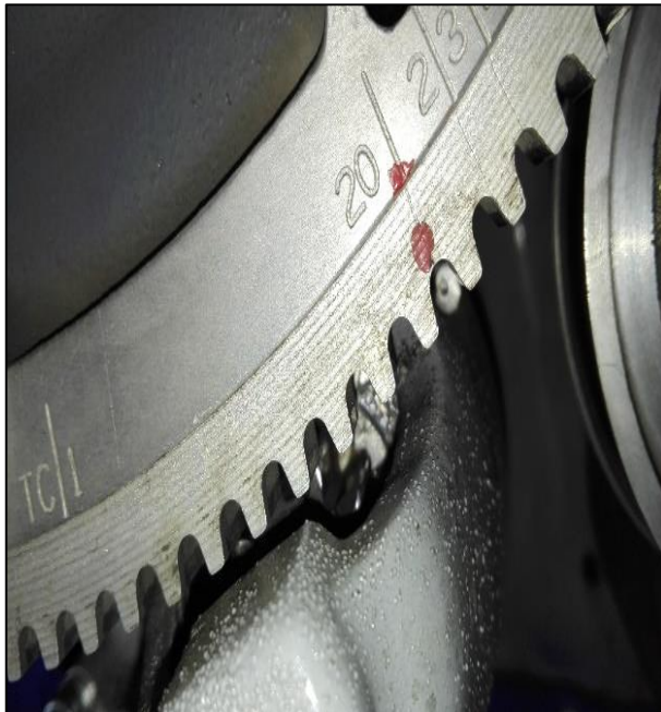
Figura 116 Punto de referencia del motor de arranque con la señal de 20^\circ en el volante de la hélice.
