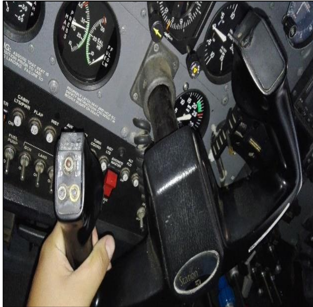
Figura 79 Inspección de Movimiento de Elevadores.
