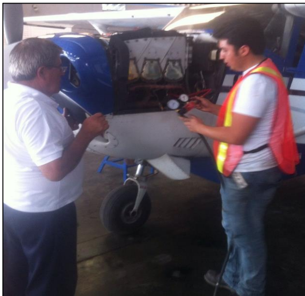
Figura 114 Medición de Compresión en los Cilindros.
