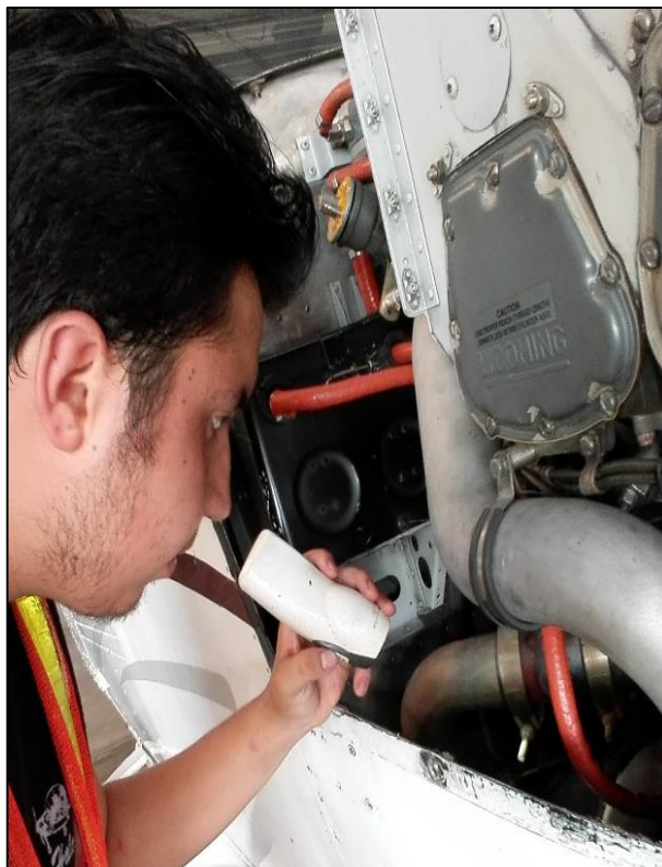
Figura 46 Inspección del Sistema de Inducción.
