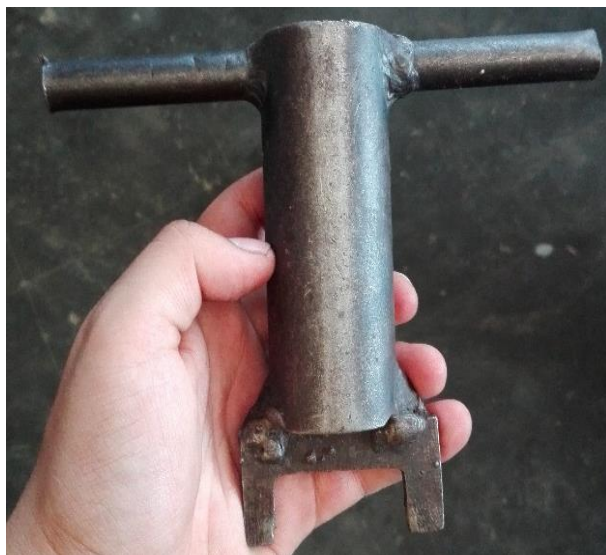
Figura 128 Herramienta Especial para Remoci6n de Tuerca.
