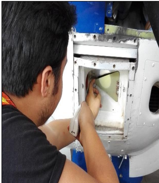
Figura 45 Inspección De La Puerta De Aire Alternativo.
