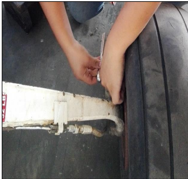
Figura 122 Remoción de las Pastillas de Frenos.
