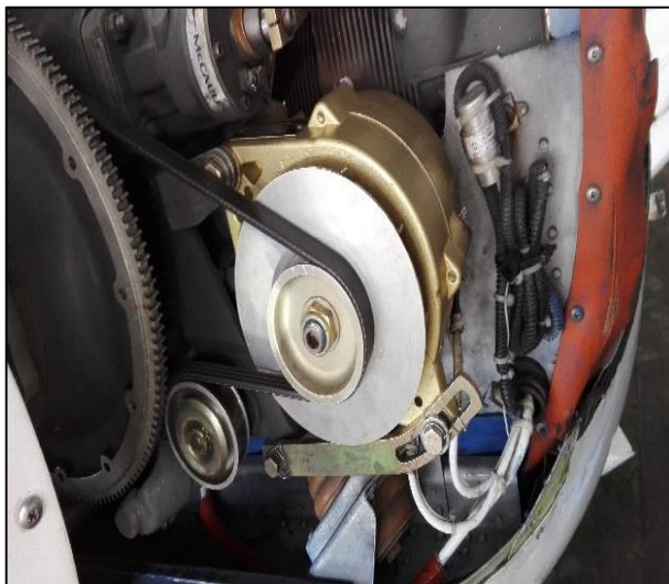
Figura 38 Alternador instalado en la Aeronave
