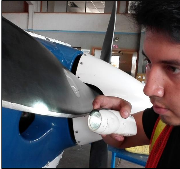
Figura 30 Inspección Visual de pala de Hélice.
