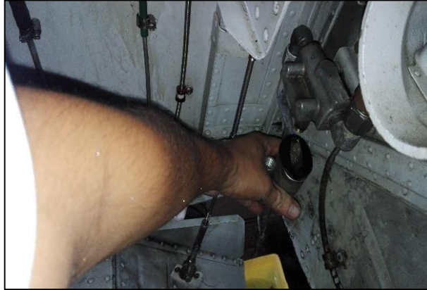
Figura 99 Remoción del Conjunto del Filtro de Combustible.
