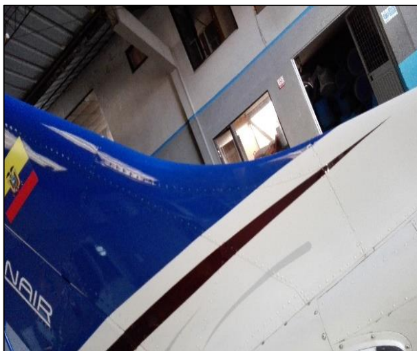
Figura 91 Inspección Visual del Estabilizador Vertical.
