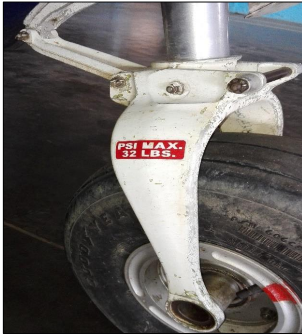
Figura 125 Inspección Tren de Nariz.
