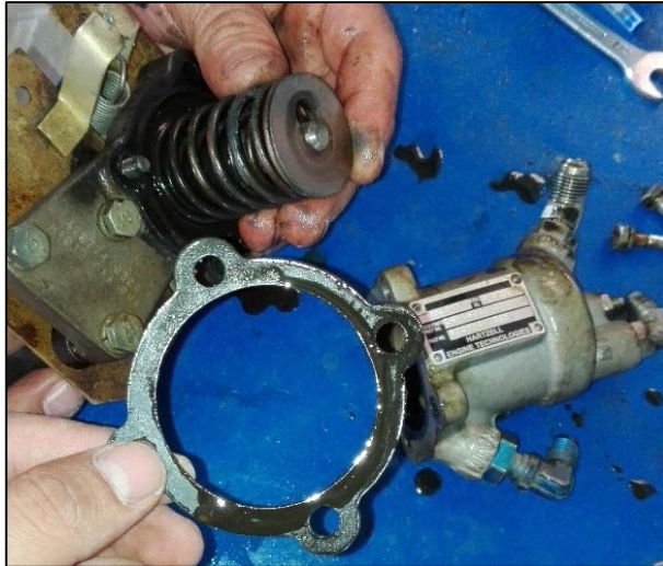
Figura 40 Remoción del empaque desgastado.
