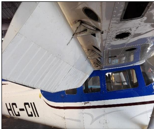
Figura 72 Remoción de Tapas de Inspección de Alas.
