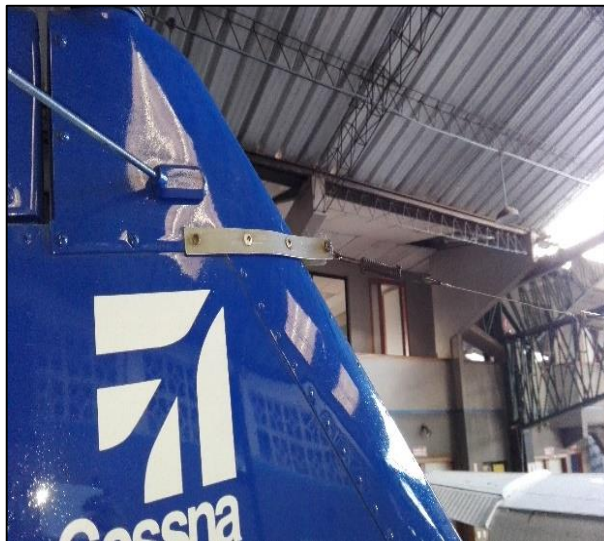
Figura 86 Inspección Visual de Antenas y Cables de Navegación.
