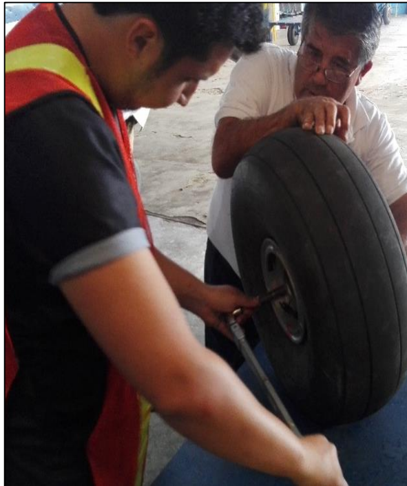
Figura 131 Torque en los Pernos que Sujetan las dos Partes de los Aros.
