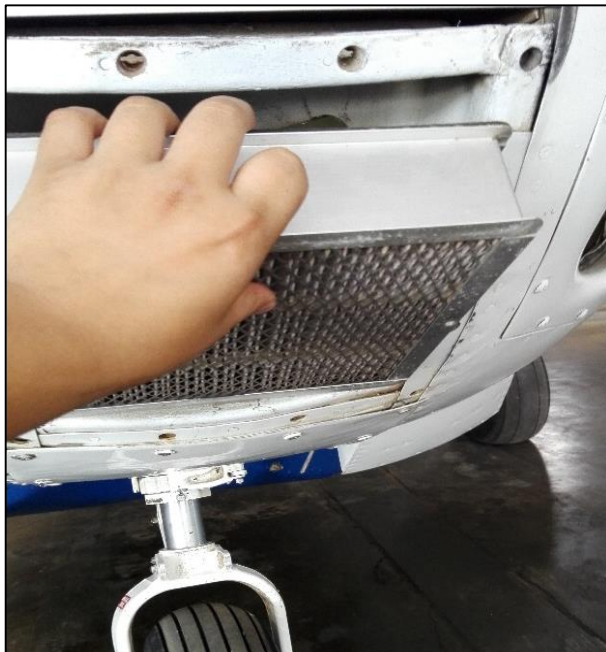
Figura 110 Remoción del Filtro de Aire.
