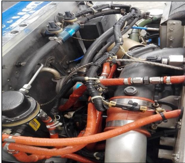
Figura 103 Inspección Visual del sistema de Vacío.
