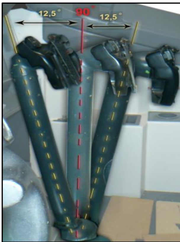
Figura 31 Ángulo de deflexión del Yoke de control
