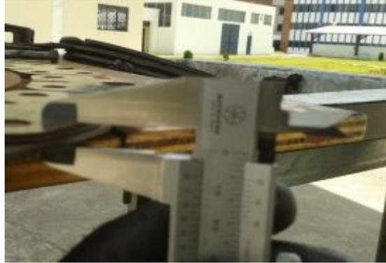
Figura 94 Revisión del espesor de la placa de presión
