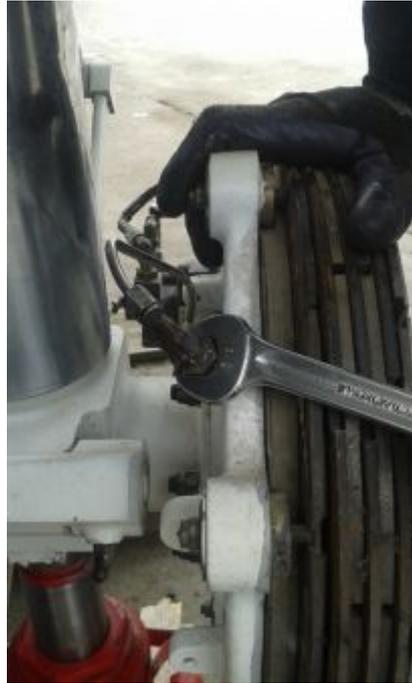
Figura 82 Desacolpe de la tubería de la placa de torsión
