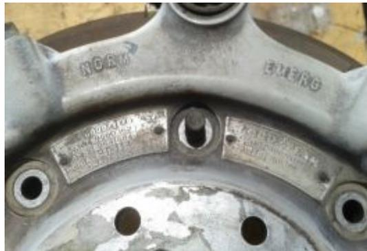
Figura 132 Perno de unión de las placas de empuje y torsión
