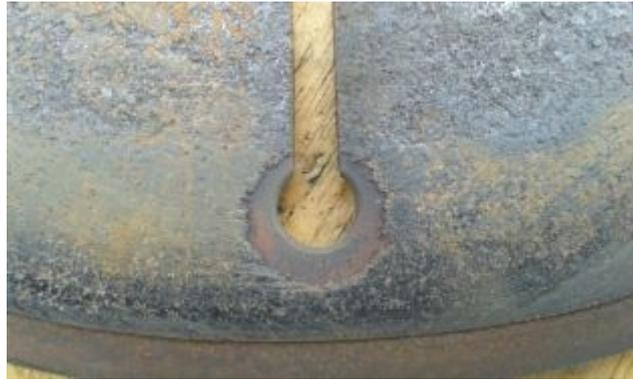
Figura 121 Grietas en el área central de la placa rotativa
