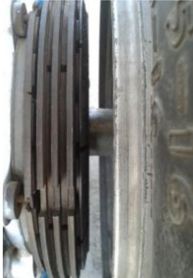
Figura 147 Alineación de las ranuras de los discos rotativos
