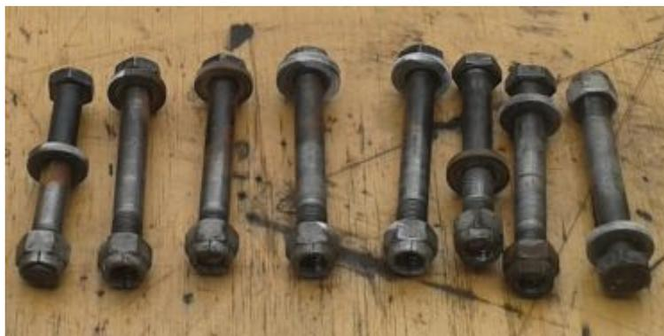
Figura 86 Pernos de sujeción del conjunto de frenos
