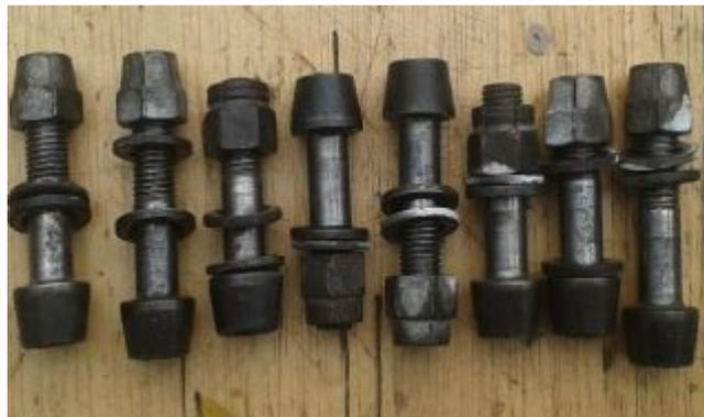
Figura 79 Pernos de la placa de torsión unidos al eje del tren
