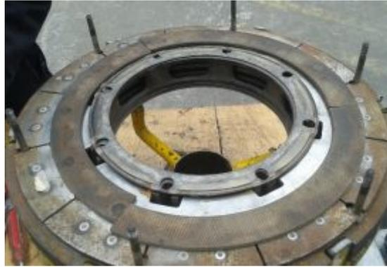
Figura 89 Ubicación de los anillos de seguridad y de apoyo
