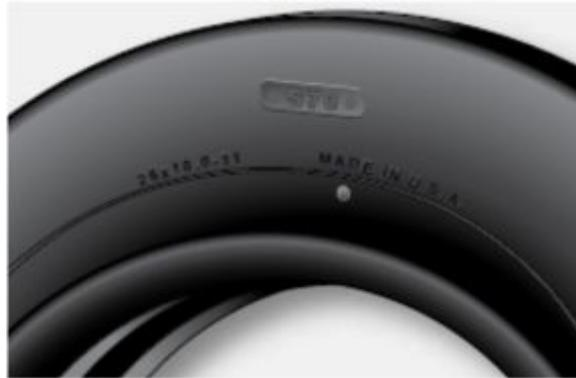
Figura 41 Ubicación para orificios de ventilación en neumáticos
