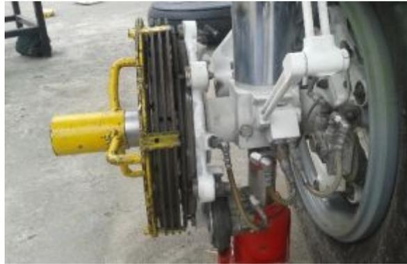
Figura 142 Montaje del conjunto de frenos en el eje
