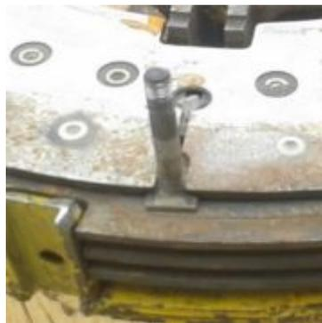
Figura 127 Pasador de retracción en la ranura respectiva
