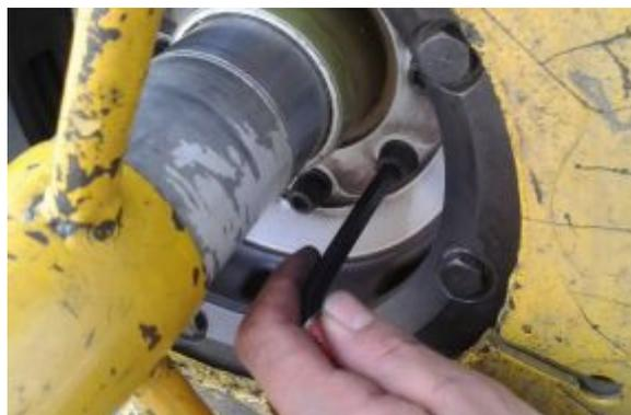
Figura 144 Ajuste de los tornillos con la llave hexagonal
