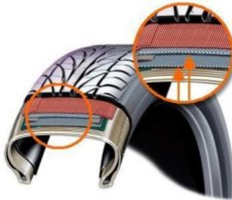
Figura 38 Capas de refuerzo en neumáticos diagonales
