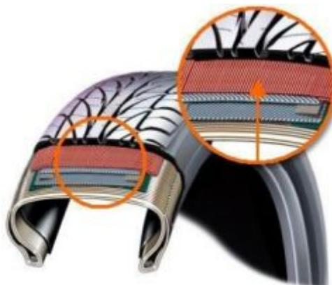
Figura 39 Capas estabilizadoras en neumáticos radiales.
