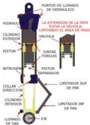
Figura 17 Tren de amortiguador líquido
