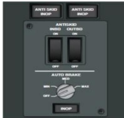
Figura 56 Interruptores del anti-skid en la cabina
