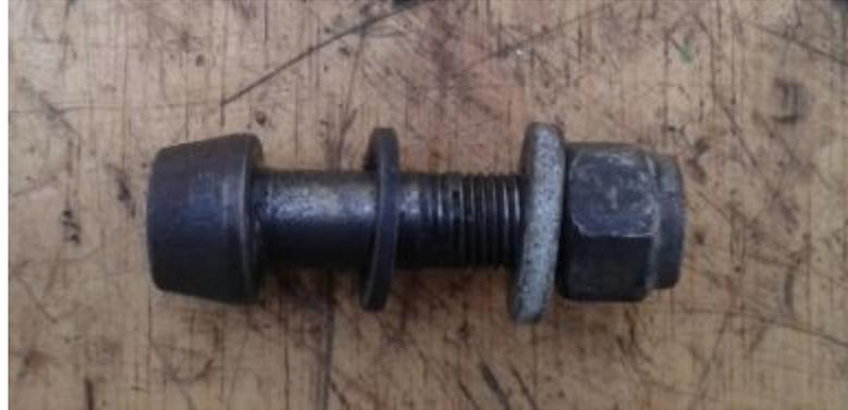
Figura 99 Arandelas de los tornillos
