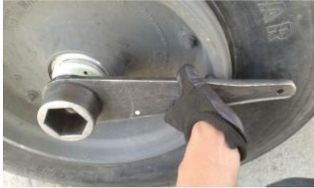
Figura 150 Ajuste de la tuerca de retención con la llave
