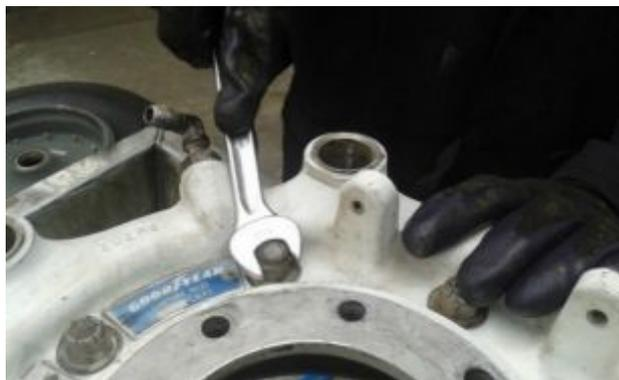
Figura 85 Retirada de las tuercas de sujeción
