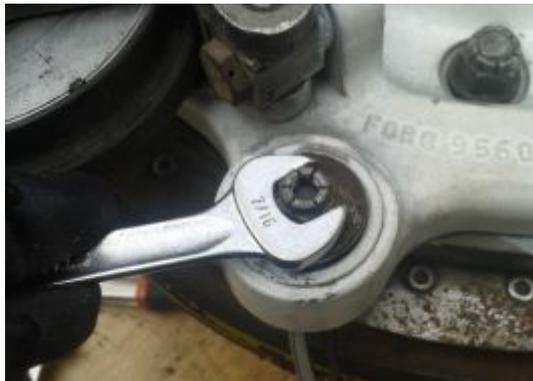
Figura 138 Ajuste del perno de los bujes
