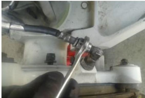
Figura 146 Ajuste de las tuberías a la placa de torsión
