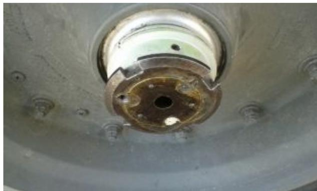
Figura 149 Tornillos de retención
