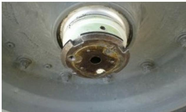
Figura 74 Tornillo de retención de la rueda
