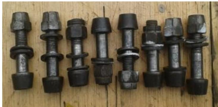
Figura 105 Pernos de la placa de freno
