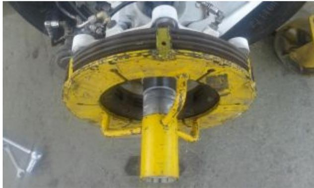
Figura 80 Accesorio de alineamiento del freno en el eje
