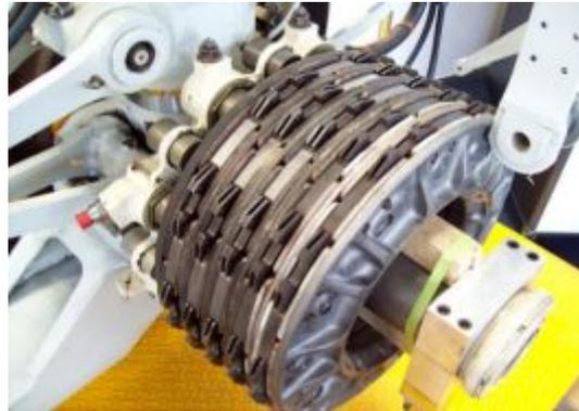
Figura 48 Sistema de frenos múltiples del tren de un avión MD80
