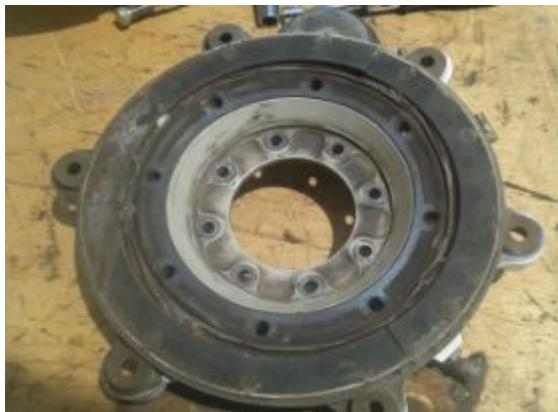
Figura 95 Placa de torsión parte interior
