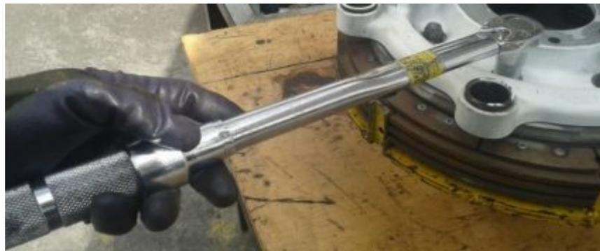
Figura 140 Aplicación de la carga requerida a la tuerca del perno
