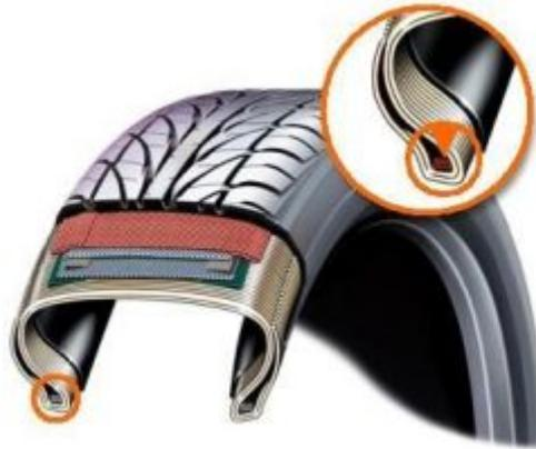
Figura 36 Talón del Neumático
