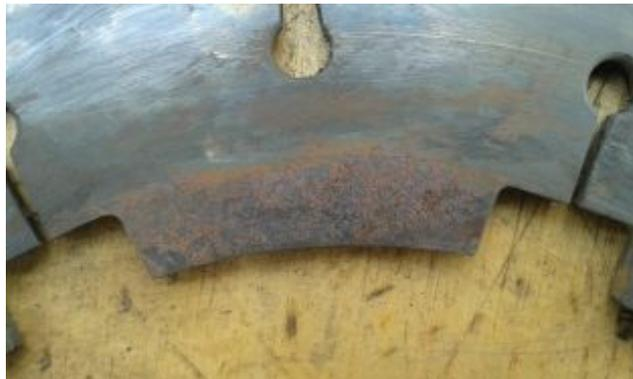
Figura 117 Cara lateral con corrosión en el borde interior
