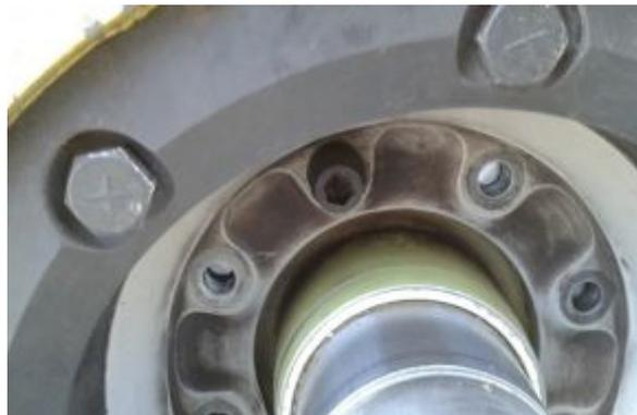
Figura 143 Alineación de los tornillos de sujeción
