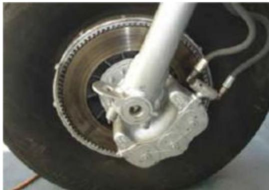
Figura 42 Freno de disco de flotación
