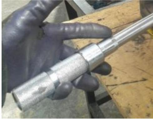
Figura 139 Ajuste de carga en el torquímetro
