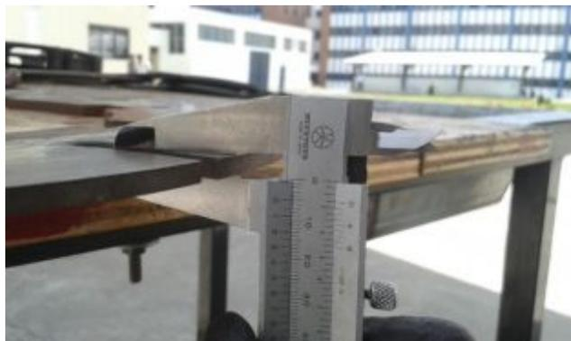
Figura 112 Espesor de la placa estora
