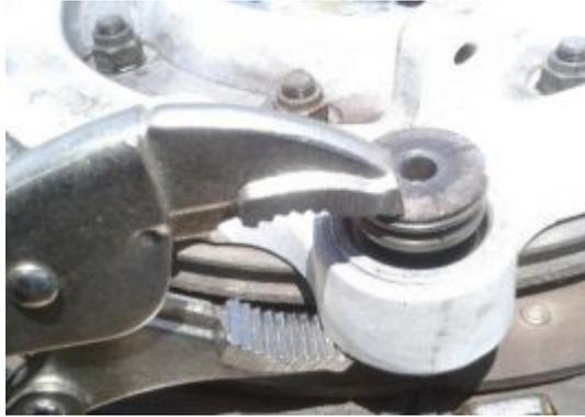
Figura 137 Montaje de la pinza de presión
