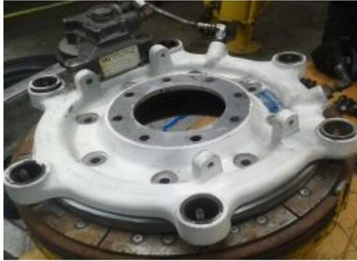
Figura 96 Placa de torsión parte exterior
