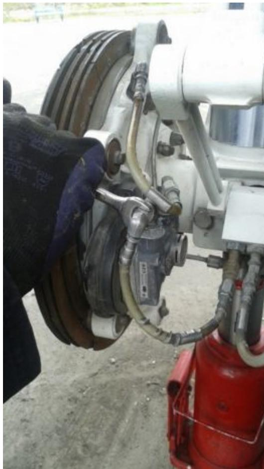
Figura 81 Desacolpe de la tubería del transductor
