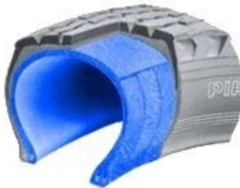
Figura 32 Neumático convencional o tubular
