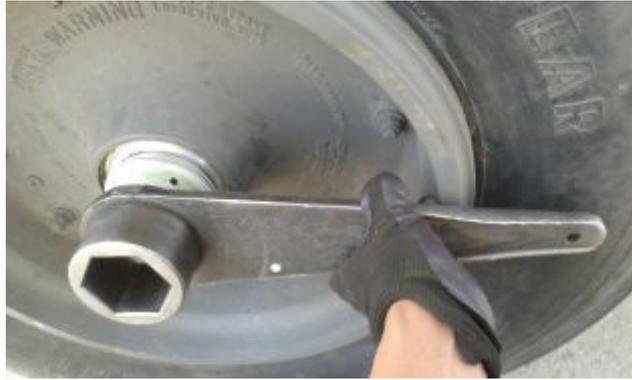
Figura 75 Desacople del tornillo de retención
