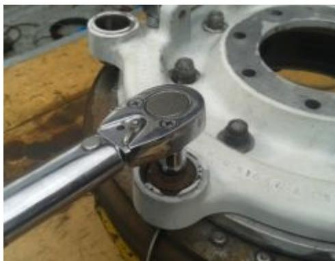
Figura 141 Aplicación de la carga requerida a la tuerca
