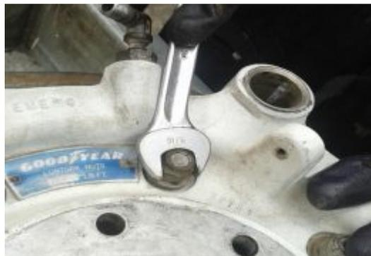
Figura 133 Ajuste de la tuerca y arandela en la placa
