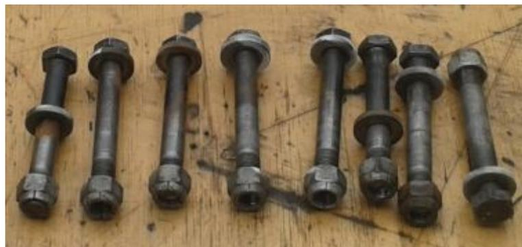
Figura 106 Pernos de sujeción del conjunto de frenos
