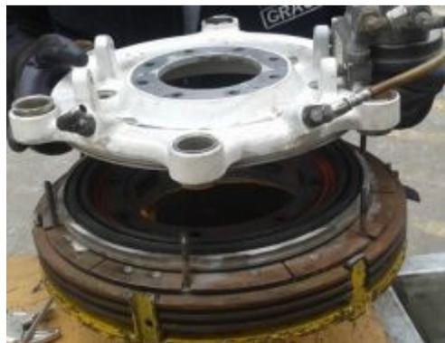
Figura 130 Colocación de la placa de torsión
