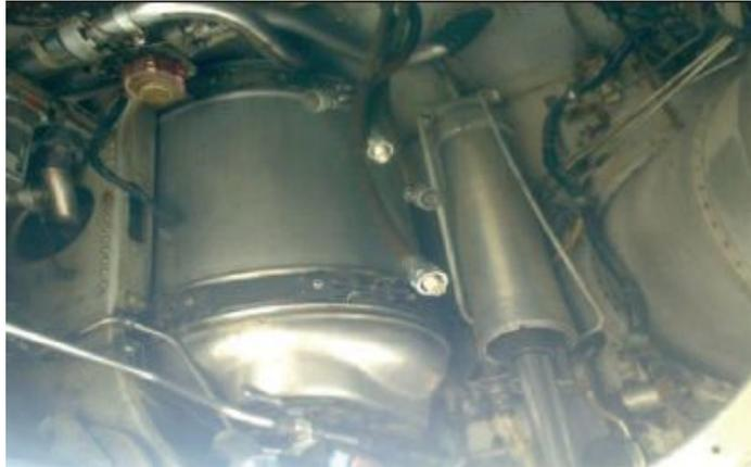
Figura 61 Botella y líneas neumáticas en el compartimiento del tren
