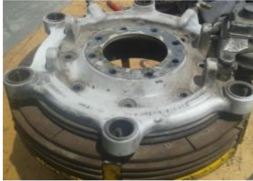
Figura 131 Placas del conjunto de freno alineadas
