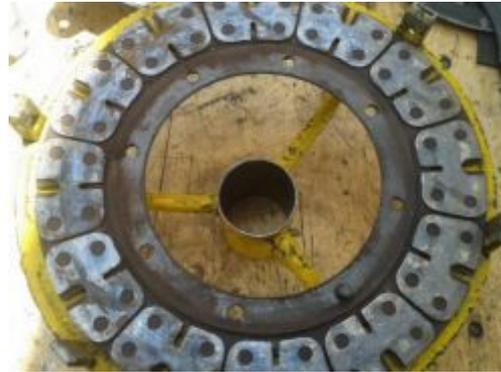
Figura 123 Placa de empuje sobre el accesorio de alineación
