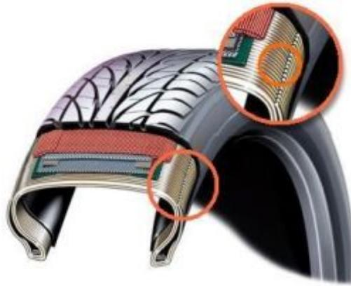
Figura 37 Capas de envoltura
