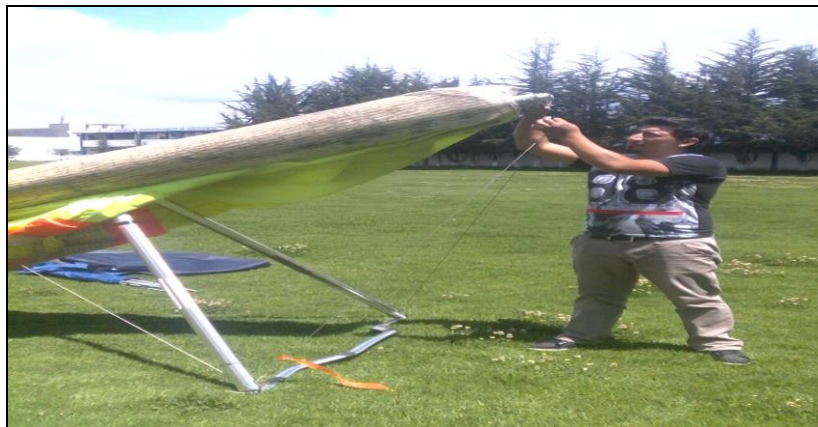
Figura 52 Colocación De Cables Frontales En El Triángulo.
