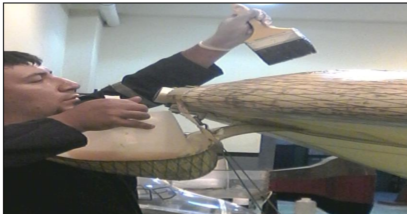
Figura 87 Aplicación De Resina En El Estrados De La Vela.
