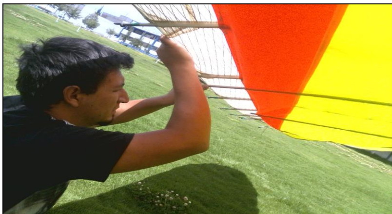
Figura 64 Instalación De Los Sables Del Intradós.
