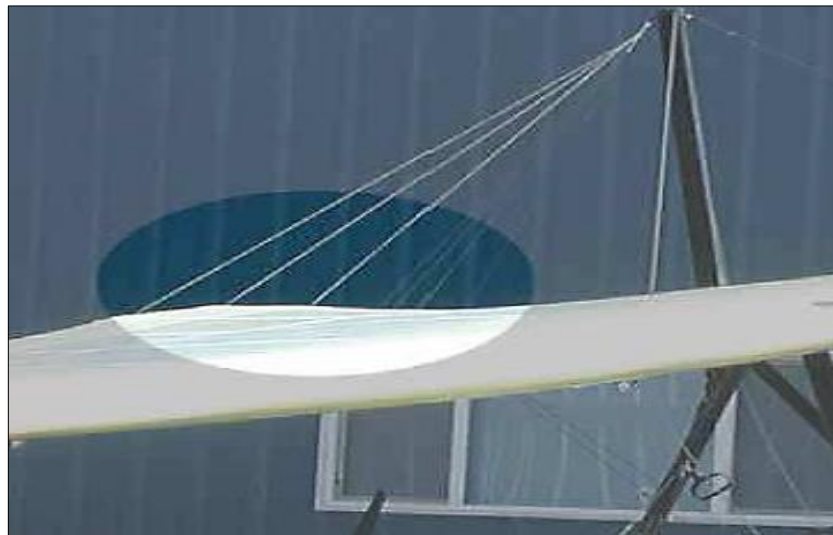
Figura 17 Cables De Reflex.
