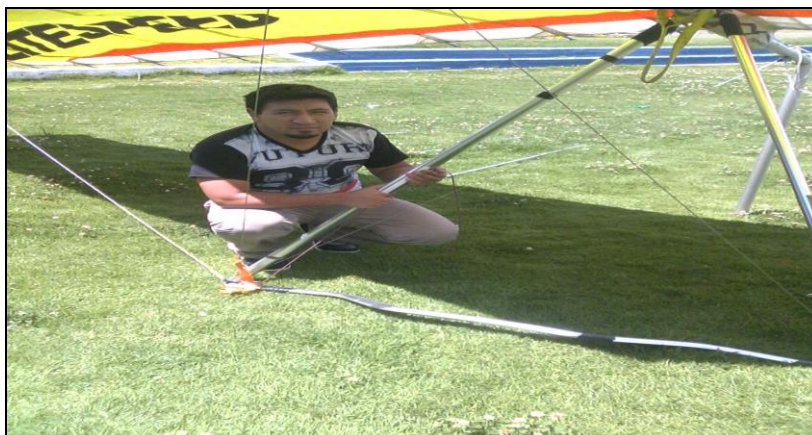
Figura 65 Inspección De Los Soportes Del Triángulo.
