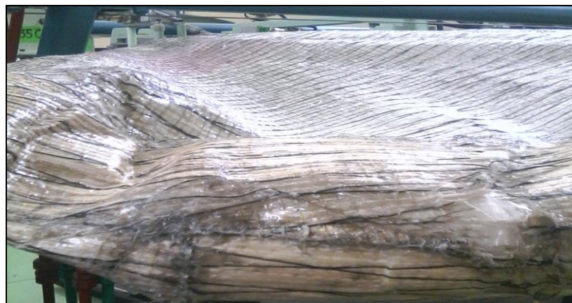
Figura 74 Deformación Del Perfil Alar.
