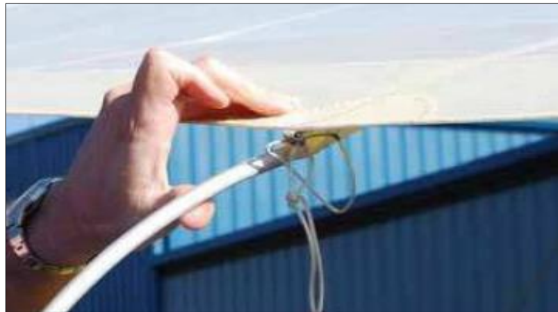
Figura 57 Inserción De Sables En El Hueco.
