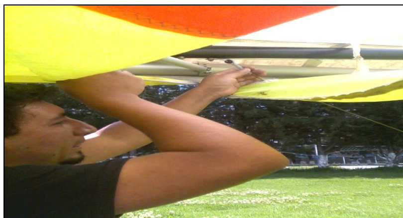
Figura 66 Inspección Del Anclaje Del Cable.
