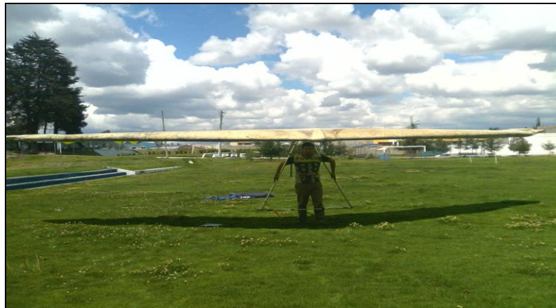
Figura 61 El Ala Una Vez Ajustada La Tensión.
