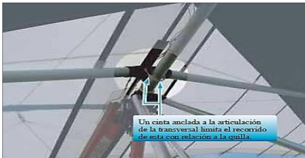
Figura 23 Limitador de recorrido lateral de la transversal.
