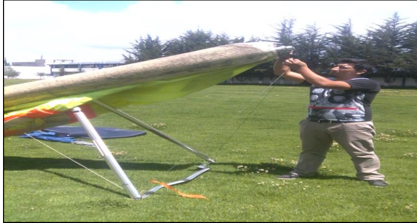
Figura 62 Cables De Vuelo Frontales Fijados Al Morro.
