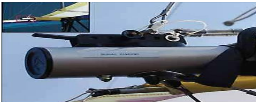
Figura 14 Herraje Del Tensor De Transversal.
