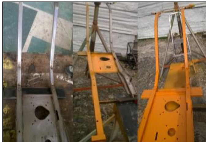
Figura 43 Pintado de la estructura.
