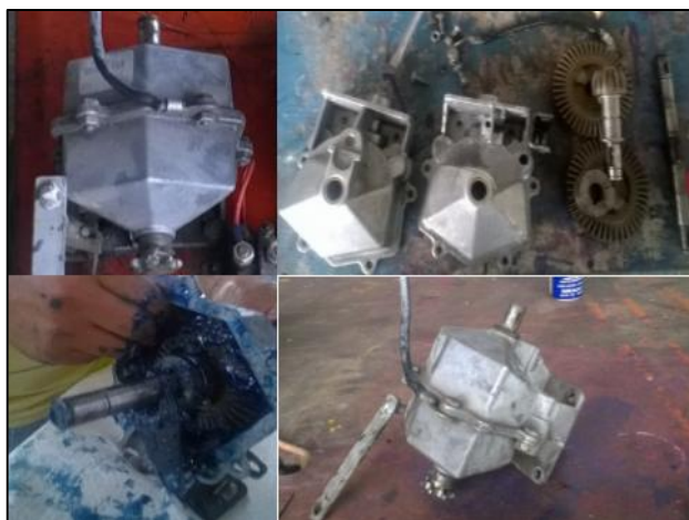
Figura 51 Cambio de grasa de la transmisión.
