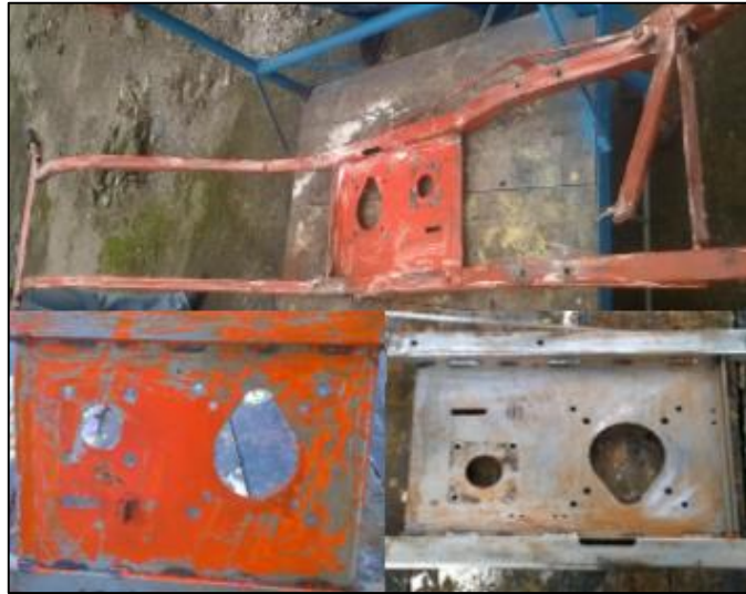
Figura 42 Despintado de la estructura.
