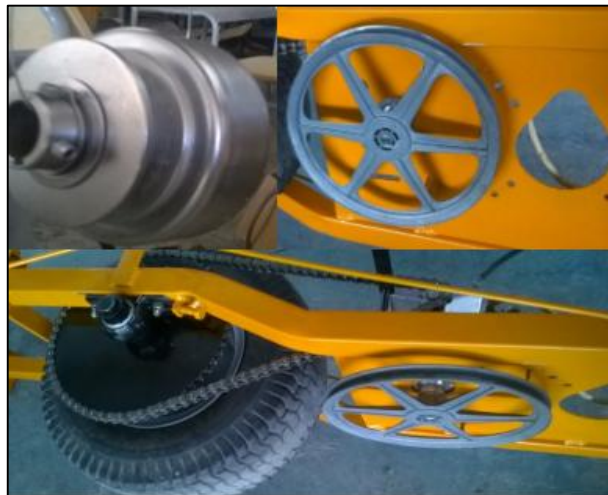
Figura 56 Montaje de las poleas.
