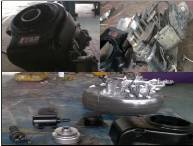
Figura 44 Desmontaje de los componentes del motor.
