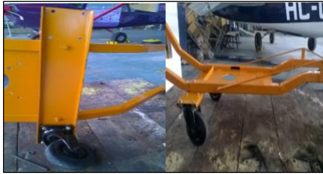
Figura 60 Instalación del soporte y ruedas giratorias.
