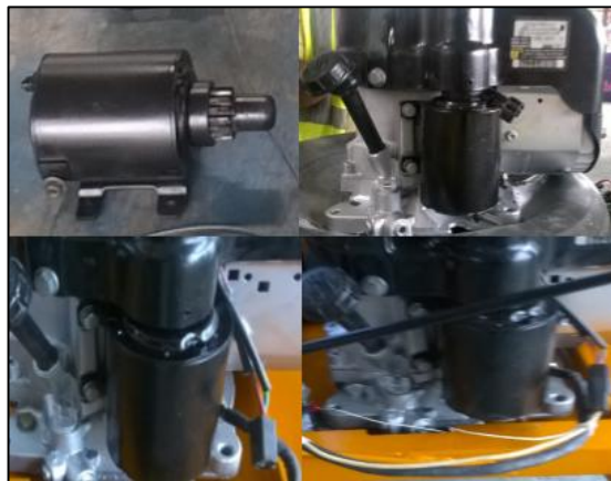
Figura 46 Instalación del motor de arranque.
