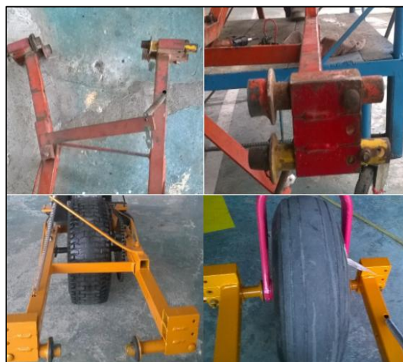
Figura 58 Limpieza de los adaptadores que unen al avión.
