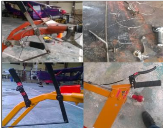
Figura 57 Limpieza de los mandos de control.
