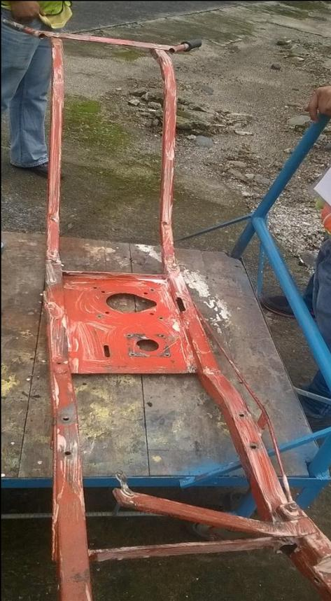
Despintado y lijado de la estructura
