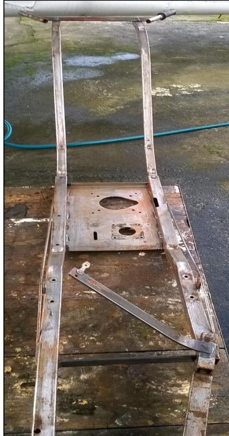
Construcción de un soporte de ruedas auxiliares
