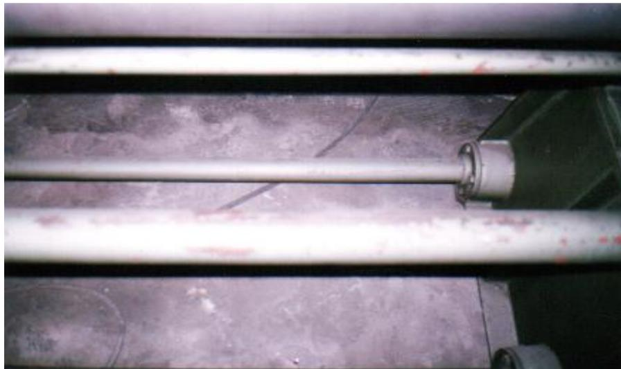
**Figura 2.2. Presencia de corrosión en la estructura de la máquina**
