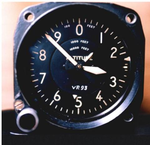
Figura 1.14 (Altímetro)
