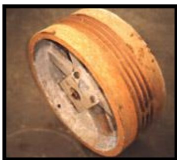
Figura 1.19 Oxidación de un aro
