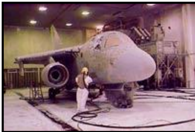
Figura 1.2 Limpieza por Sandblasting en el fuselaje de un avión
