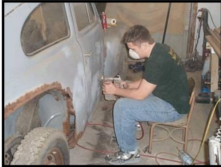
Figura 1.17 Uso de Sandblasting en la industria Automotriz
