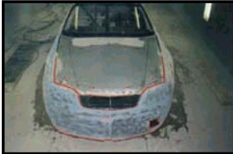
Figura 1.1 Limpieza por Sandblasting en la carrocería de un auto
