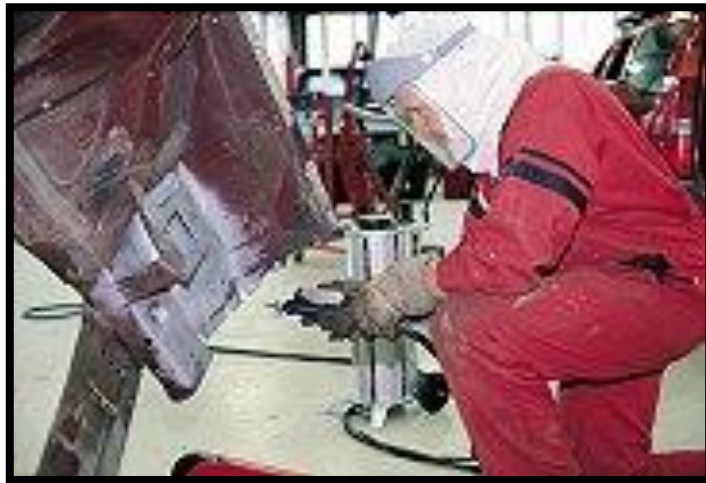
Figura 1.16 Uso de Sandblasting en la industria mecánica
