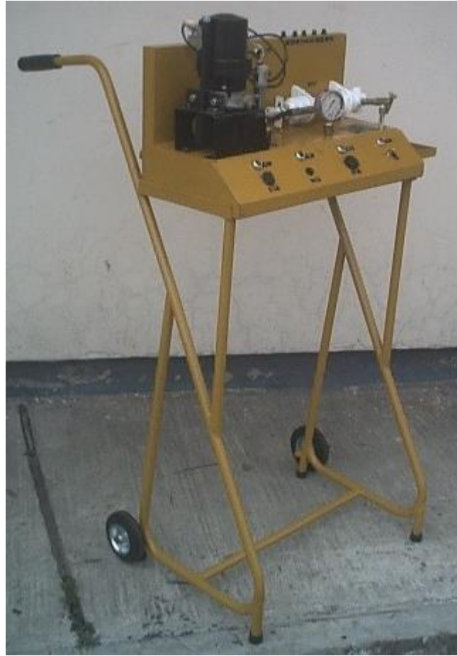
Figura 3.3 Banco de prueba hidráulico para aviones T-35 Pillán
