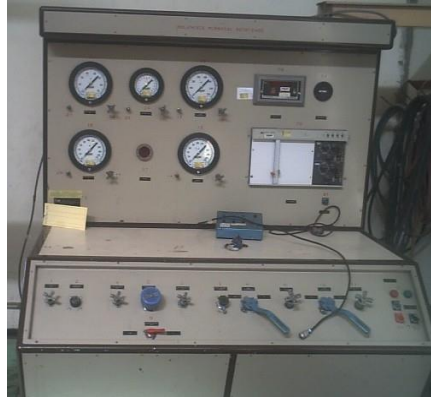
Figura 1.16 Banco hidráulico para trenes de aterrizaje
