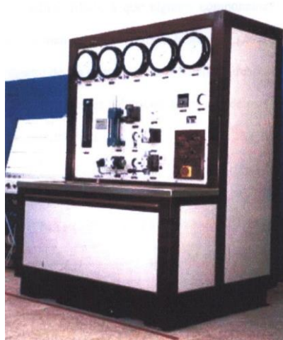
Figura 1.15 Banco de prueba de accesorios hidráulicos
