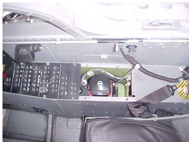
Figura 1.9 Ubicación de la bomba hidráulica
